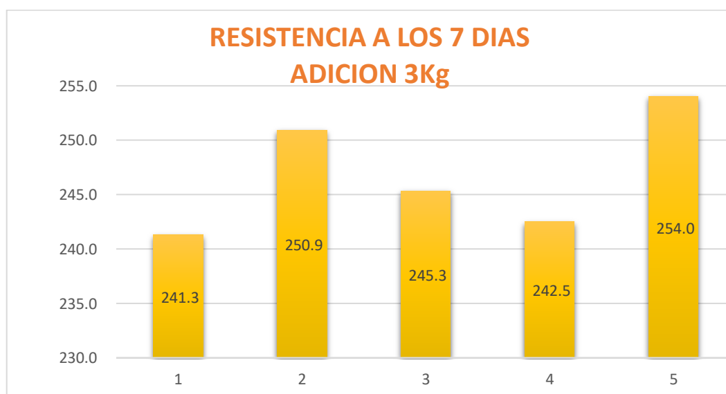
Figura N° 05: Resistencia obtenida a los 07 días del Concreto con Adición de Fibras en 3kg/m3.
