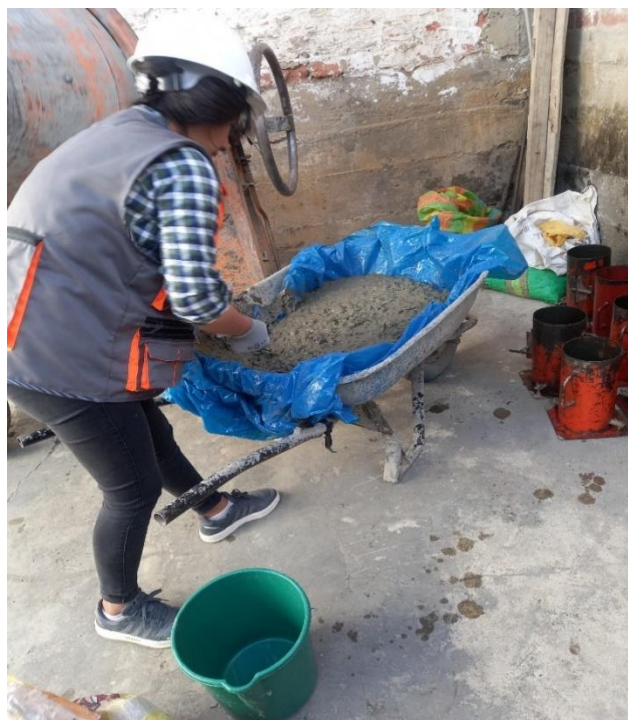
Figuras. N° 26: Mezcla de concreto con adición de fibra de acero con 6kg
