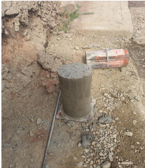
Figuras. N° 28: Desencofrado de las probetas
