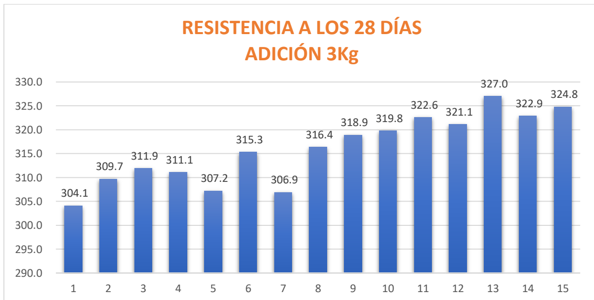
Figura N° 10: Resistencia obtenida a los 28 días del Concreto con Adición de Fibras en 3k/m3.
