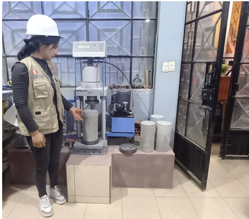
Figuras. N° 30: Ruptura del Concreto Patrón en el ensayo a Compresión
