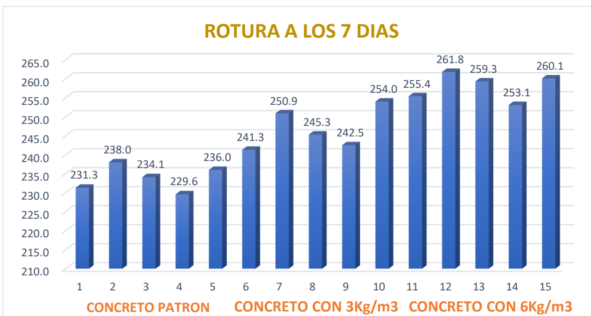
Figura N° 08: Ruptura de probetas de concreto a los 07 días
