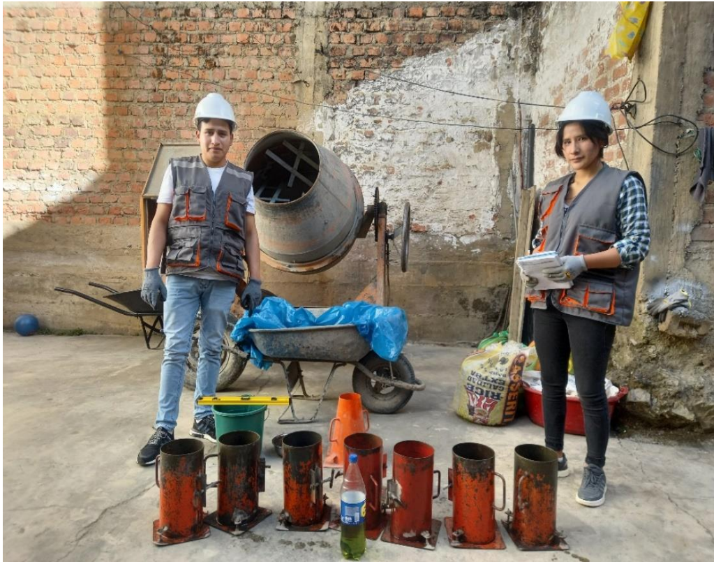
Figuras. N° 21: Mezcla para los testigos del Concreto Patrón
