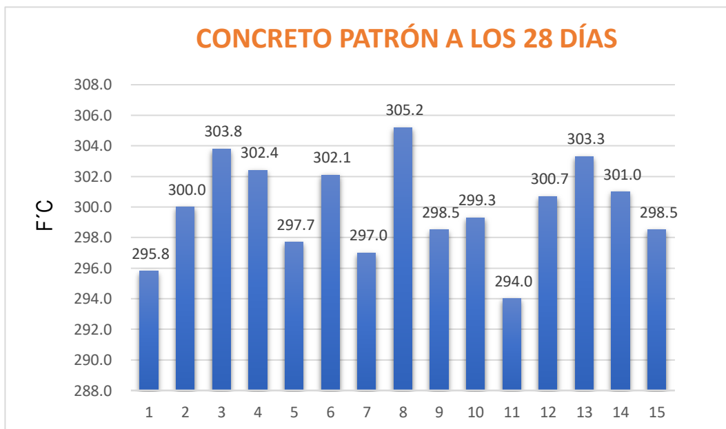
Figura No 09: Concreto Patrón a los 28 días.
