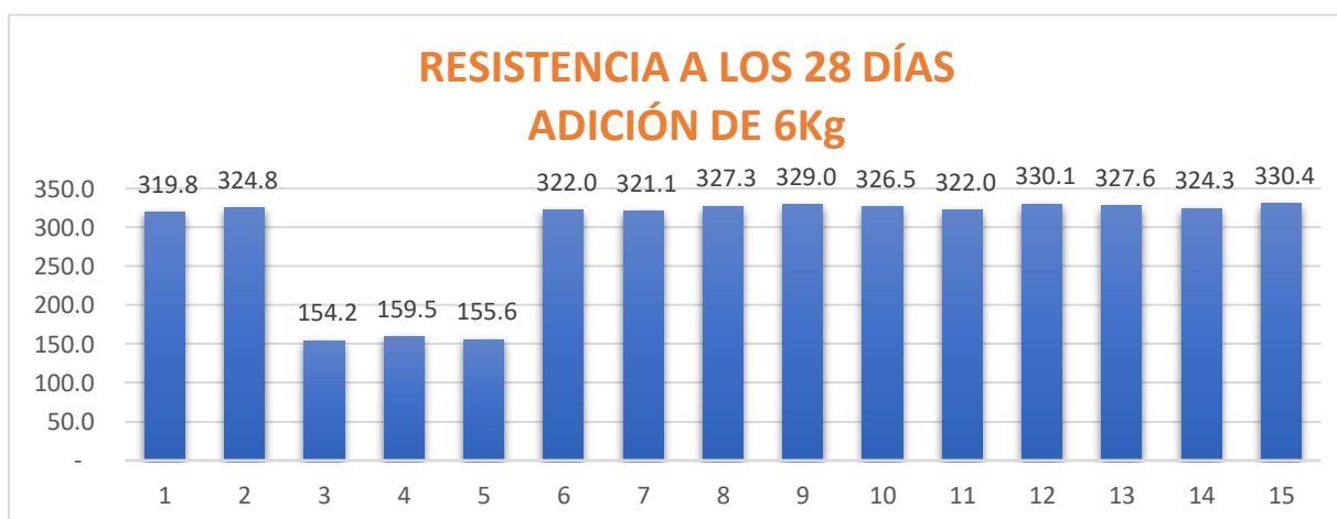
Figura N° 11: Resistencia obtenida a los 28 días del Concreto con Adición de Fibras en 6k/m3.
