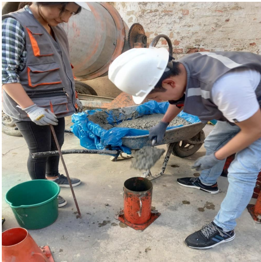
Figuras. N° 24: Llenado de la mezcla de concreto con adición de 3kg de fibra de acero a las briquetas
