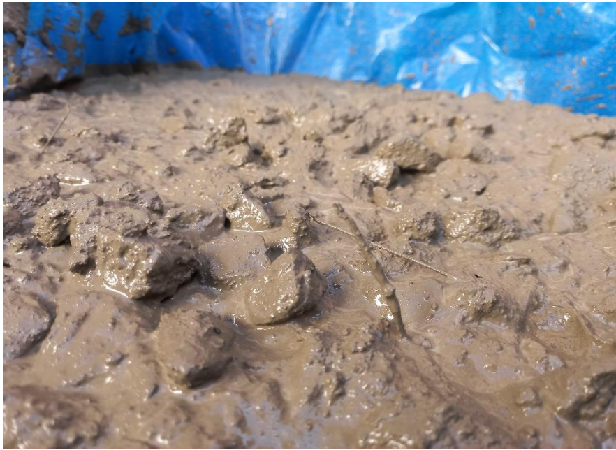
Figuras. N° 23: Muestra del concreto con adición de fibra de 3kg
