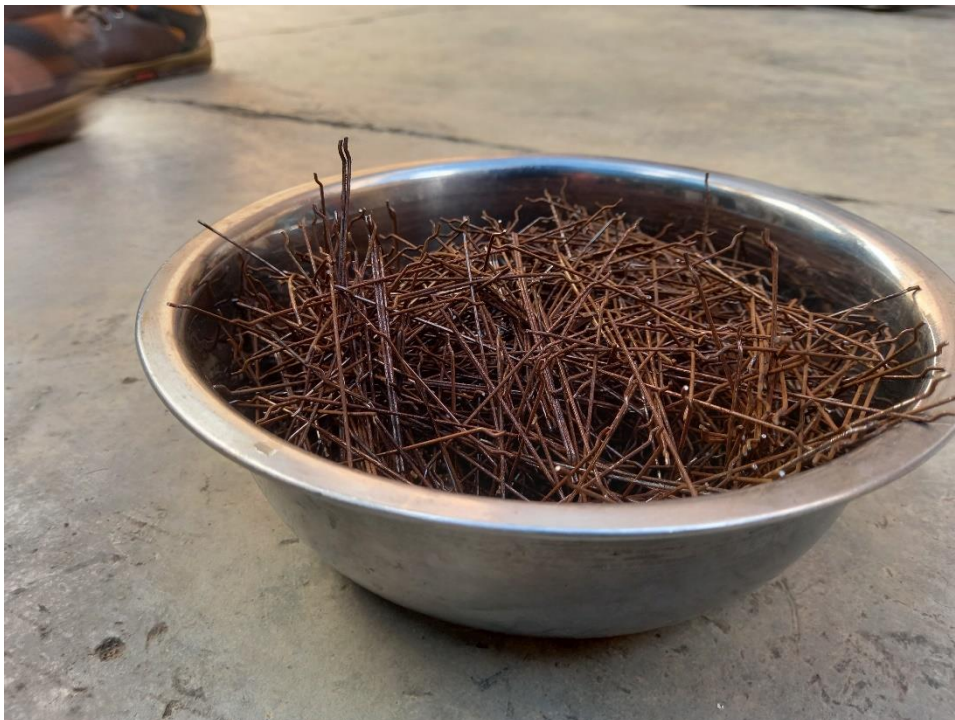
Figuras. N° 22: Fibra de acero: 3kg para la adición a la mezcla
