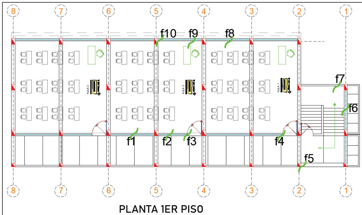
Figuras 7: Ubicación de la fisuras y grietas (1er piso)
