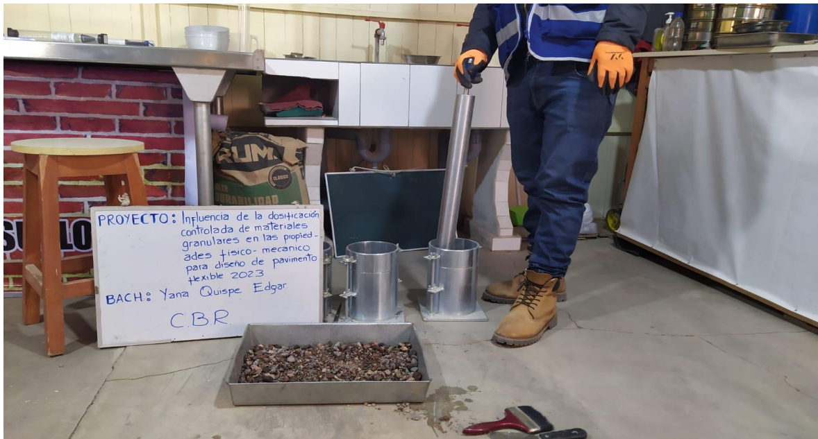
Figura 11. Trabajos en laboratorio ensayo C.B.R (Fuente propia)
