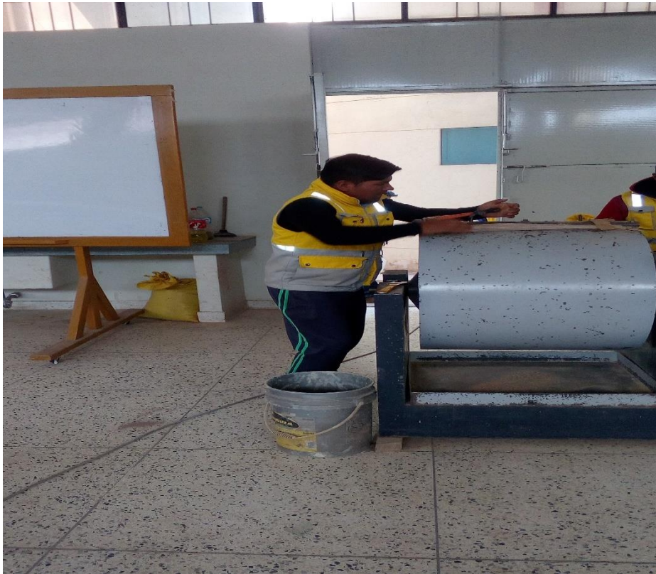
Figura 9. Trabajos en laboratorio ensayo Maquina los Angeles (Fuente propia)
