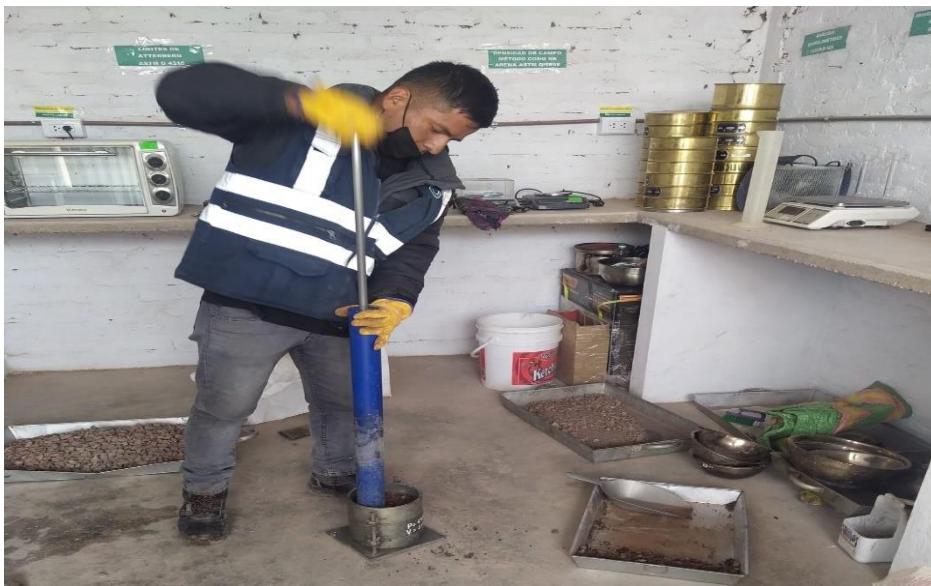
Figura 10. Trabajos en laboratorio ensayo Proctor Modificado (Fuente propia)
