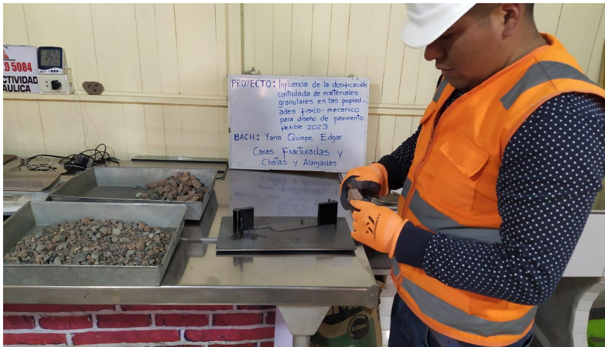
Figura 13. Trabajos en laboratorio ensayo Caras Fracturadas (Fuente propia)
