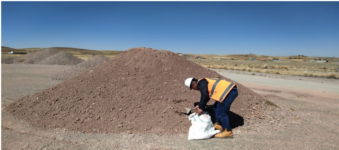
Figura 3. Muestreo material afirmado Cantera Yocara Taya Taya (Fuente propia)
