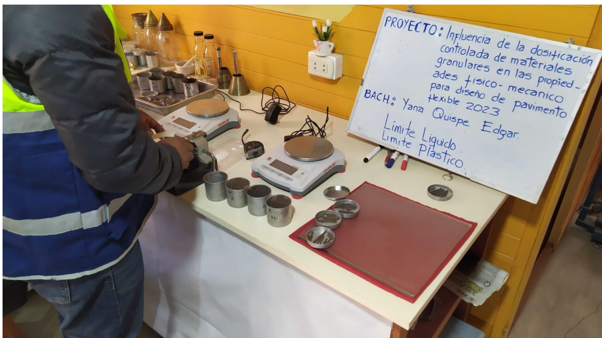
Figura 8. Trabajos en laboratorio Limites de Consistencia (Fuente propia)
