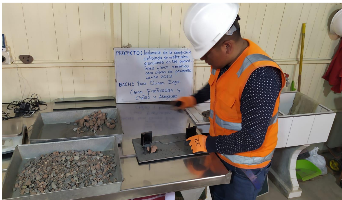
Figura 14. Trabajos en laboratorio ensayo Chatas y Alargadas (Fuente propia)
