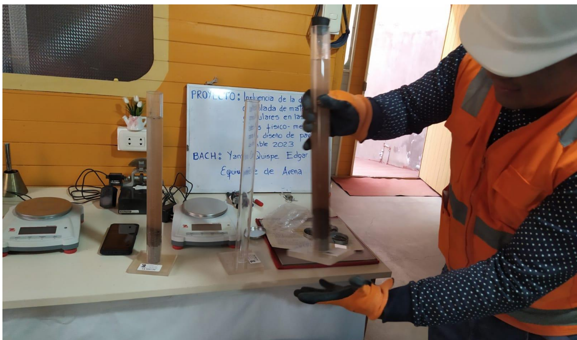
Figura 12. Trabajos en laboratorio ensayo de Equivalente de Arena (Fuente propia)
