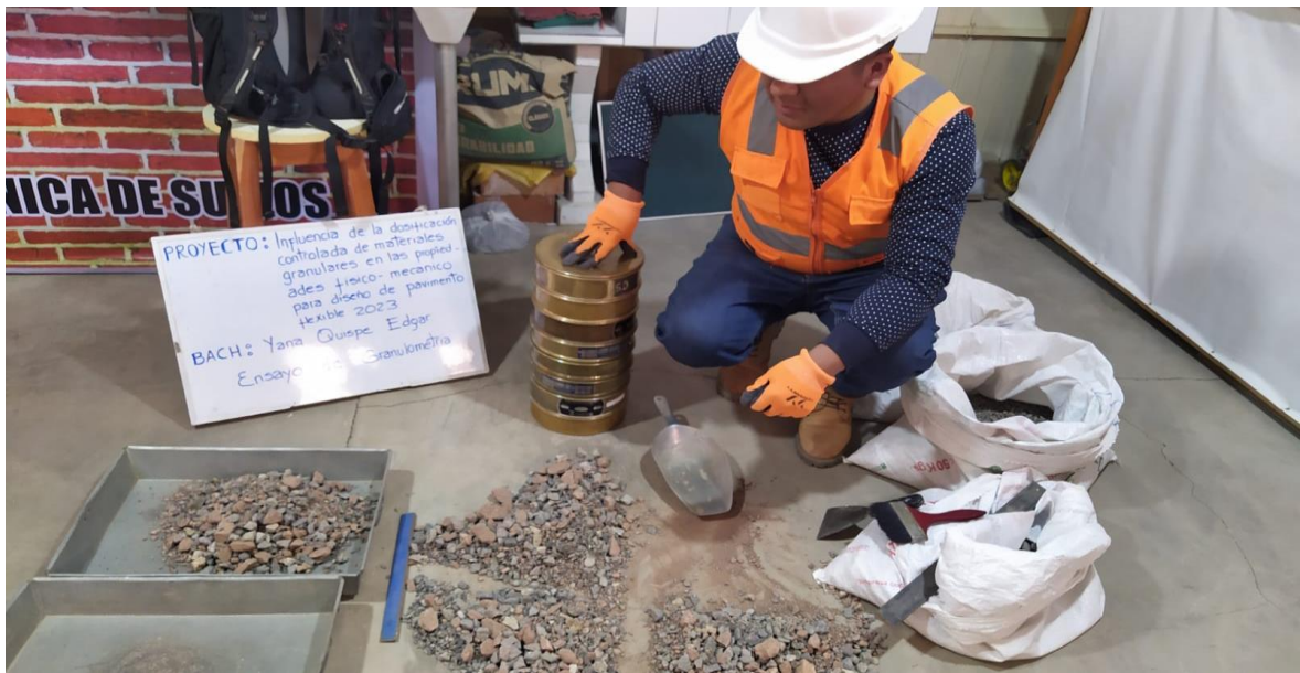
Figura 7. Trabajos en laboratorio ensayo granulometria (Fuente propia)
