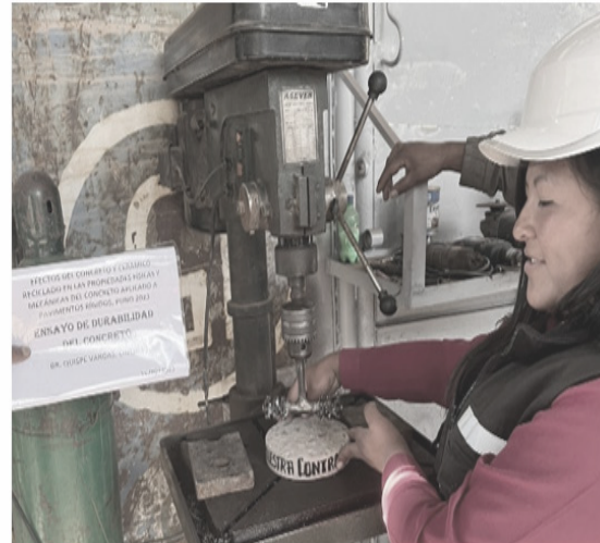
Imagen 6. Ensayo de durabilidad (desgaste) del concreto.
