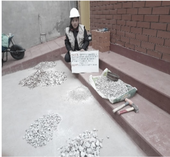
Imagen 3. Ensayos de granulometría de los agregados.
