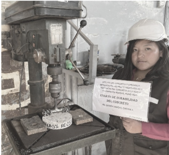
Imagen 6. Ensayo de durabilidad (desgaste) del concreto.
