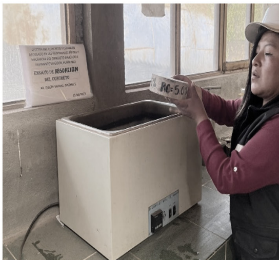
Imagen 5. Ensayo de absorción de agua del concreto.
