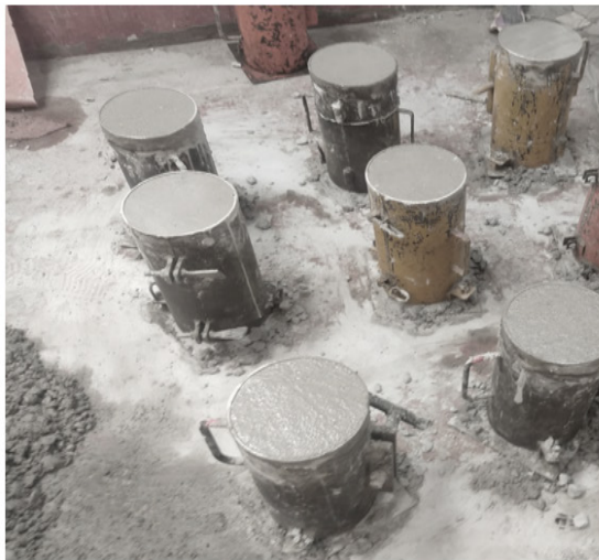
Imagen 4. Elaboración y curado de las briquetas
