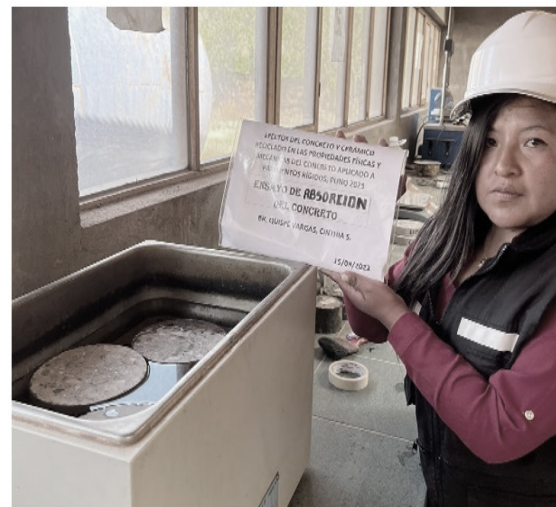
Imagen 5. Ensayo de absorción de agua del concreto.
