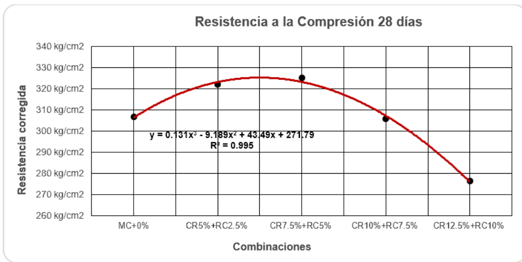
Figura 16. Curva de resistencia a la compresión – 28 días.
