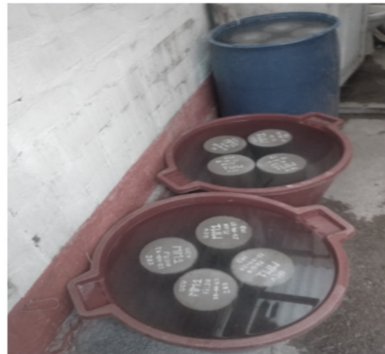
Imagen 4. Elaboración y curado de las briquetas
