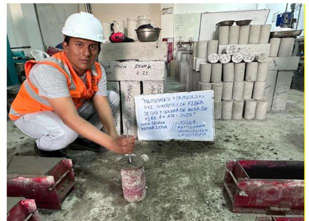
Fotografía 16. Elaboración de probetas
