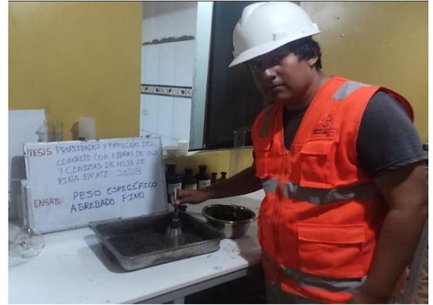
Fotografía 8. Absorción y gravedad específica del agregado fino
