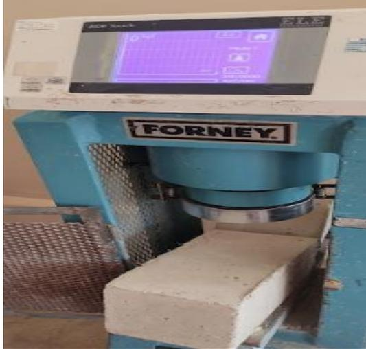
Fotografía 19. Rotura de vigas
