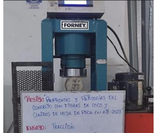
Fotografía 20. Rotura de probetas para tracción indirecta
