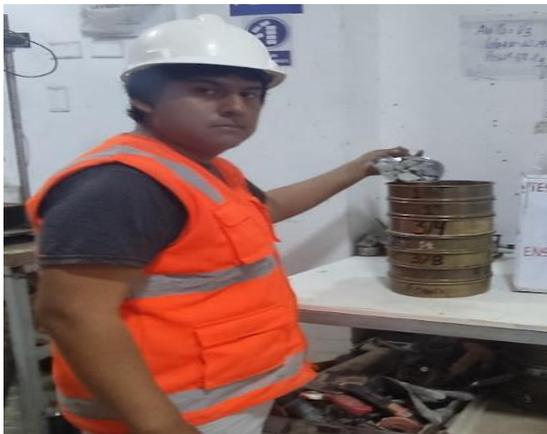
Fotografía 5. Granulometría del agregado.
