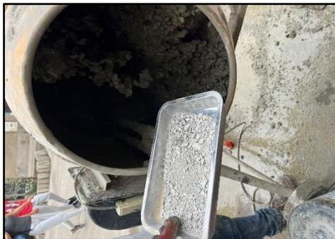
**Figura 19:** Adición de RCD.
