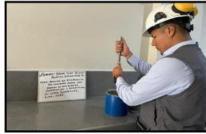
**figura 07:** compactado del agregado fino
