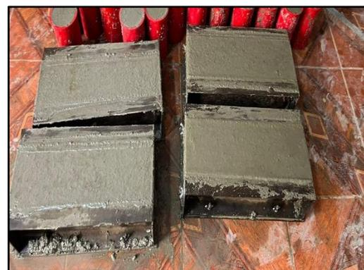
**Figura 24:** Vigas rectangulares para ensayo a flexión.
