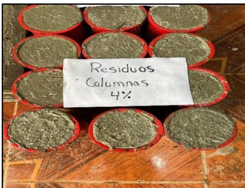
**Figura 23:** Probetas cilíndricas para ensayo a compresión.
