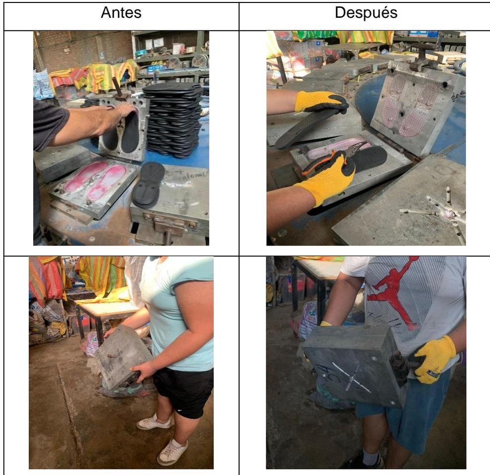
Figura 11. Implementación de EPP y herramienta.
