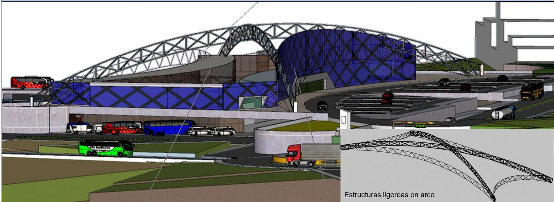
Configuración y ensamblaje de estructura ligera reticular, aplicado como base de la cubierta de la armadura Diagrid.
