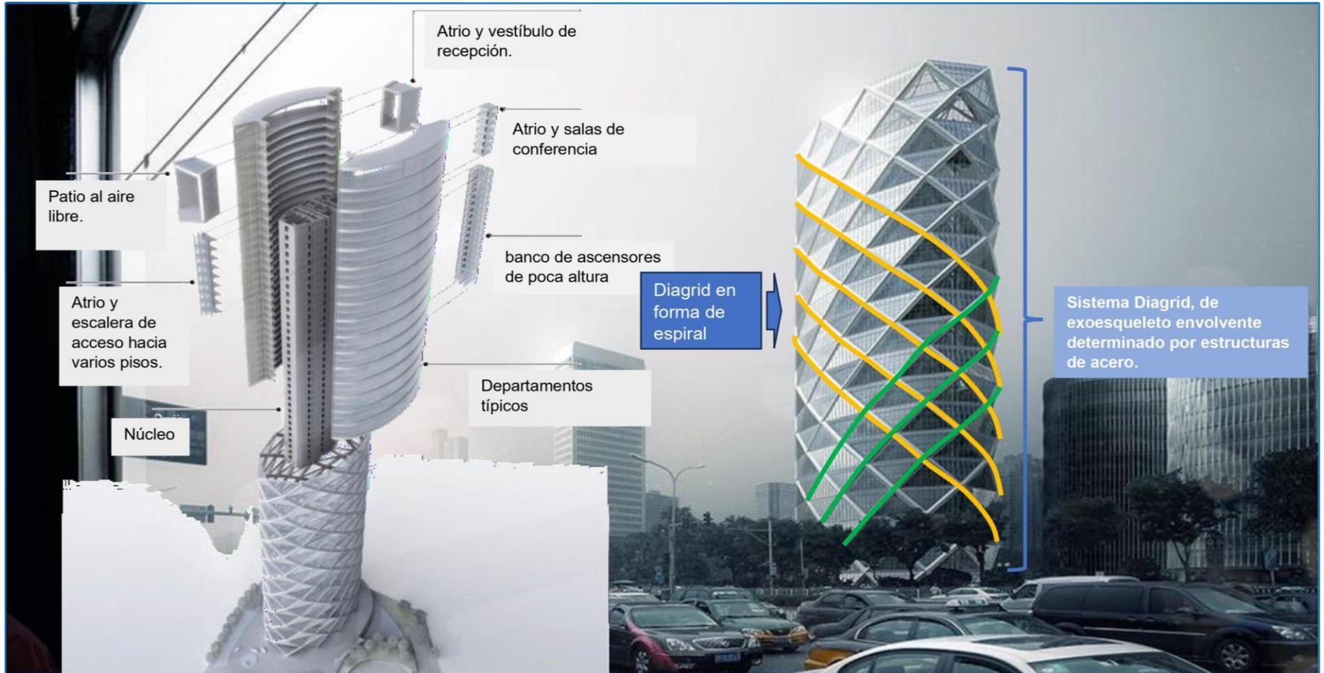
Nota: Detalle esquemático de ambientes y la aplicación del sistema Diagrid a partir de un patrón espiral en la configuración reticular del Diagrid por medio del acero.
