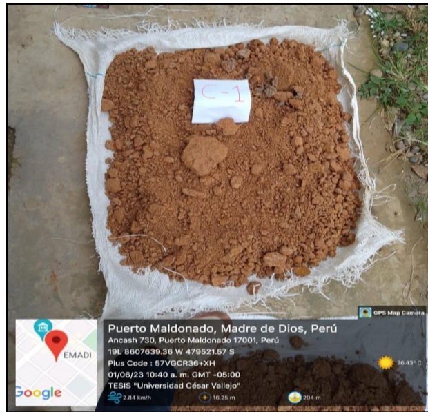
Secado de muestra de calicata C-1
