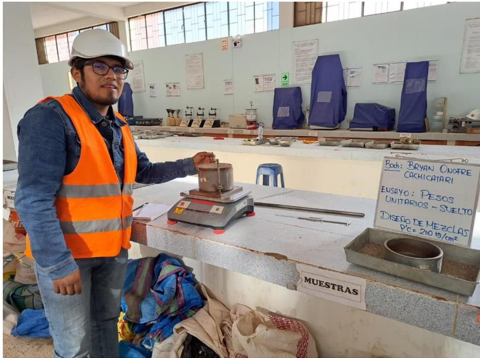
**Fotografía 5.** *Ensayo de peso unitarios (pesado de agregado).*
