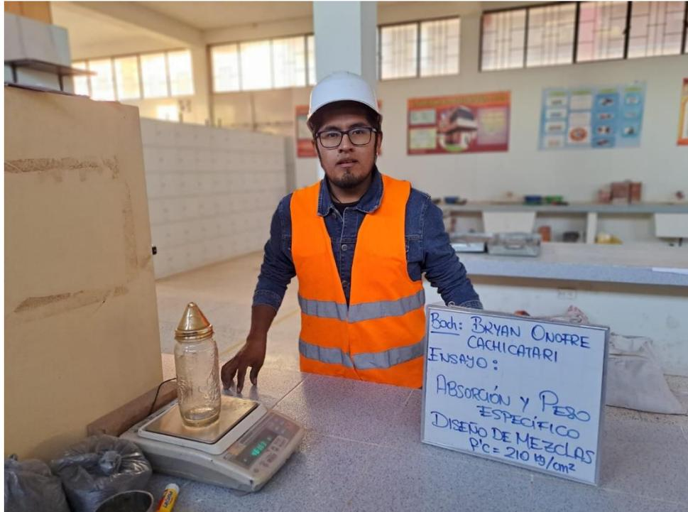
**Fotografía 15.** Ensayo de absorción y peso específico.
