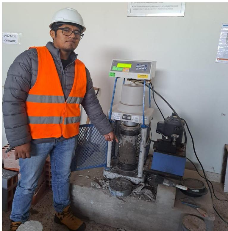
**Fotografía 30.** Ensayo de rotura de briquetas (rotura a los 28 días).
