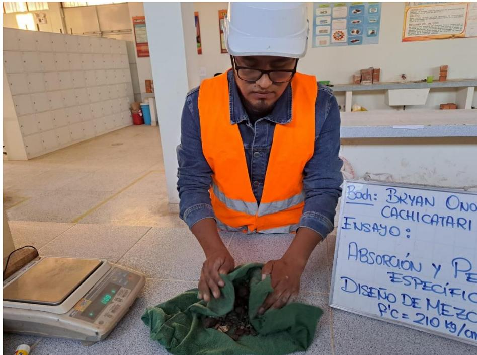
**Fotografía 17.** Ensayo de absorción y peso específico.
