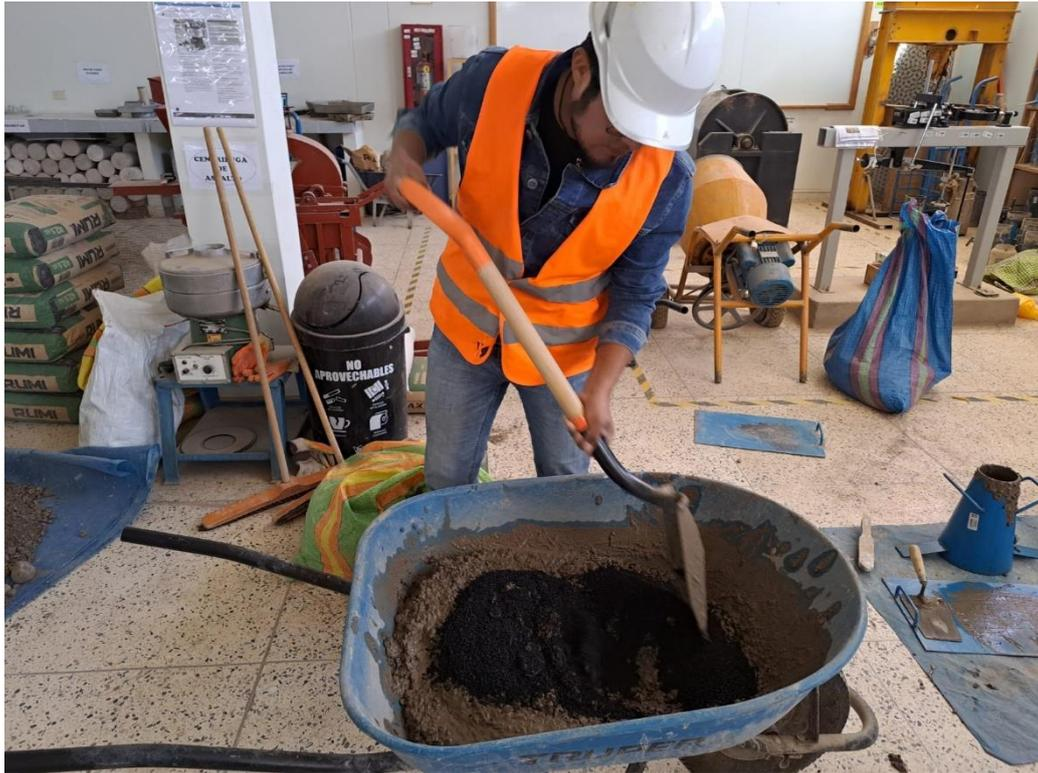
**Fotografía 21.** Ensayo de elaboración de probetas.
