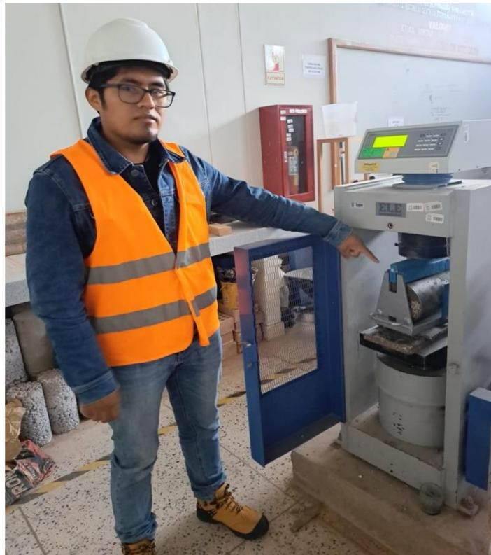
**Fotografía 34.** *Ensayo de rotura de briquetas.*
