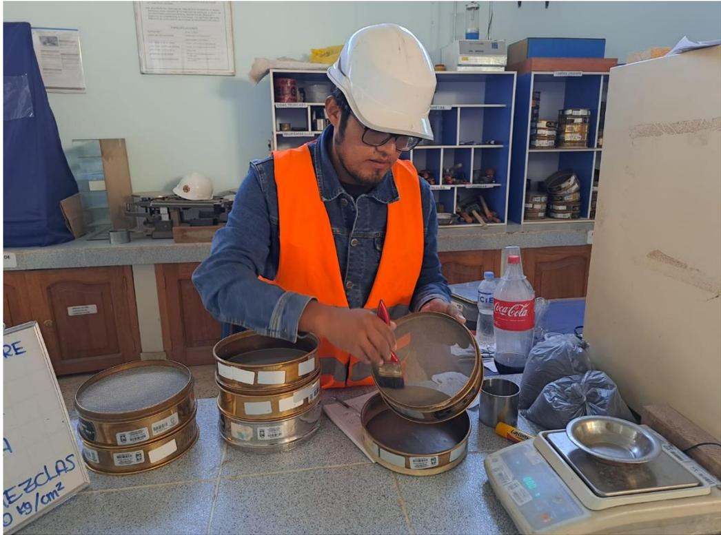
**Fotografía 13.** Granulometría tamizaje de agregados.
