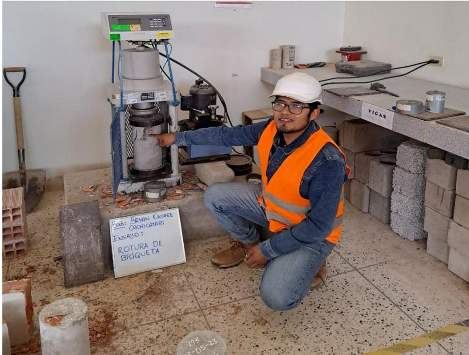
**Fotografía 27.** Ensayo de rotura de briquetas a los 7 días.
