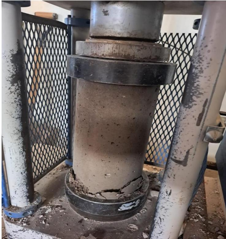
**Fotografía 29.** Ensayo de rotura de briquetas compresión.
