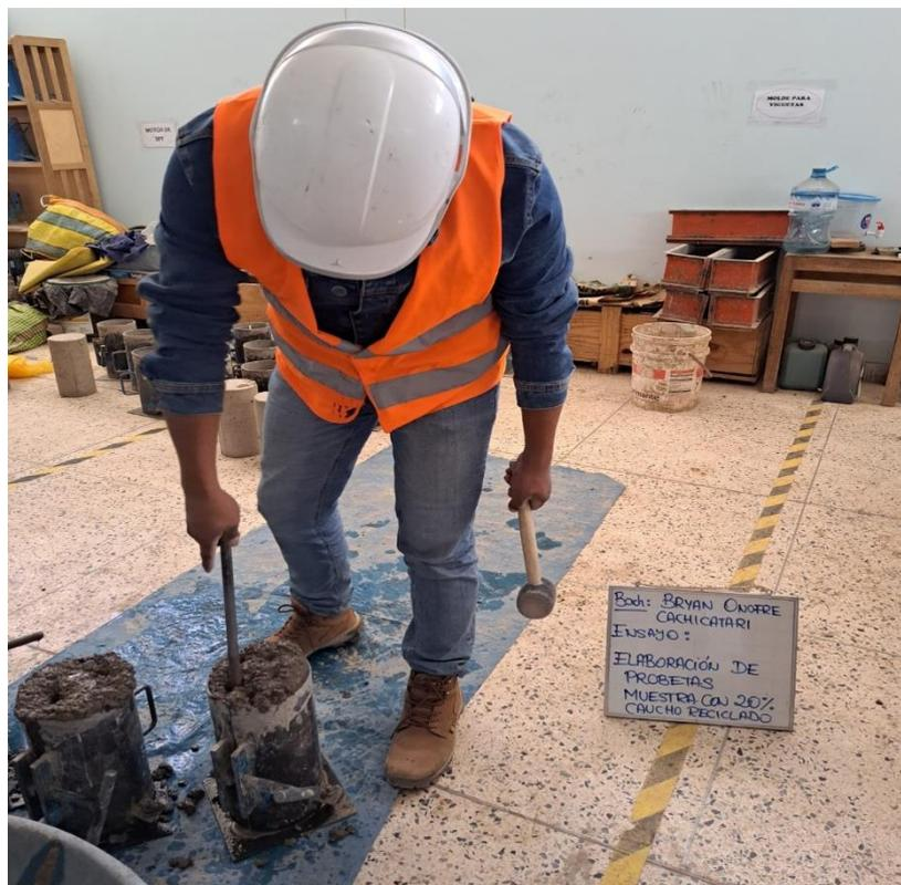
**Fotografía 22.** Ensayo de elaboración de probetas muestra con 20%.
