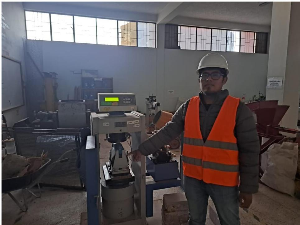
**Fotografía 32.** Ensayo rotura de briqueta.
