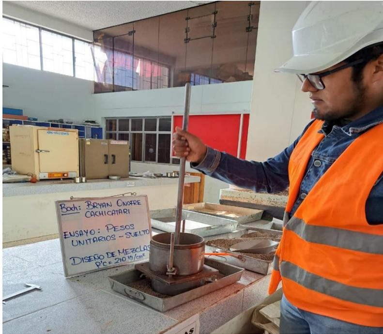
**Fotografía 7.** Ensayo de peso unitarios sueltos (varillado de muestra).
