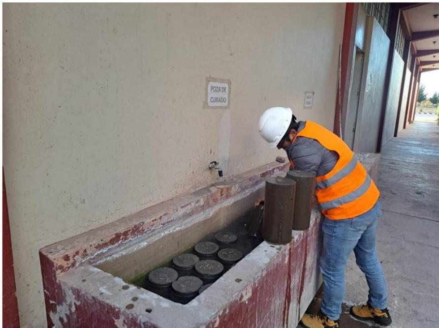
**Fotografía 26.** Ensayo de rotura de briquetas (termino de curado).
