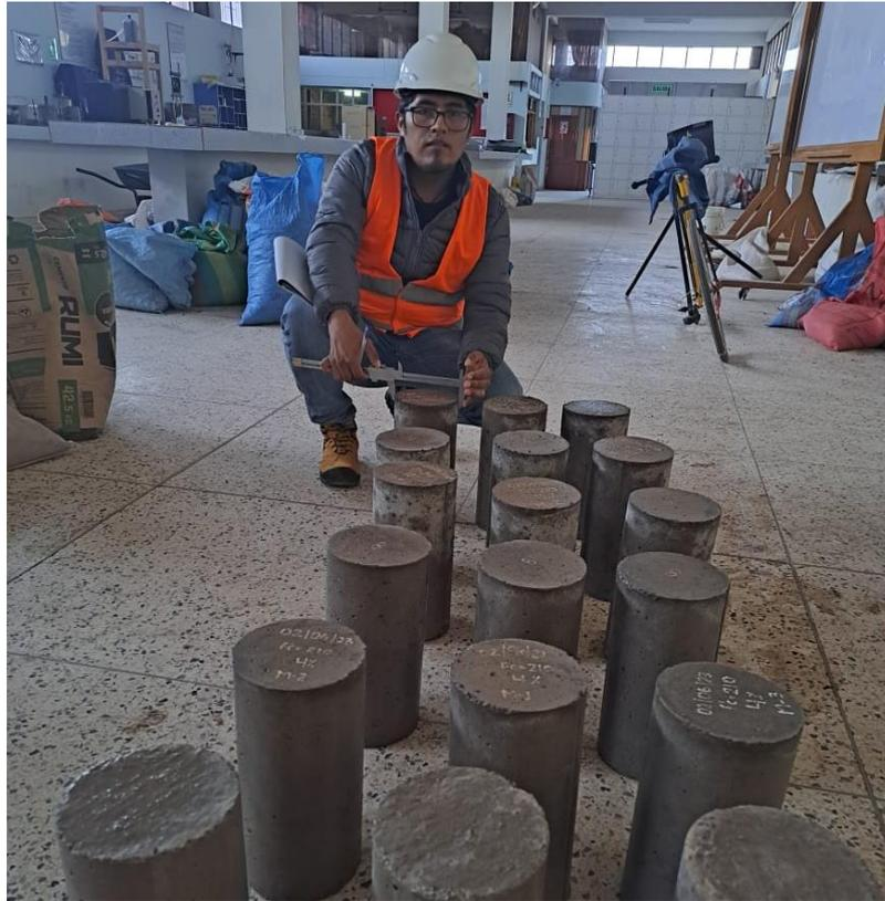
**Fotografía 25.** Ensayo de rotura de briquetas (medición de diámetro).
