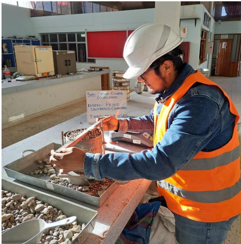
**Fotografía 8.** Ensayo de peso unitarios (nivelado de muestra en molde).
