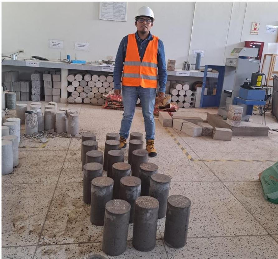
**Fotografía 24.** Ensayo de rotura de briquetas (culminado de curado).
