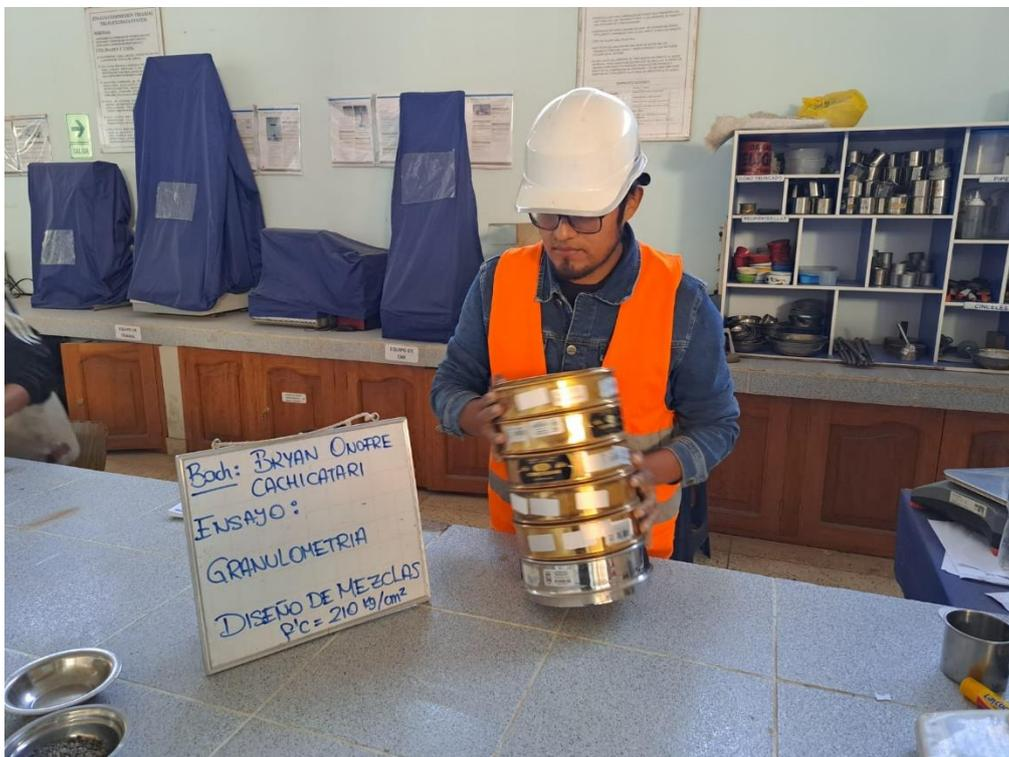
**Fotografía 12.** Granulometría tamizaje de agregados.
