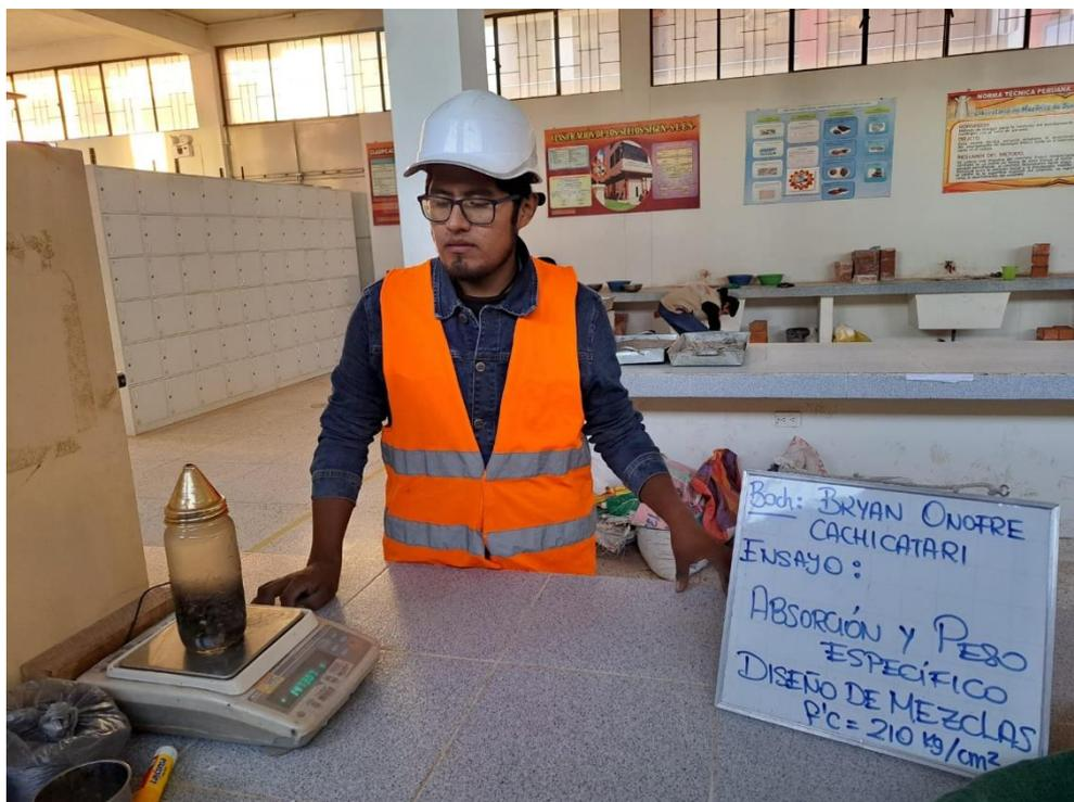
**Fotografía 16.** Ensayo de absorción y peso específico.
