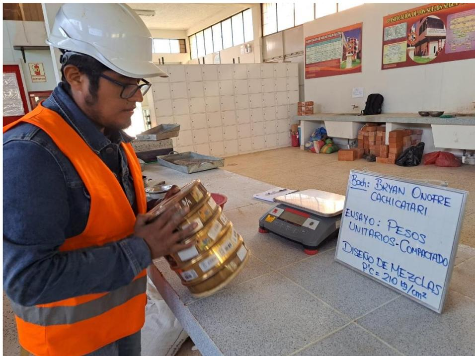
**Fotografía 10.** Granulometría tamizaje de agregados.
