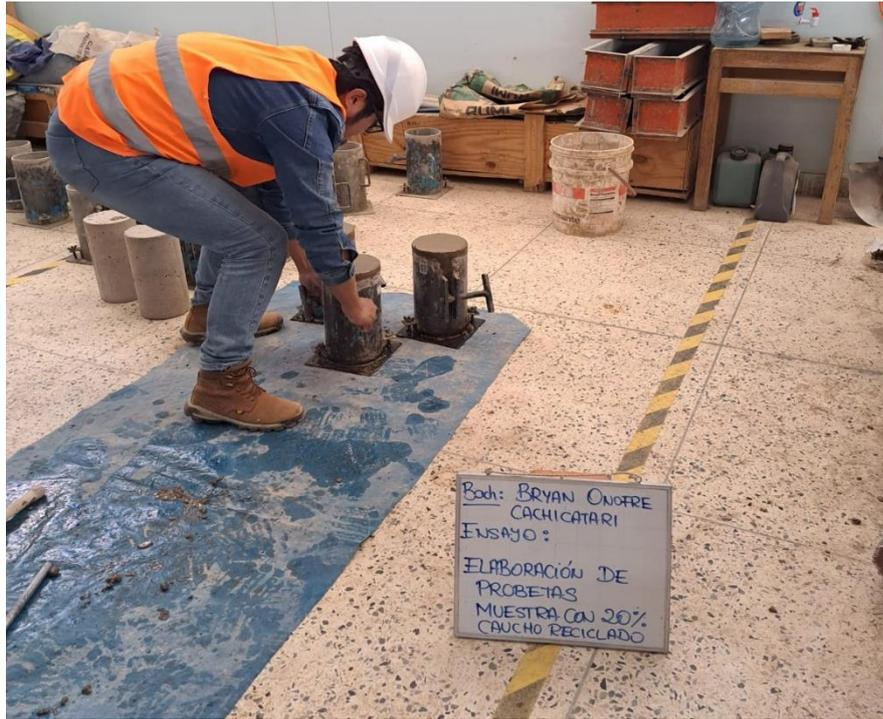
**Fotografía 23.** Ensayo de peso unitarios (nivelado de muestra en molde).
