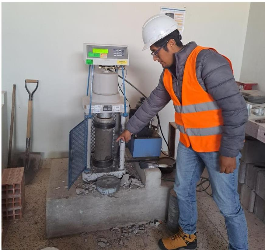
**Fotografía 28.** Ensayo de rotura de briquetas compresión.
