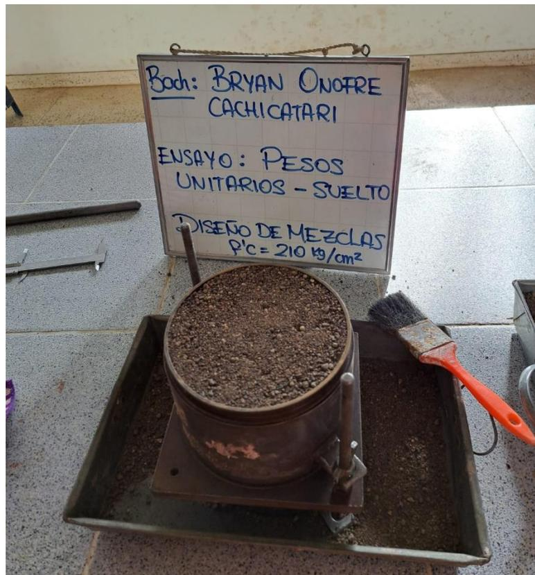
**Fotografía 6.** *Ensayo de peso unitarios sueltos (compactado).*
