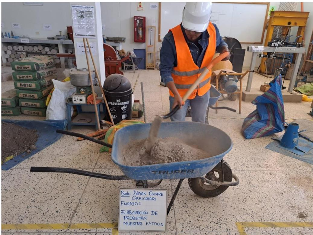
**Fotografía 20.** Ensayo de elaboración de probetas.
