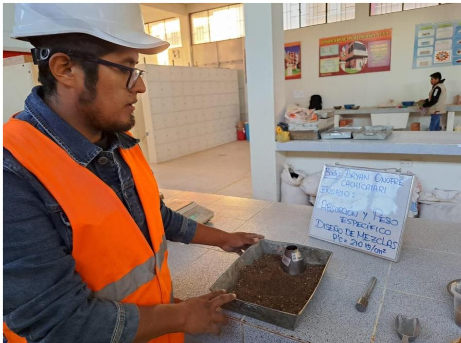
**Fotografía 18.** Ensayo de absorción y peso específico.
