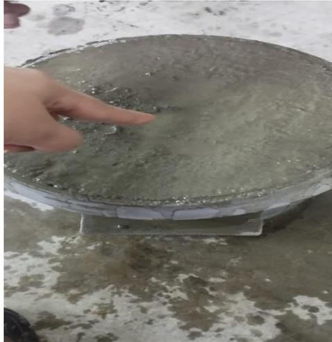
Figura 5. Exudación de la mezcla
