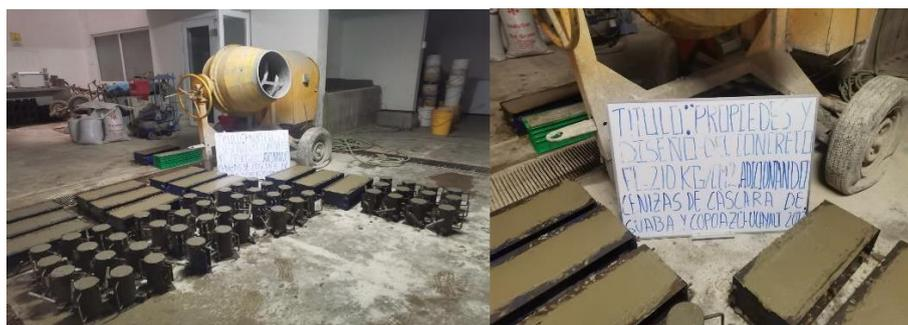
Figura 19. Mezclas de concreto adicionando CCG y CCC
