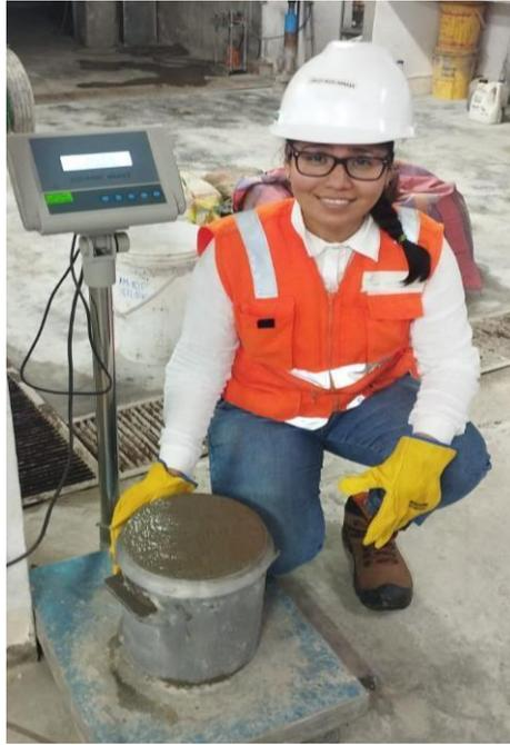
Figura 28. Ensayo de peso unitario de mezclas de concreto
