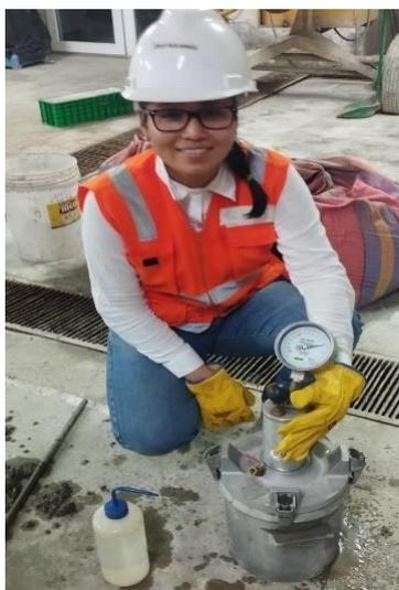
*Figura 7. Contenido de aire de mezcla*
