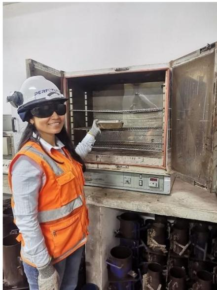
Figura 25. Contenido de humedad en agregados
