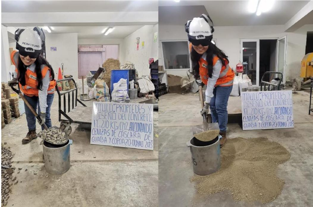
Figura 23. Peso unitario en agregados
