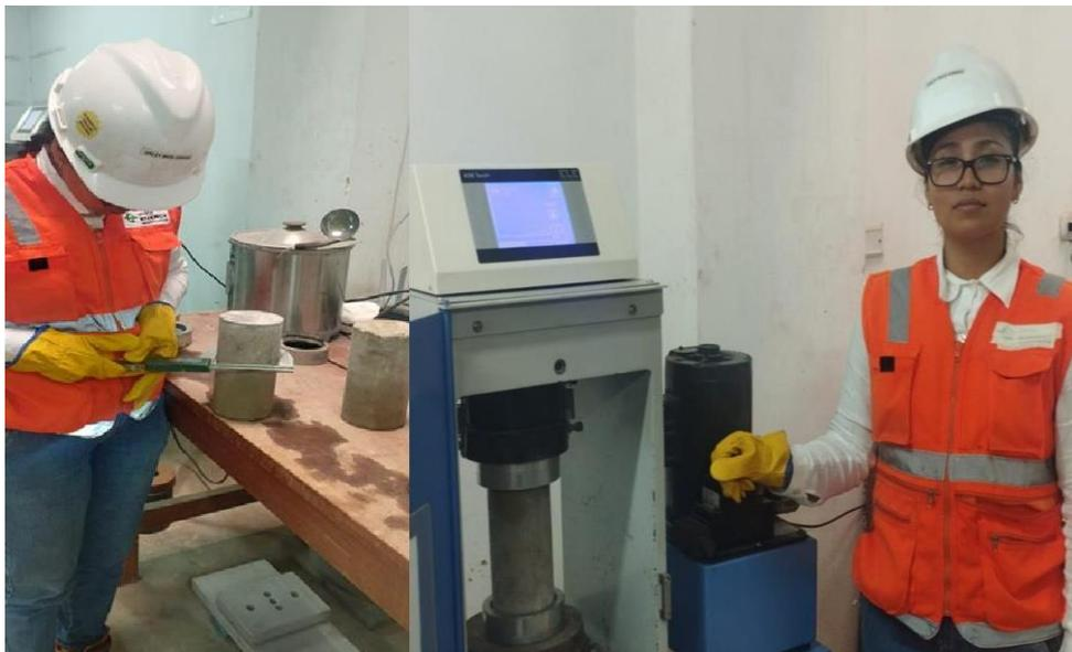
*Figura 34.* Ensayo a compresión de mezclas de concreto
