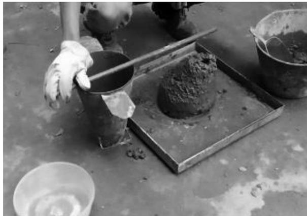
*Figura 4.* Ensayo de asentamiento
