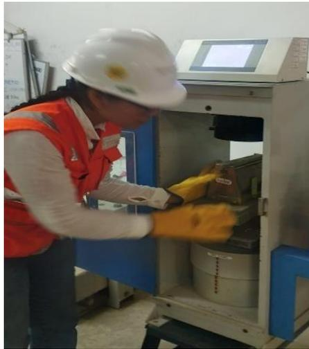
*Figura 39.* Ensayo de esfuerzo a la tracción de mezclas de concreto
