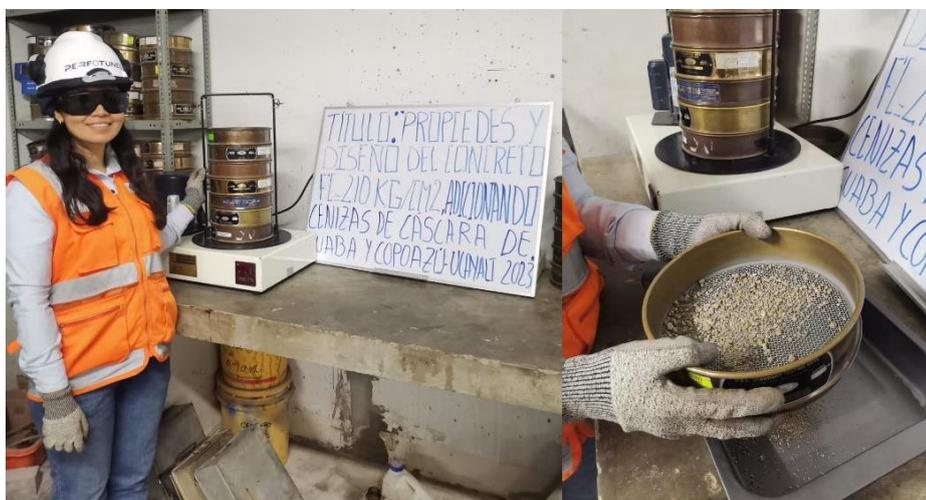
Figura 20. Tamizado en agregados
