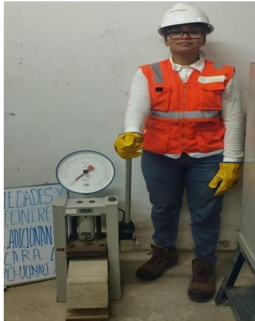
Figura 44. Ensayo de módulo de rotura de mezclas de concreto
