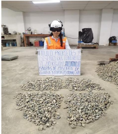
Figura 15. Cuarteo en agregado grueso
