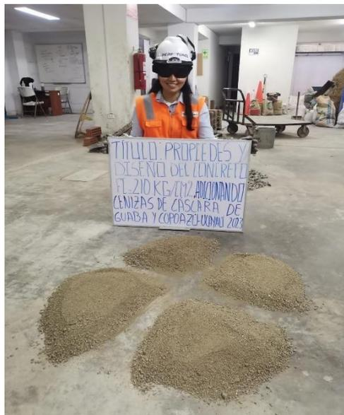
Figura 16. Cuarteo en agregado fino
