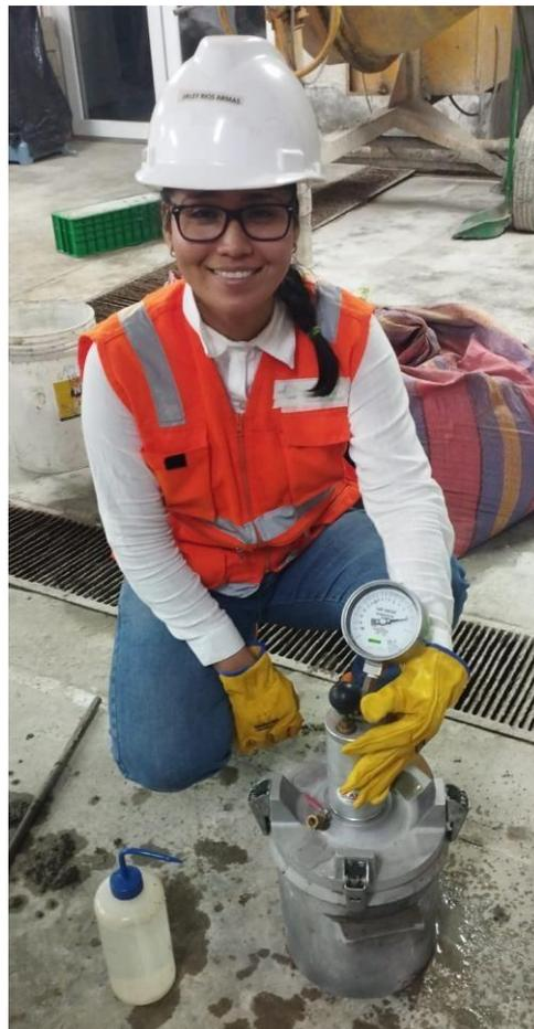
Figura 30. Ensayo de contenido de aire de mezclas de concreto
