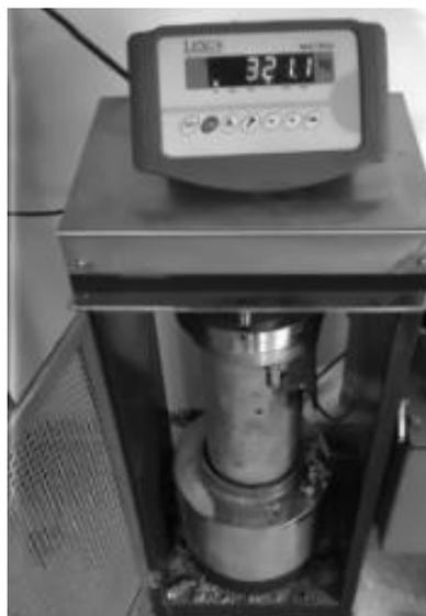
Figura 10. Prensa hidráulica para rotura a compresión
