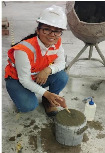
Figura 32. Ensayo de exudación de mezclas de concreto
