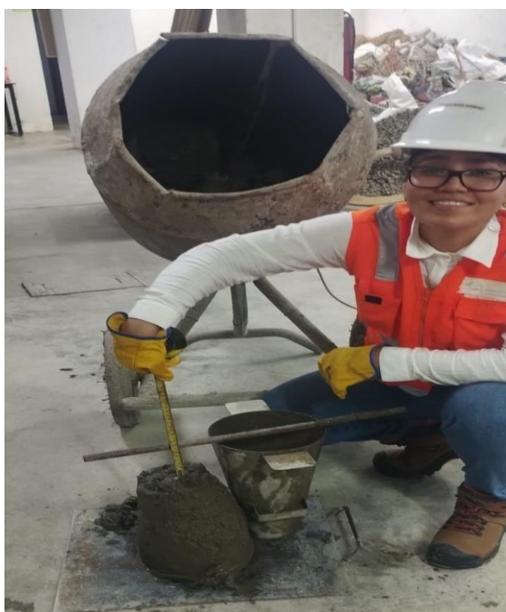
Figura 26. Ensayo de asentamiento de mezcla de concreto
