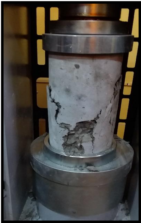
Fotografía N° 27: Probetas con grietas y resquebrajadas luego del ensayo de resistencia a la compresión a los 7 días.
