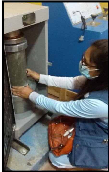
Fotografía N° 29: Colocado de la probeta en la prensa automática de ensayo de compresión.
