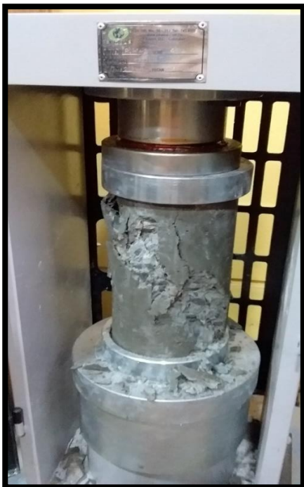
Fotografía N° 30: Compresión de las probetas con grietas y resquebrajadas luego del ensayo de resistencia a la compresión a los 14 días.
