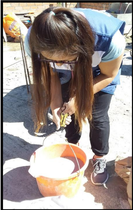
Fotografía N° 10: Pesado del relave minero para la elaboración de la mezcla de concreto.
