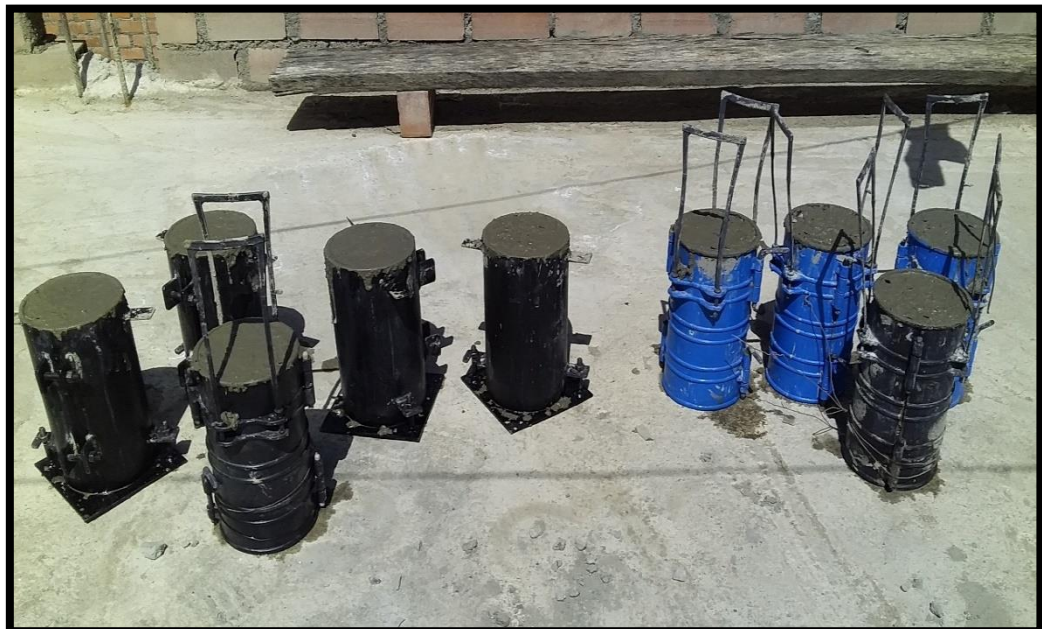
Fotografía N° 18: Culminación de la elaboración de las Probetas de concreto
