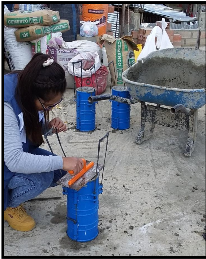
Fotografía N° 17: Enrazado y enlucido de las probetas.
