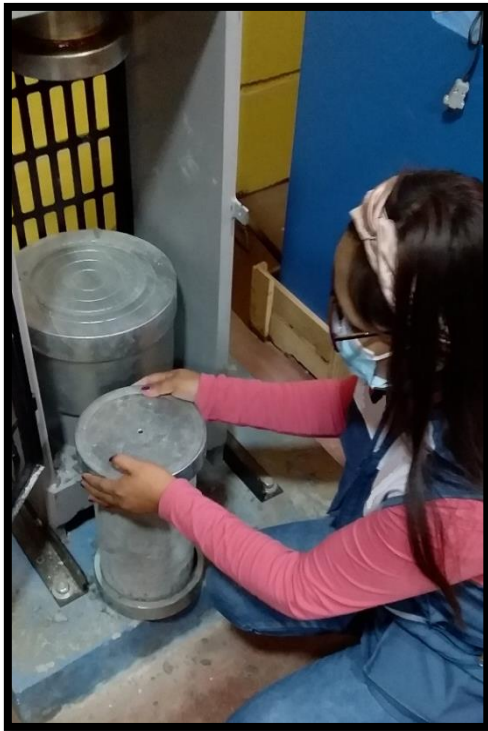
Fotografía N° 25: Realizado del ensayo de compresión del concreto al 50%.
