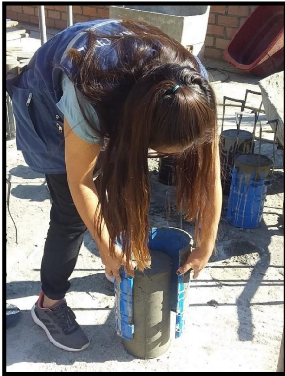
Fotografía N° 19: Desencofrado de los moldes de las probetas de concreto
