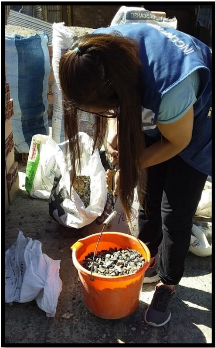
Fotografía N° 9: Pesado del agregado grueso para la elaboración de la mezcla de concreto.
