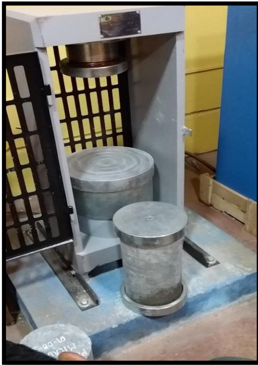
Fotografía N° 23: Realizado del ensayo de compresión del concreto patrón.
