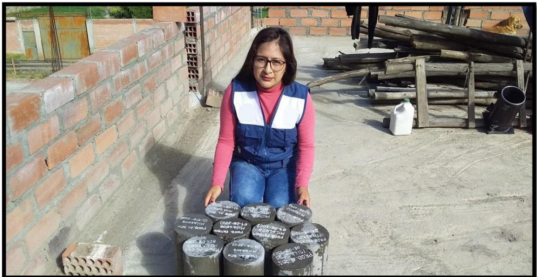
Fotografía N° 22: Probetas de concretas listas para la compresión a los 7 días de curado.
