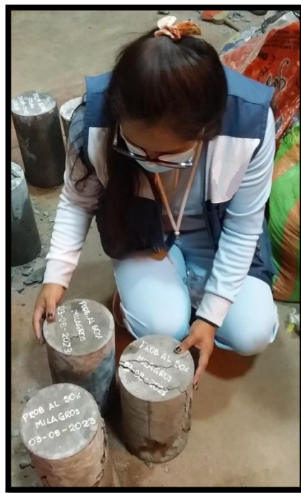
Fotografía N° 30: Compresión de las probetas con grietas y resquebrajadas luego del ensayo de resistencia a la compresión a los 14 días.
