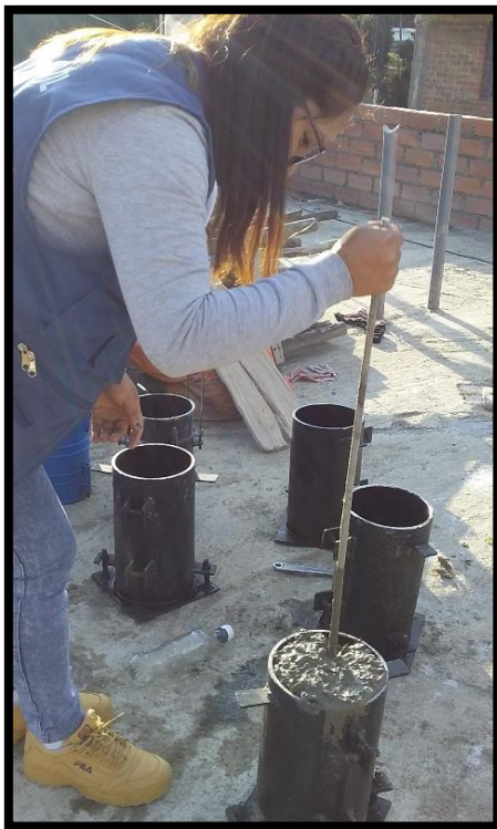
Fotografía N° 16: Varillado de la mezcla de concreto.
