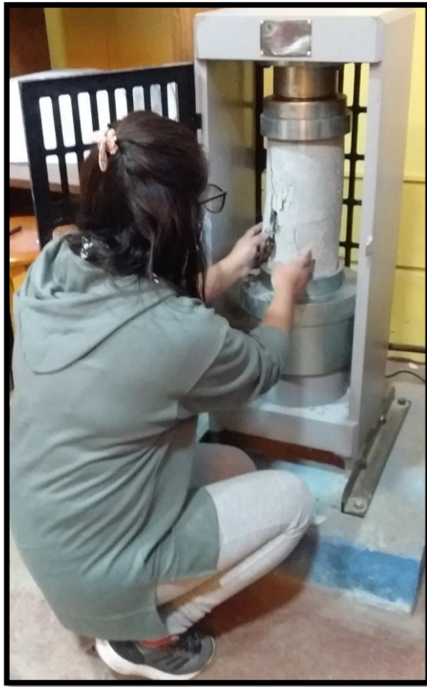
Fotografía N° 33: Probetas luego del ensayo de resistencia a la compresión a los 28 días con grietas y resquebrajadas.
