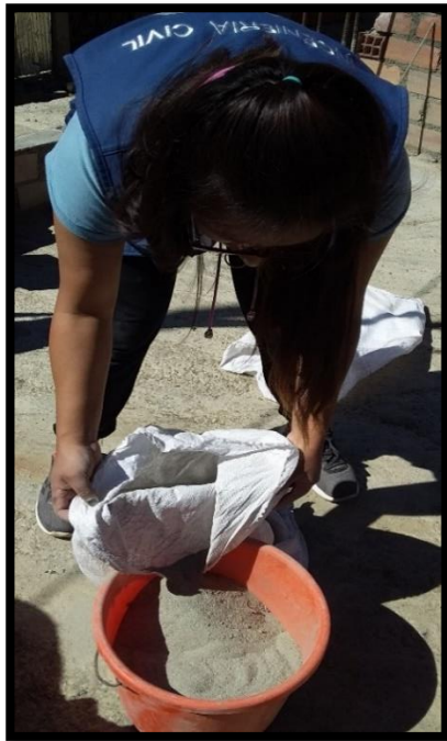
Fotografía N° 11: Pesado del agregado fino para la elaboración de la mezcla de concreto.
