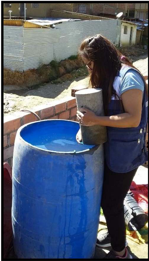
Fotografía N° 21: Curado de las probetas de concreto.
