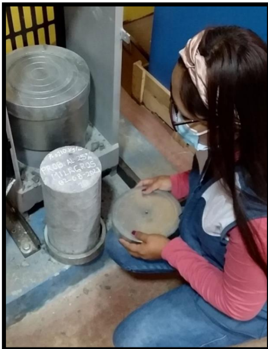
Fotografía N° 24: Realizado del ensayo de compresión del concreto al 25%.
