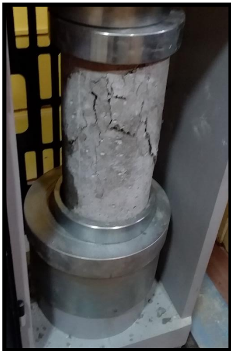
Fotografía N° 26: Observando el tipo de rotura en las probetas luego de realizar el ensayo de compresión.
