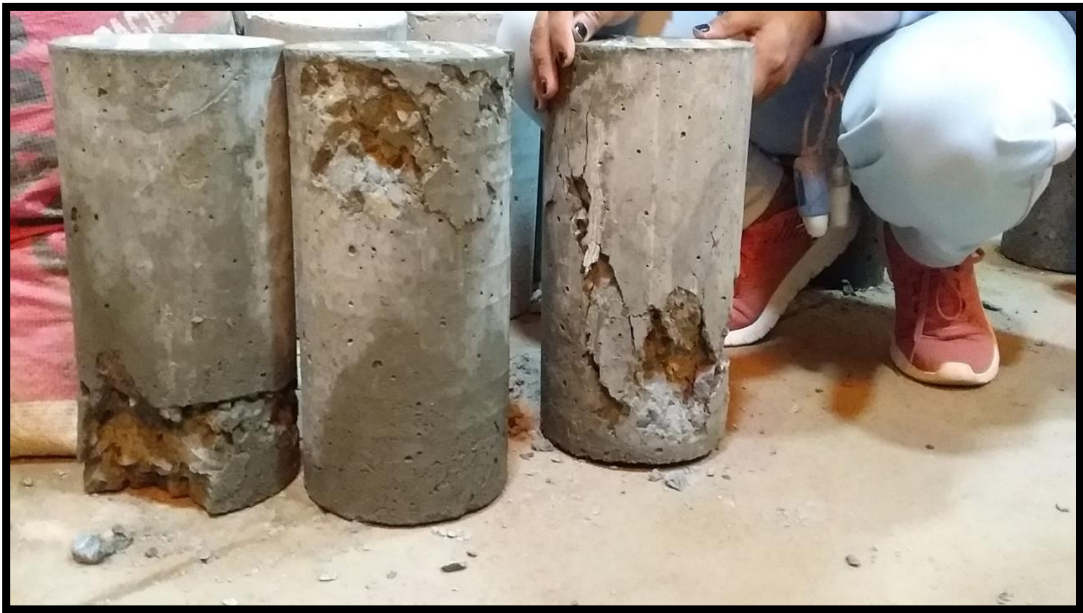
Fotografía N° 31: Probetas con grietas y resquebrajadas luego del ensayo de resistencia a la compresión a los 14 días.
