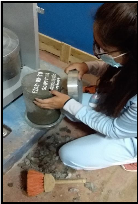
Fotografía N° 29: Colocado de la probeta en la prensa automática de ensayo de compresión.
