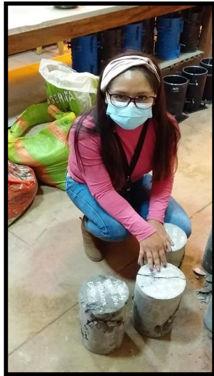
Fotografía N° 27: Probetas con grietas y resquebrajadas luego del ensayo de resistencia a la compresión a los 7 días.
