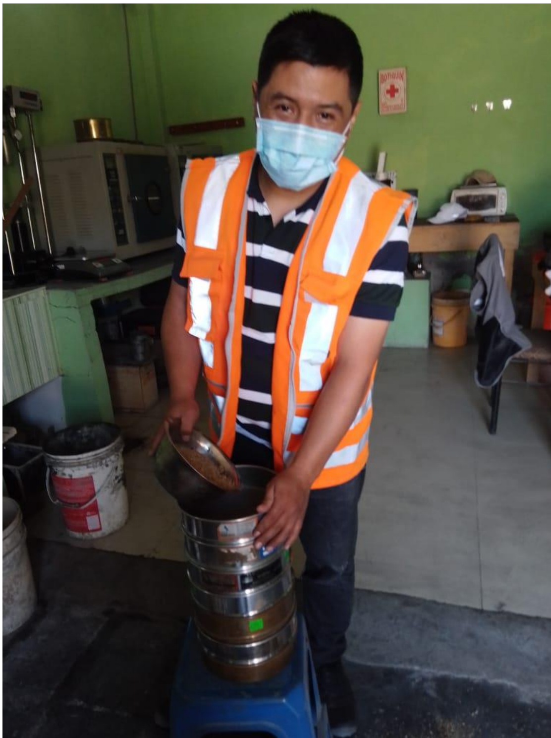
8.11: Fotografía representativa del análisis granulométrico tamizado del agregado fino
