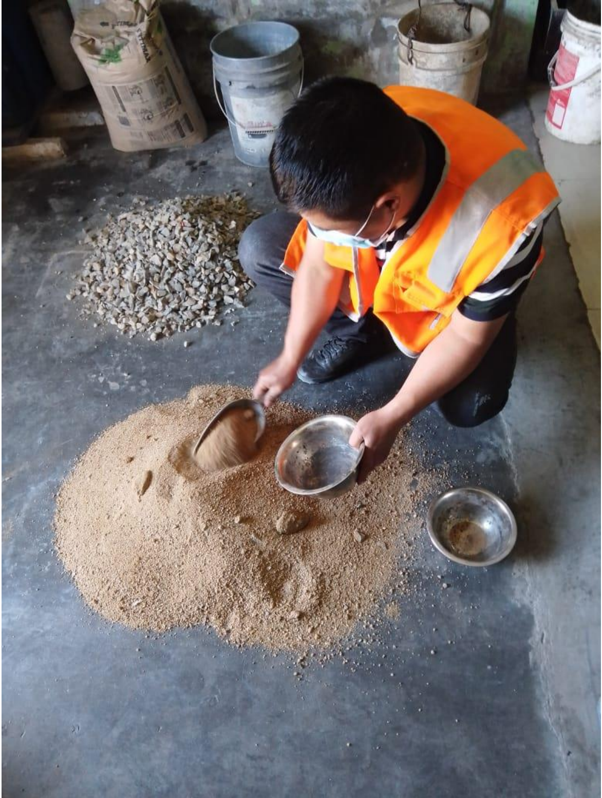
8.13:: Fotografía representativa en los ensayos de pesos volumétricos de los agregados
