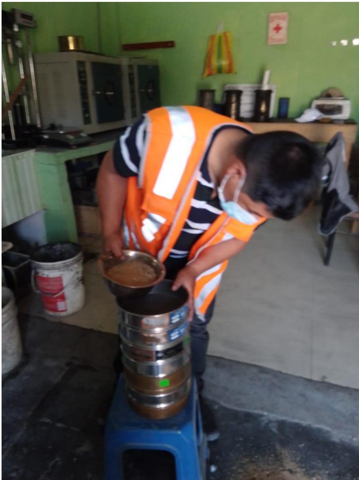
8.10: Fotografía representativa del análisis granulométrico del agregado fino
