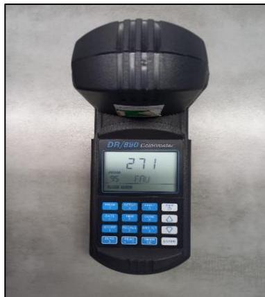
**Figura 25.** Medición de turbidez de las muestras de aguas contaminadas
