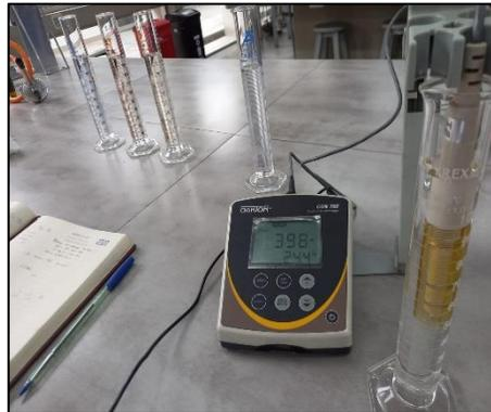
**Figura 26.** Medición de la Conductividad eléctrica de las muestras de aguas contaminadas
