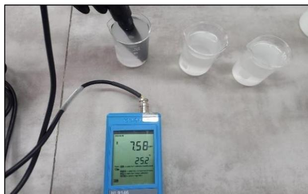
**Figura 27.** Medición con oxímetro (DBO5) de las muestras de aguas contaminadas previa incubación
