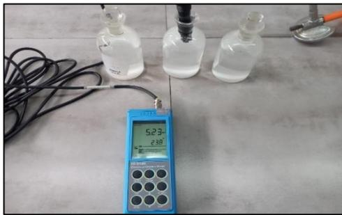
**Figura 29.** Medición con oxímetro (DBO5) de las muestras de aguas contaminadas post-incubación
