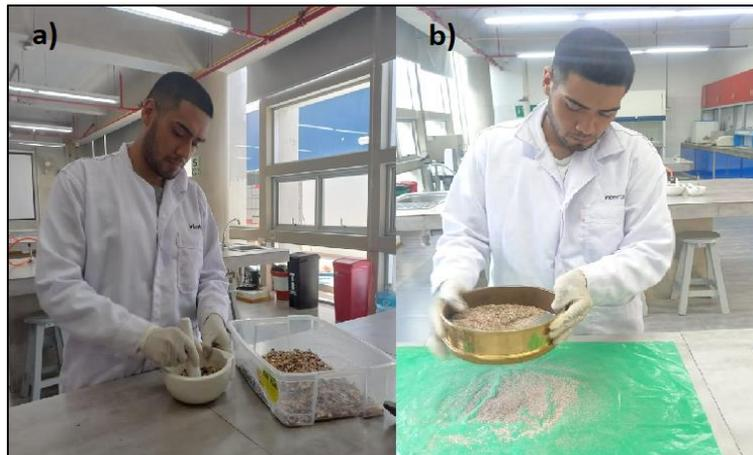
**Figura 22.** a) molienda de la muestra, b) tamizado de la muestra a  $500\mu m$
