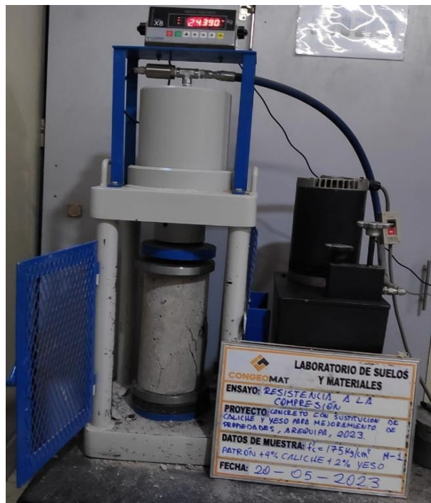
Resistencia a la compresión del diseño patron con sustitución de 4% caliche y 2% yeso
