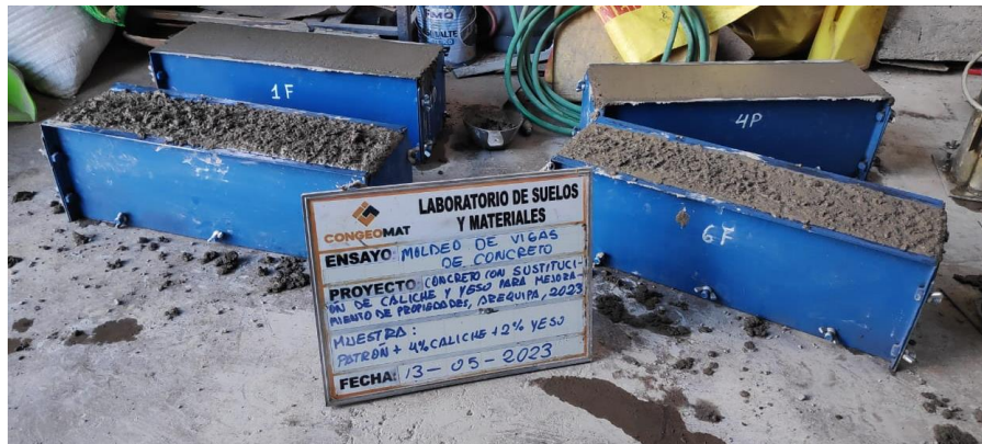
Moldeo de prismas de concreto
