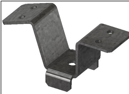
Figura 37. Soporte de fijación intermedia inclinada de paneles. Fuente: Elaborado por los investigadores.
