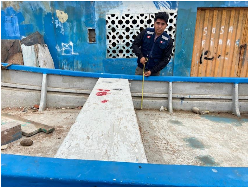
Mediciones longitudinales de embarcación de fibra de vidrio de 8m de eslora.
