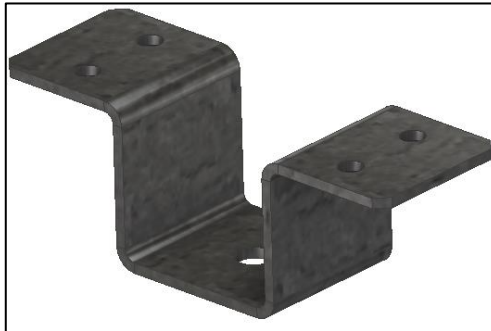
Figura 36. Soporte de fijación intermedia de paneles. Fuente: Elaborado por los investigadores.
