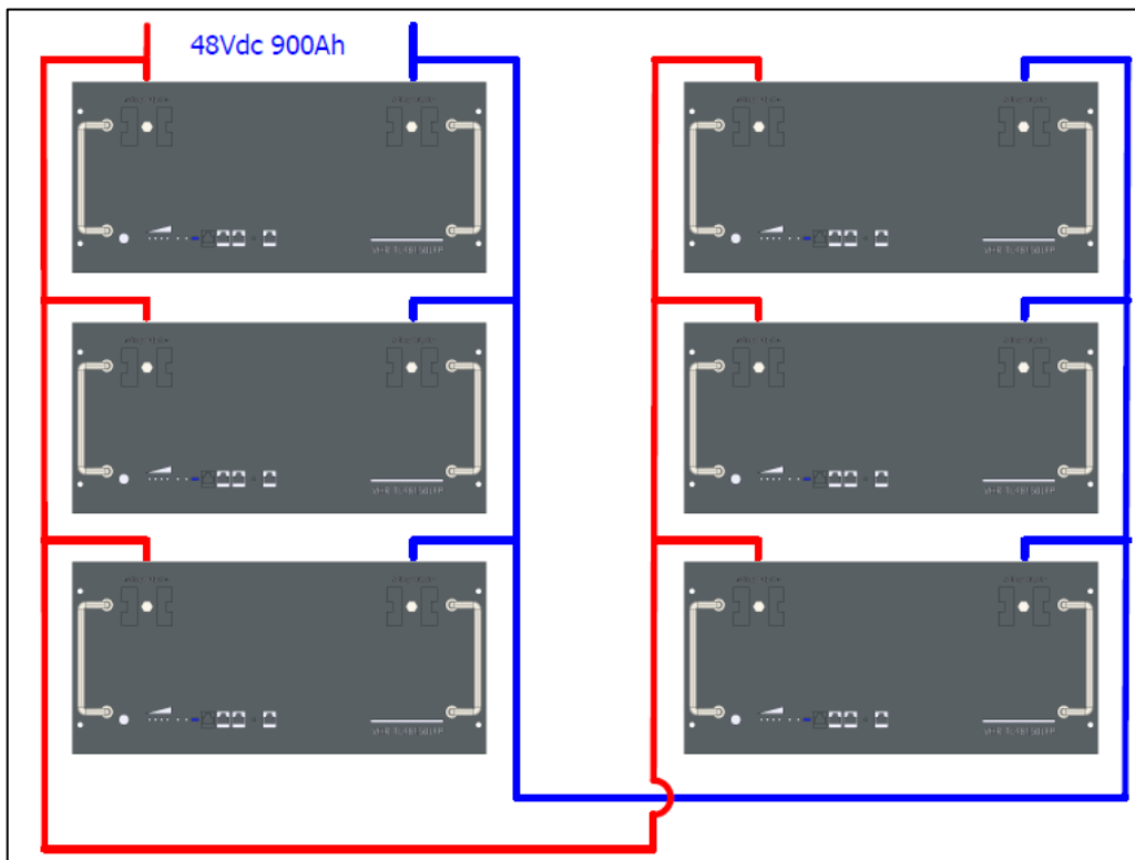
Figura 20. Tipo de conexión de baterías.
