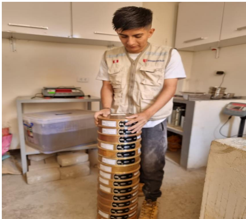
Figura 40: Realización de tamizado Fuente: Elaboración propia
