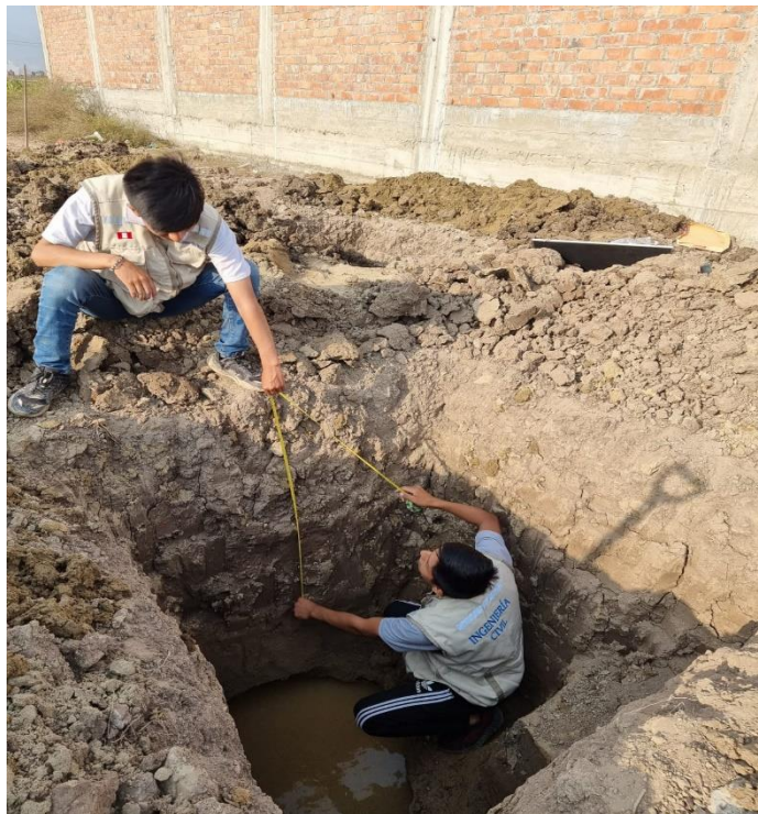
Figura 32: Tomando la altura de uno de los estratos a extraer de la calicata
