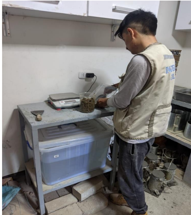
Figura 37: Realización de peso unitario de las muestras.
