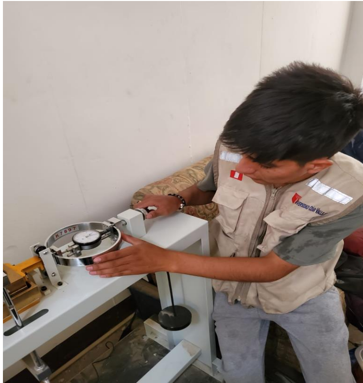
Figura 43: Realizando corte directo
