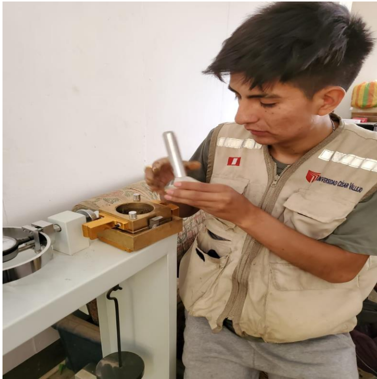
Figura 42: Colocando la muestra para realizar corte directo
