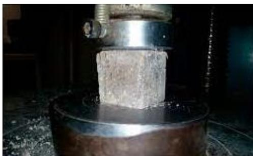
Figura 1. Resistencia a compresión en cubos de adobe
