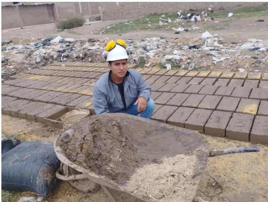
Los componentes empleados para la elaboración del adobe fueron: La tierra extraída de la cantera, agua para el amasado, pajilla de arroz. Para los adobes modificados el único cambio fue la incorporación de la fibra de bagazo de caña de azúcar.
