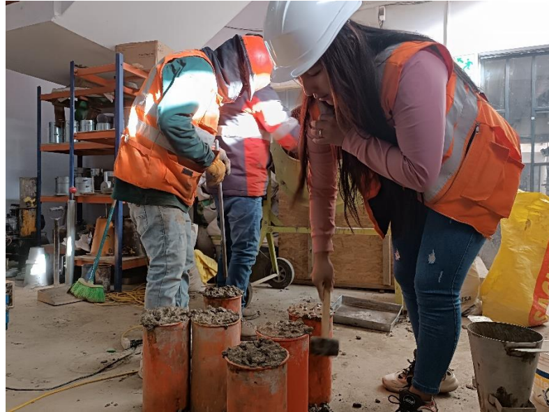
Figura 42. Moldeo de especímenes cilíndricos.
