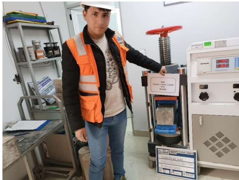
Figura 75. Ensayo de resistencia a la flexión.
