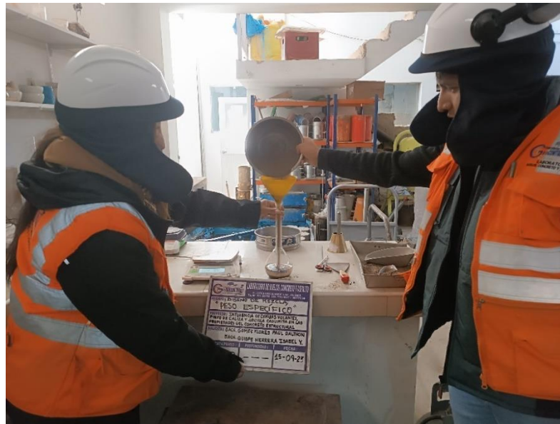
Figura 29. Ensayo de peso específico del agregado fino.
