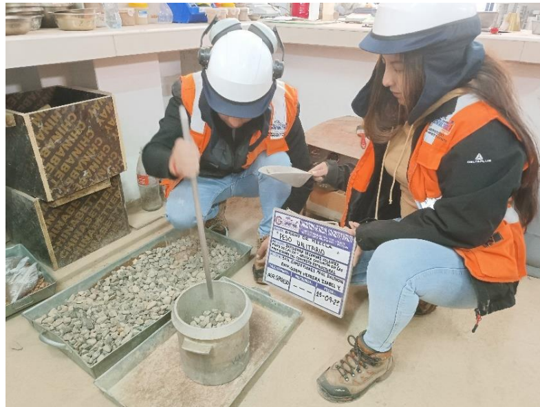
Figura 32. Ensayo de peso unitario suelto y compactado del agregado grueso.
