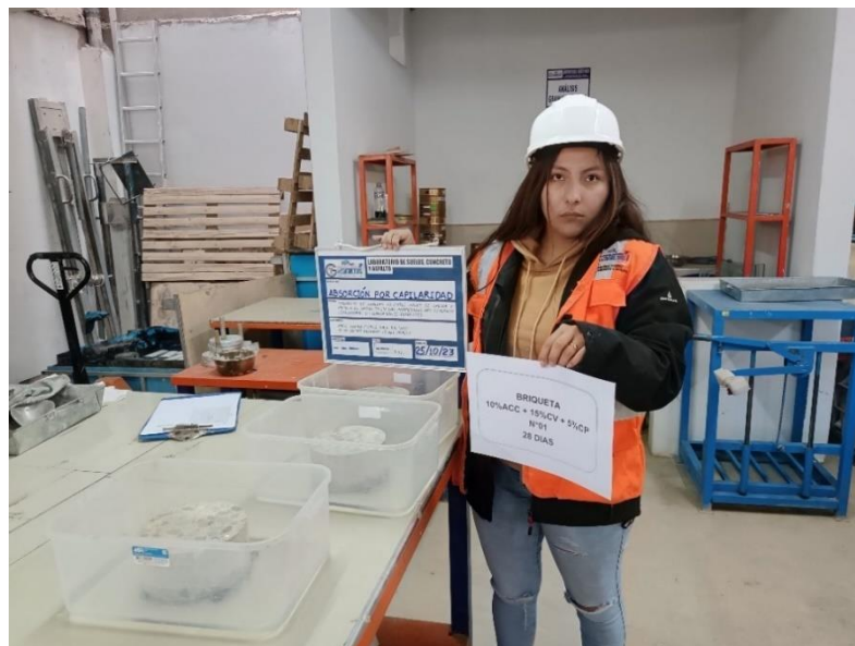
Figura 78. Ensayo de absorción por capilaridad.
