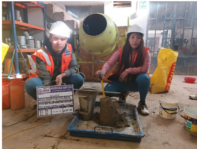
Figura 40. Prueba de asentamiento del concreto.
