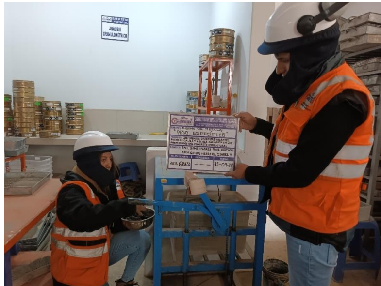
Figura 30. Ensayo de peso específico del agregado grueso.
