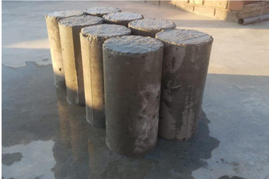
Figura 9. Probetas de Concreto para ensayo de resistencia. (Torpoco Mendoza, 2022)
