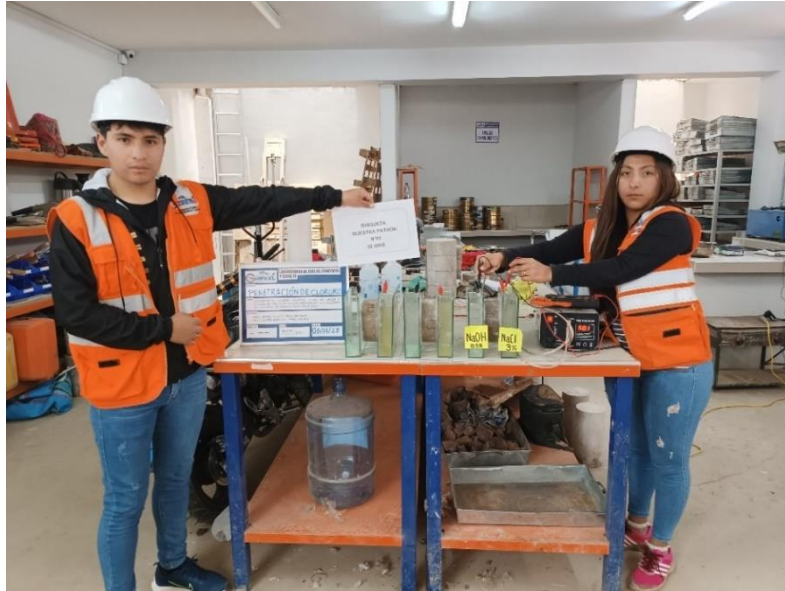
Figura 49. Ensayo de resistencia a la penetración de cloruros.
