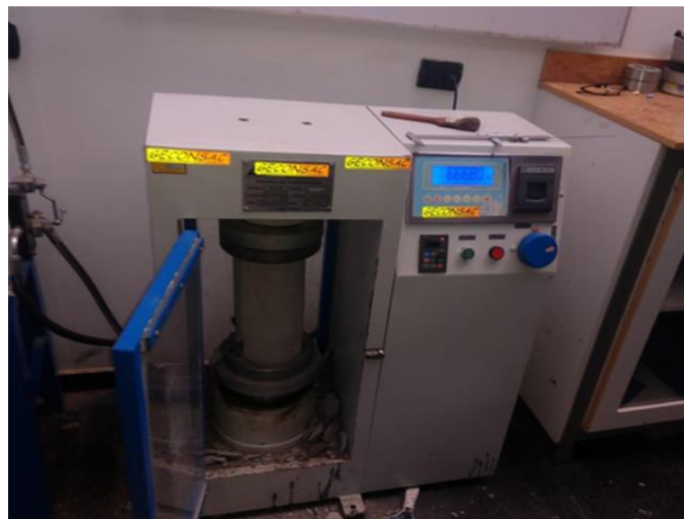
Figura 13. Ensayo de la Resistencia a la Compresión (Garate Labajos, 2018)
