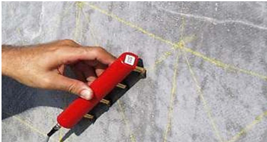
Figura 12. Equipo de medición de la resistividad eléctrica Ins-situ (González Sersen, 2011)
