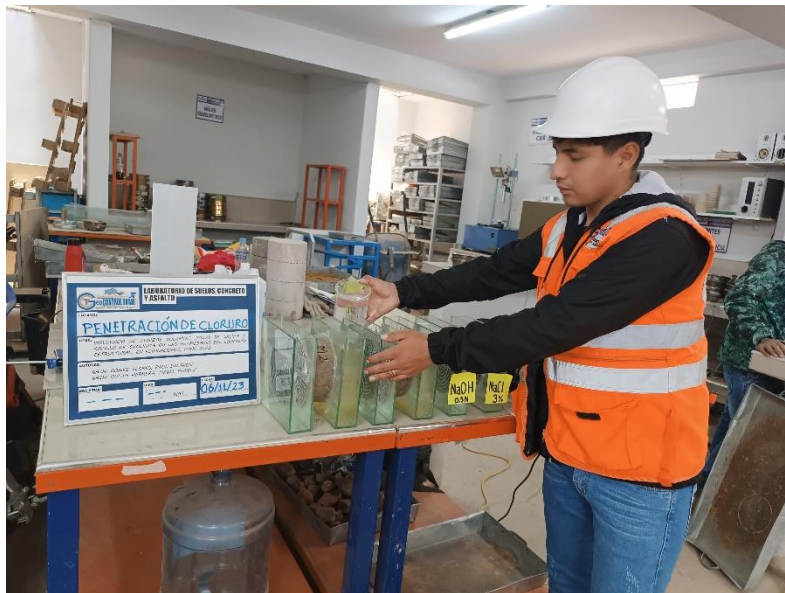
Figura 48. Armado de sistema y vaciado de soluciones.
