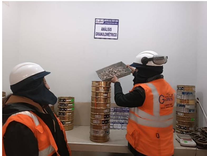
Figura 25. Ensayo de análisis granulométrico del agregado grueso por tamizado.
