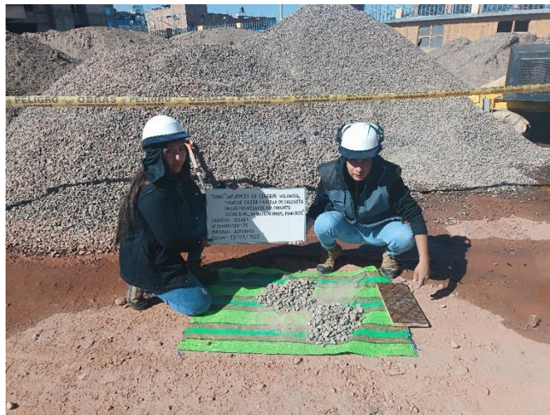
Figura 22. Cuarteo de la muestra de agregado grueso.
