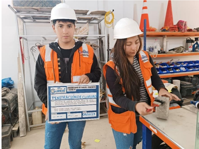
Figura 47. Recubrimiento e impermeabilización de la probeta.
