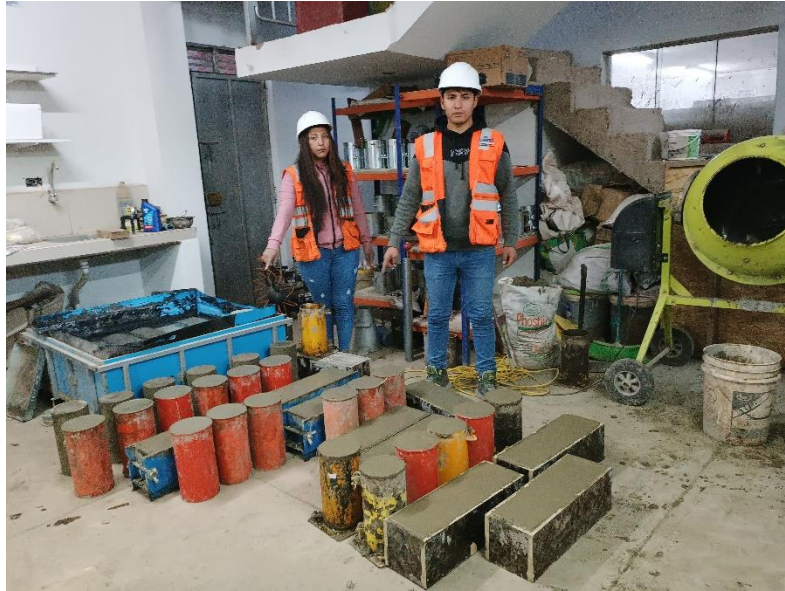
Figura 44. Elaboración de especímenes cilíndricos y prismáticos para su posterior curado.
