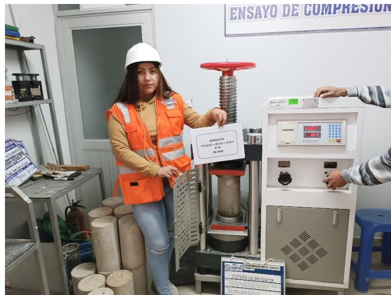
Figura 74. Ensayo de resistencia a la compresión.
