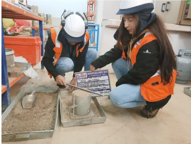
Figura 31. Ensayo de peso unitario suelto y compactado del agregado fino.
