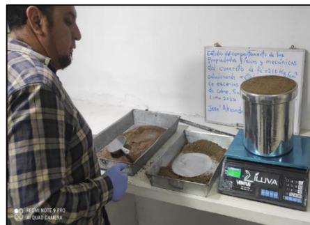
Figura 18. Peso del material suelto
