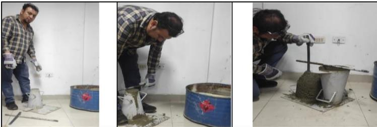
Figura 30. Elaboración, llenado del cono de Abrams y medida
