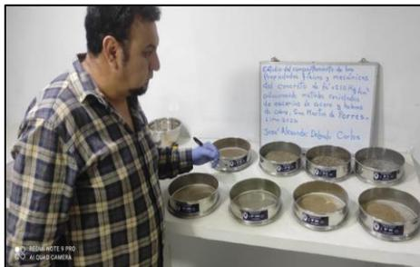
Figura 15. Colocación en los tamices
