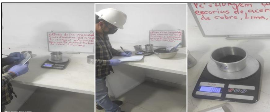
**Figura 25.** Cálculo del peso específico de las escorias de acero
