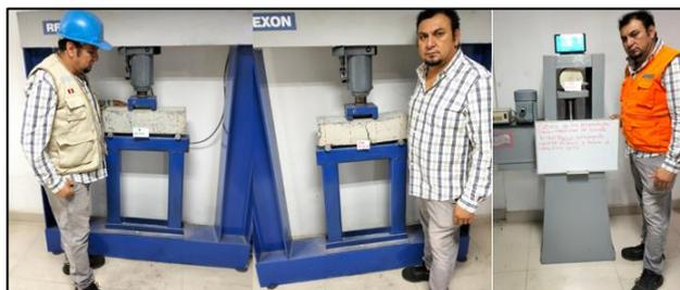
Figura 44. Resistencia a la flexión en 7; 14 y 28 días de curado.
