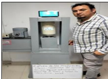
**Figura 40.** Resistencia a la compresión 14 días
