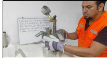
Figura 32. Llenado de la Olla Washington      Figura 33. Midiendo el contenido de Aire
