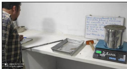
Figura 36. Pesado del concreto
