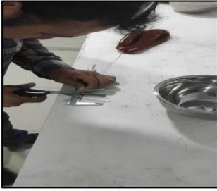
Figura 28. Medida de las hebras de cobre
