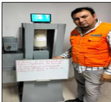
Figura 42. Resistencia a la compresión a los 28 días
