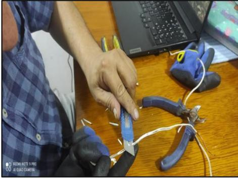
Figura 9. Pelado de los cables
