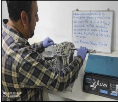
Figura 21. Llenado del agregado grueso suelto
