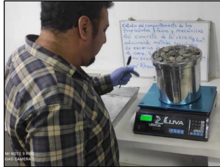
Figura 22. Peso del agregado grueso suelto
