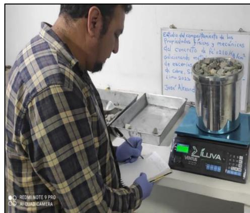
Figura 24. Peso del material compactado
