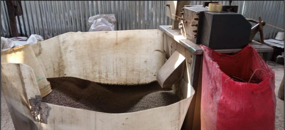
**Figura 11.** Triturado de material reciclado.
