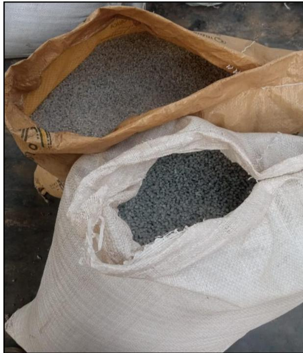
**Figura 12.** Polietileno de alta densidad (HDPE) reciclado.
