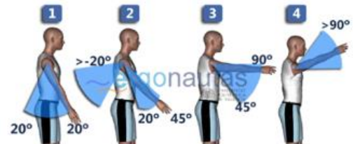
Figura 9: Medición del ángulo del brazo.
