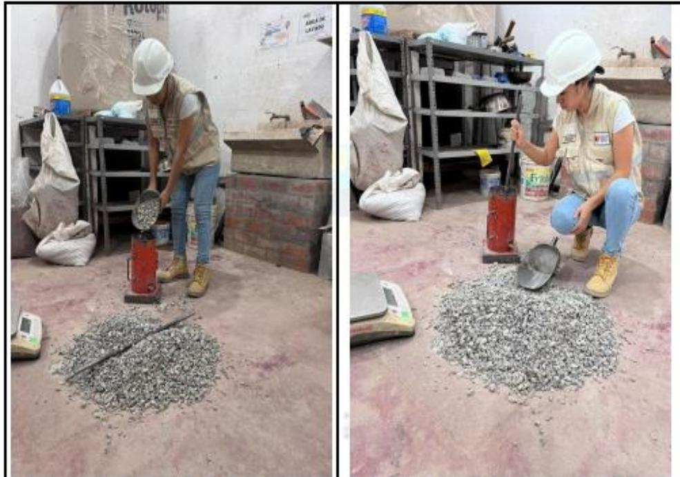
Fotos nº 09-10: En las imágenes podemos observar realización del ensayo de peso unitario de la grava.
