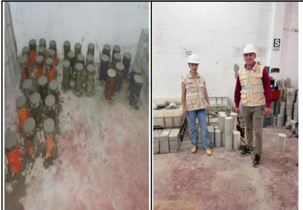
Fotos nº 21-22: En las imágenes podemos observar el moldeo de los testigos de concreto.
