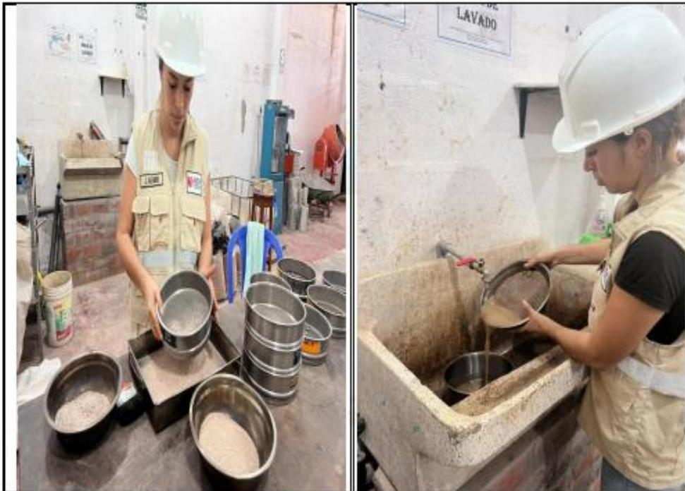
Fotos nº 05-06: En las imágenes se puede apreciar el ensayo de análisis granulométricos y lavado de agregado fino.
