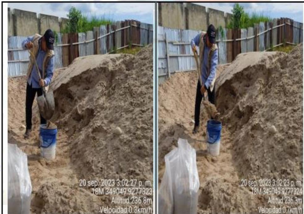
Fotos nº 03-04: En las imágenes se puede apreciar el muestreo de la arena zarandeada.
