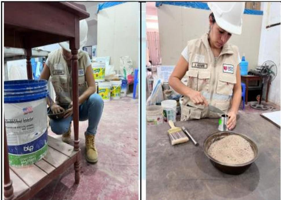
Fotos nº 07-08: En las imágenes podemos observar el ensayo de gravedad específica de los agregados.
