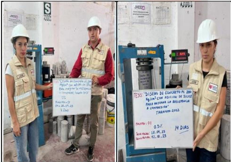
Fotos nº 23-24: En las imágenes podemos observar la resistencia a la compresión axial de los testigos de concreto
