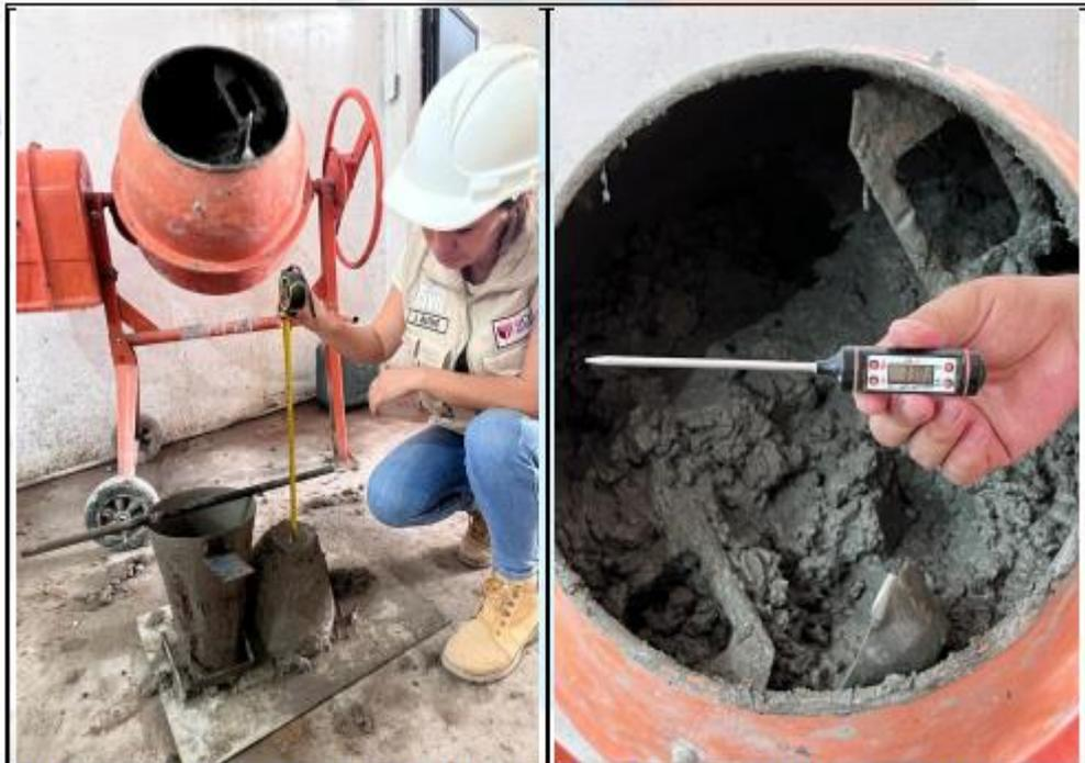
Fotos nº 19-20: En las imágenes podemos observar al personal realizando la prueba de asentamiento para los diseños de Mezclas.
