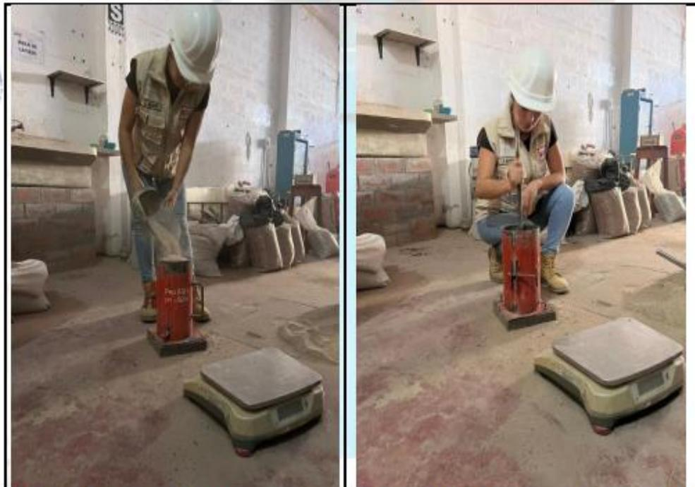
Fotos nº 11-12: En las imágenes podemos observar realización del ensayo de peso unitario de la arena zarandeada.
