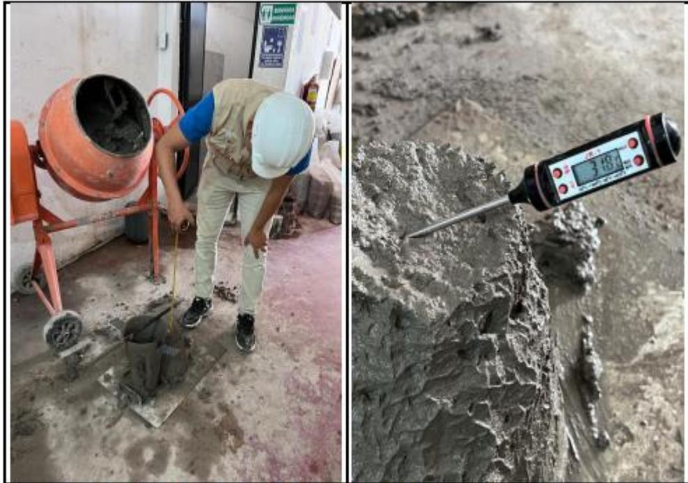
Fotos nº 17-18: En las imágenes podemos observar al personal realizando la prueba de asentamiento para los diseños de Mezclas.
