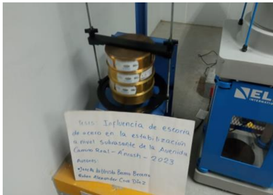
FIGURA N°23: Podemos observar las muestras retenidas en los 3 recipientes.
