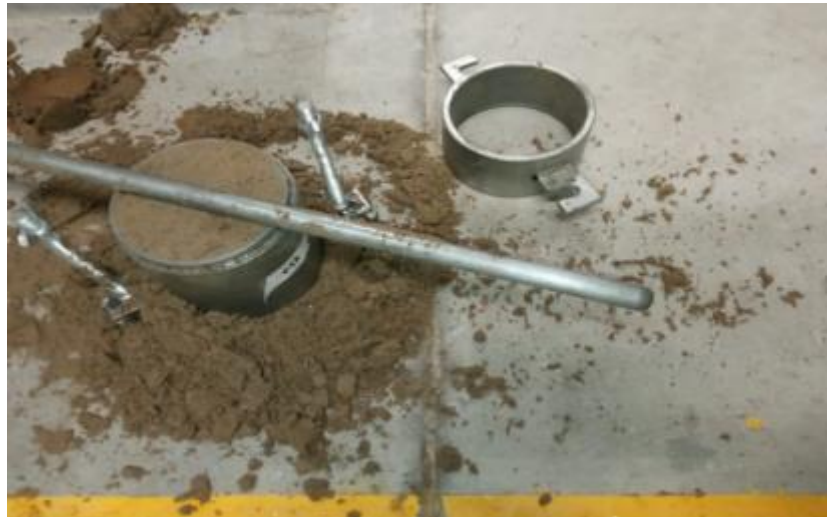
FIGURA N°77: Desarmado de molde.
