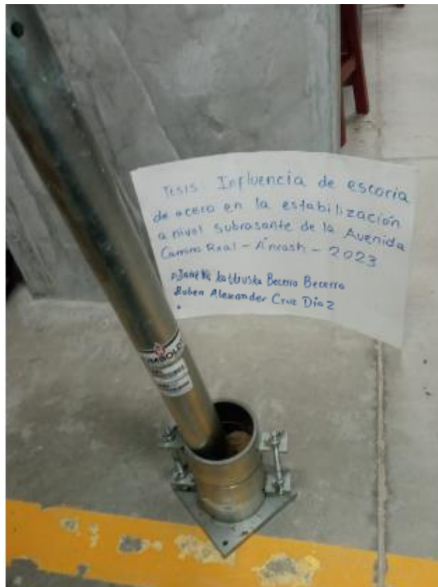
FIGURA N°71: Se compacta con el pisón.
