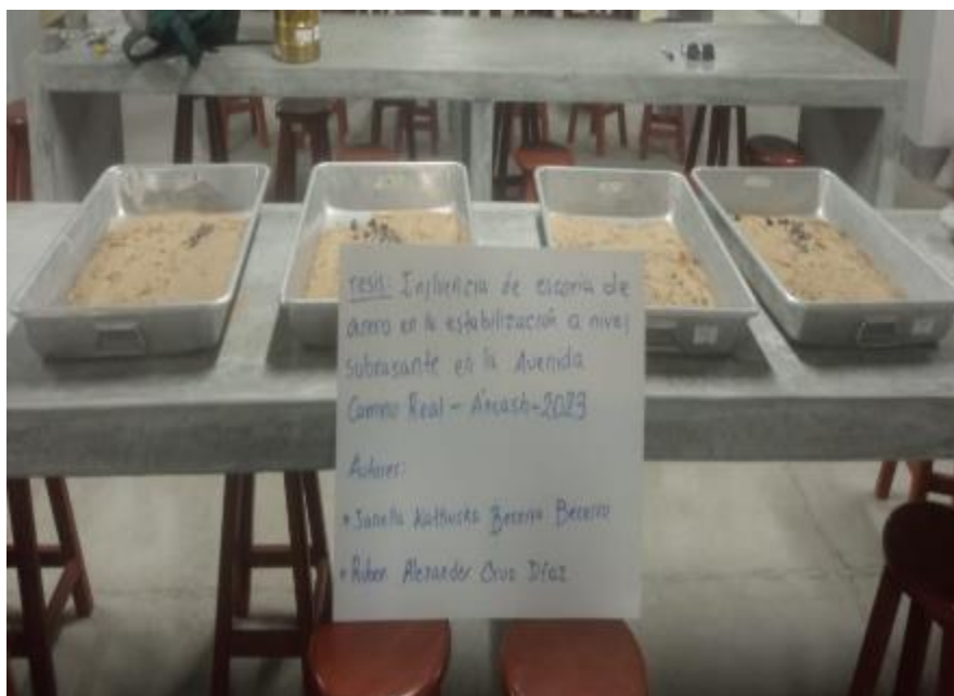
FIGURA N°51: Mezclamos las muestras con los porcentajes del 15% 20% y 25% escoria de acero.
