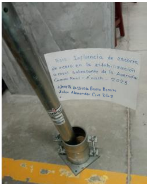
FIGURA N°76: Se compacta con el pisón.
