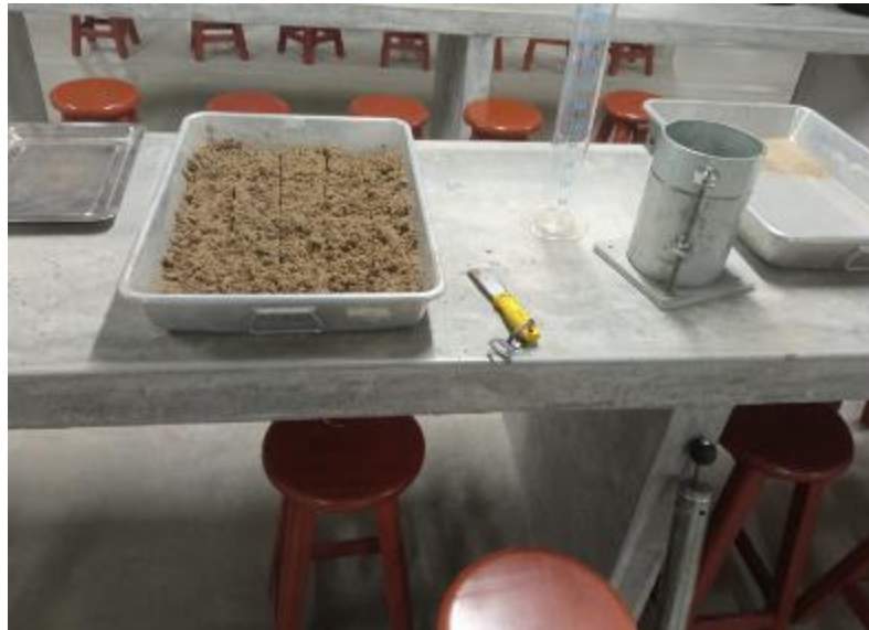
FIGURA N°75: Se divide la muestra en 5 capas.
