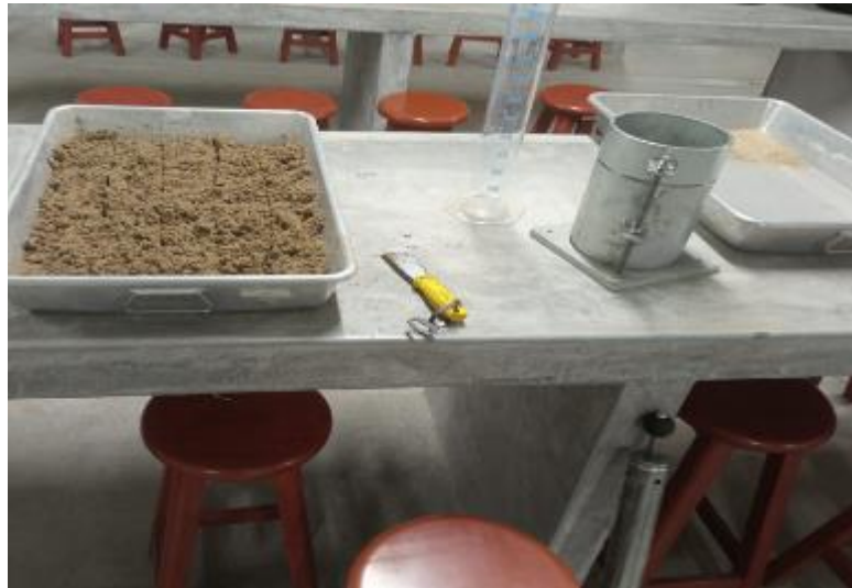
FIGURA N°68: Se divide la muestra en 5 capas
