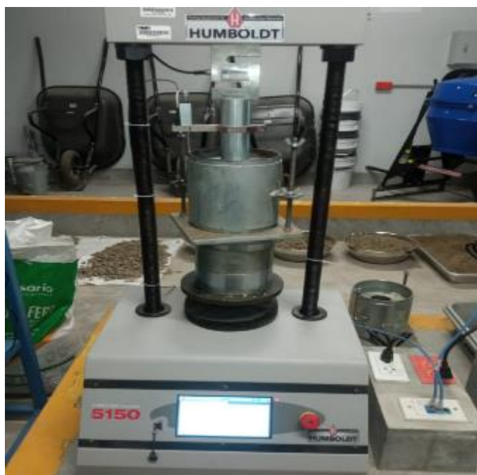
FIGURA N°78: Muestra lista para compactar.
