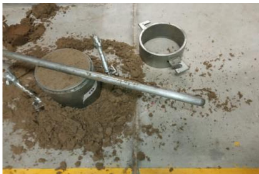
FIGURA N°36: Quitamos el collarín del molde y enrasamos
