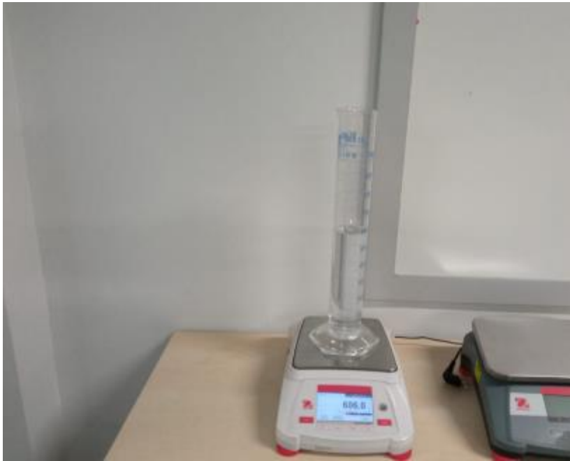
FIGURA N°70: Pesado de agua a integrar en la muestra.
