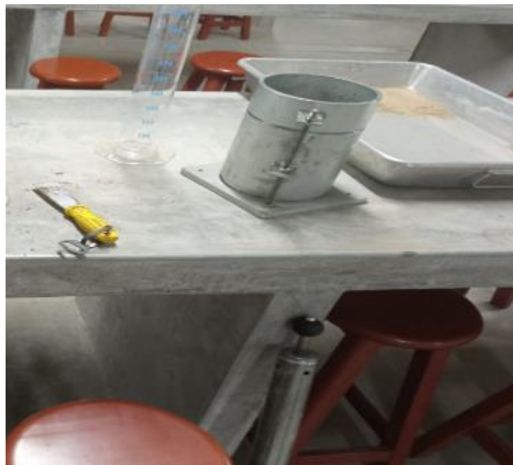
FIGURA N°69: Armado de molde para CBR
