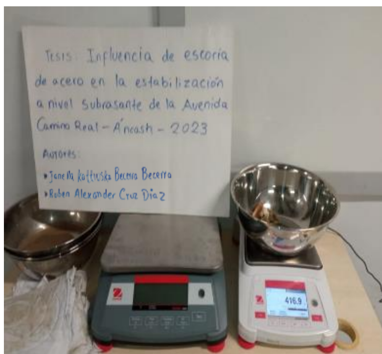
FIGURA N°26: Peso retenido en la malla 3/8
