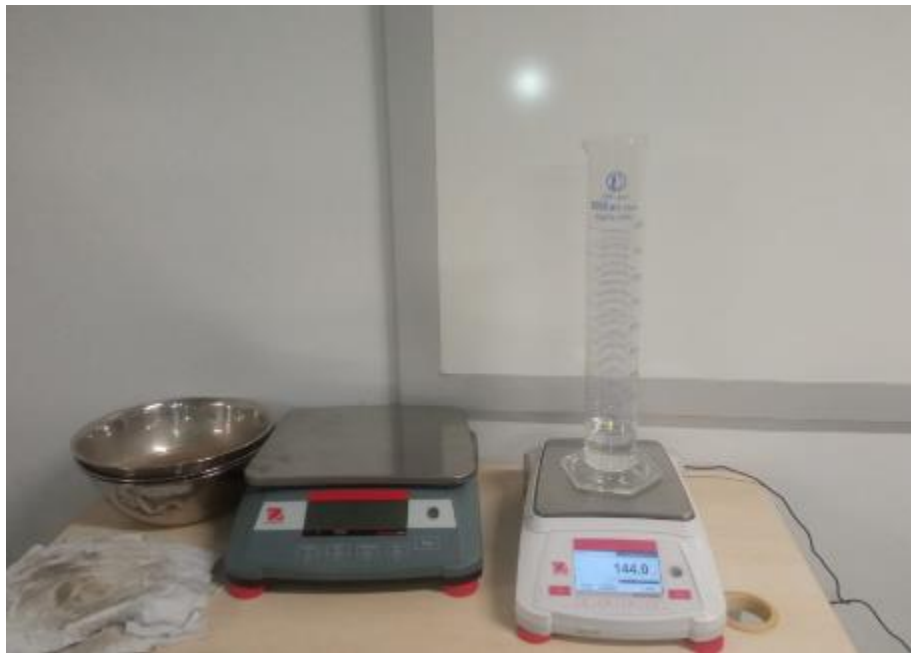
FIGURA N°56: Los 241.5 ml, 252 ml y 262.5 ml de agua para el 15% 20% y 25 de adición de escoria.
