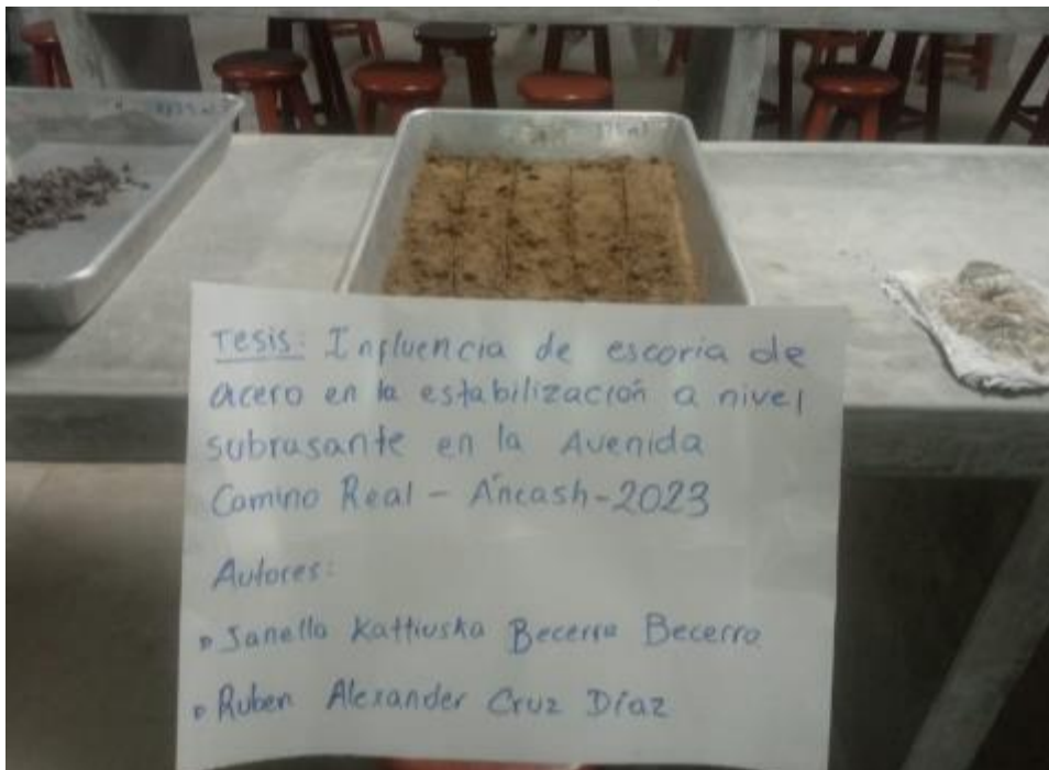
FIGURA N°60: Bandeja 3 del 15%, 20% y 25% con 345 ml, 360 ml y 375 ml de agua.
