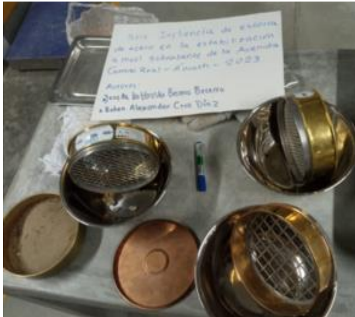
FIGURA N°22: Realizamos lo que se describe en el procedimiento, es decir el proceso de tamizado por las mallas indicadas.
