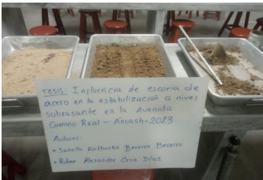
FIGURA N°61: Bandeja 4 del 15%, 20% y 25% con 448.5 ml, 468ml y 487.5 ml de agua.
