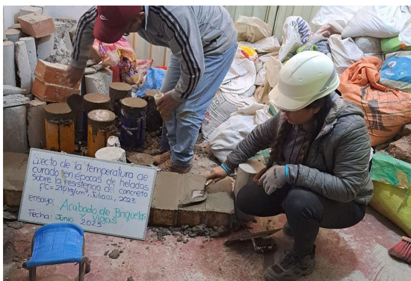
Figura 13: Toma de muestras de viga.
