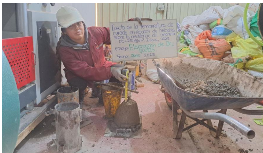
Figura 11: Medición del asentamiento.
