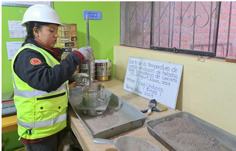
Figura 9: Peso Unitario norma MTC E 203.
