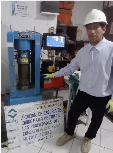
Figura 18. Ensayo de resistencia a compresión
