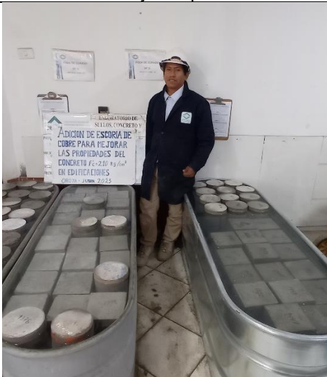
Foto 9: Curado de especímenes
