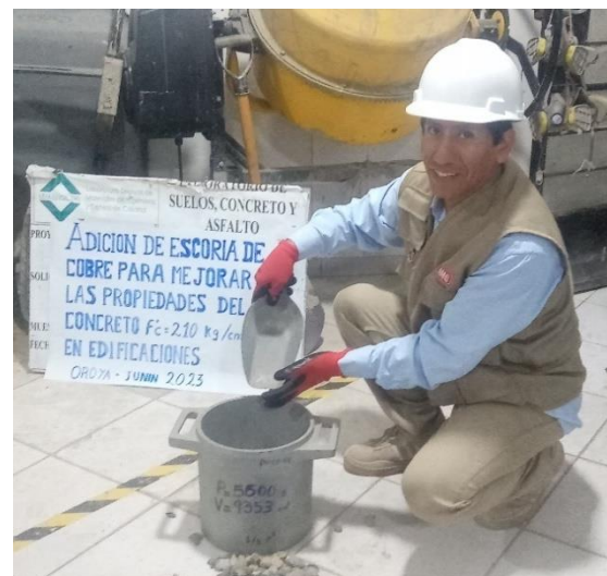
Foto 6: Ensayo de peso unitario
