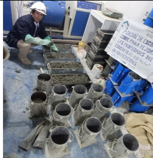
Foto 8: Elaboración de vigas y probetas
