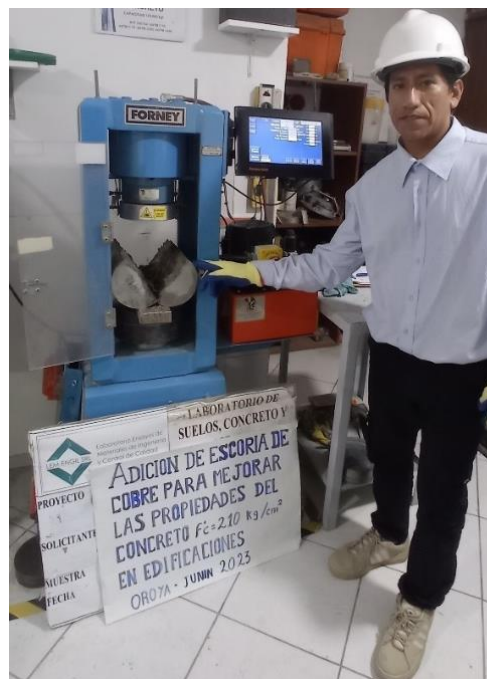
Figura 37. Rotura del espécimen
