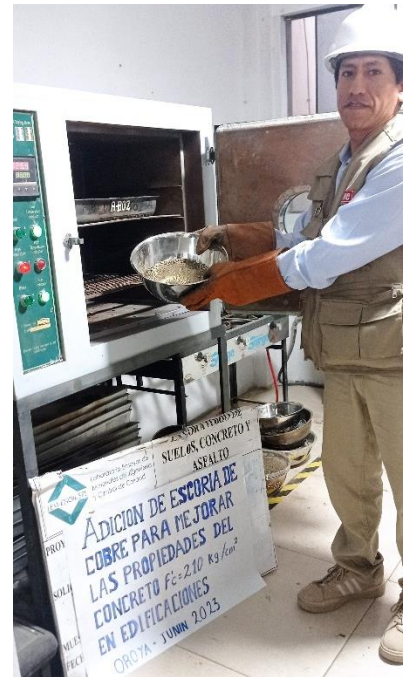
Figura 6 Secado del agregado
