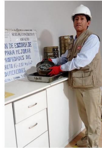
Figura 9. Tamizado de los agregados
