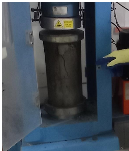
Figura 26. Rotura del espécimen
