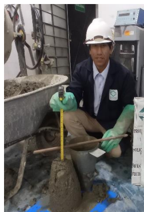
Figura 15. Slump de la mezcla
