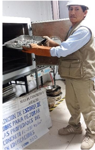
Figura 8. Secado del agregado
