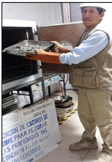
Foto 5: Secado del agregado grueso
