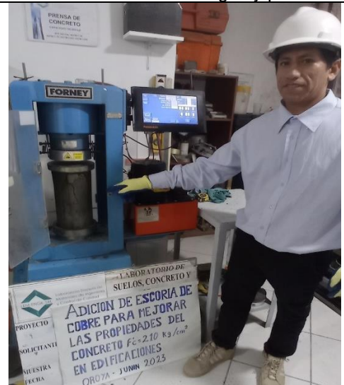
Foto 10: Ensayo de compresión
