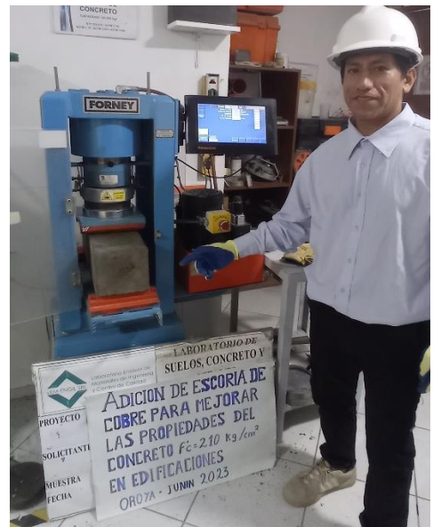
Foto 6: Ensayo de flexión
