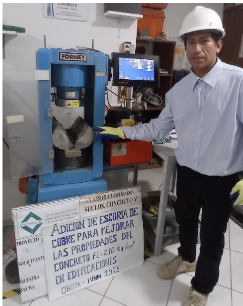
Foto 5: Ensayo de tracción
