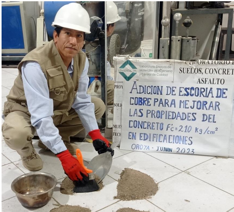
Figura 5. Cuarteo del agregado
