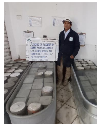
Figura 16. Curado de las probetas
