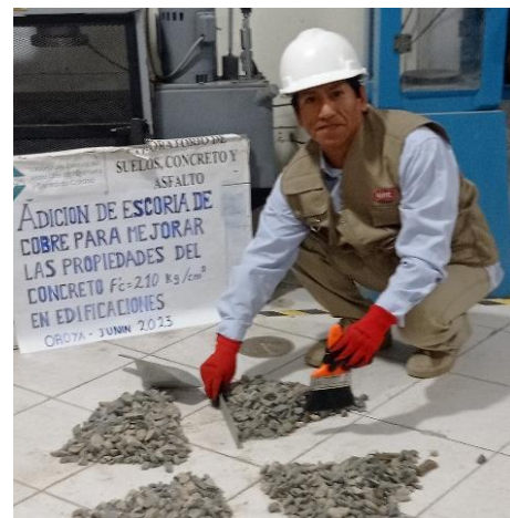
Foto 4: Cuarteo del agregado grueso
