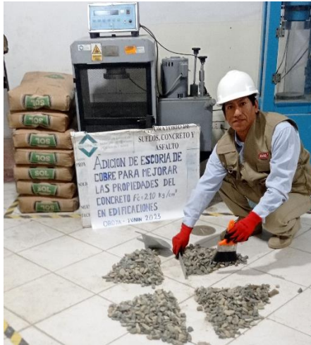
Figura 7. Cuarteo del agregado
