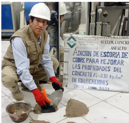
Foto 3: Cuarteo del agregado fino
