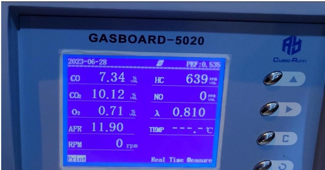
Figura 6: Analizador de gases Gasboard – 5020
