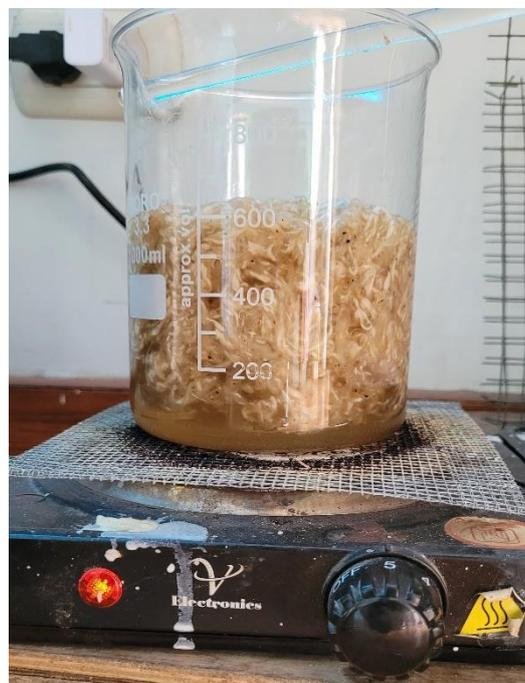
Figura 13: Tratamiento de deslignificación
