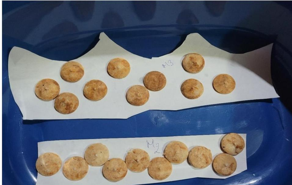
Figura 16: Moldes comprimidos de membranas de nanocelulosa de algodón con nanopartículas de hierro.
