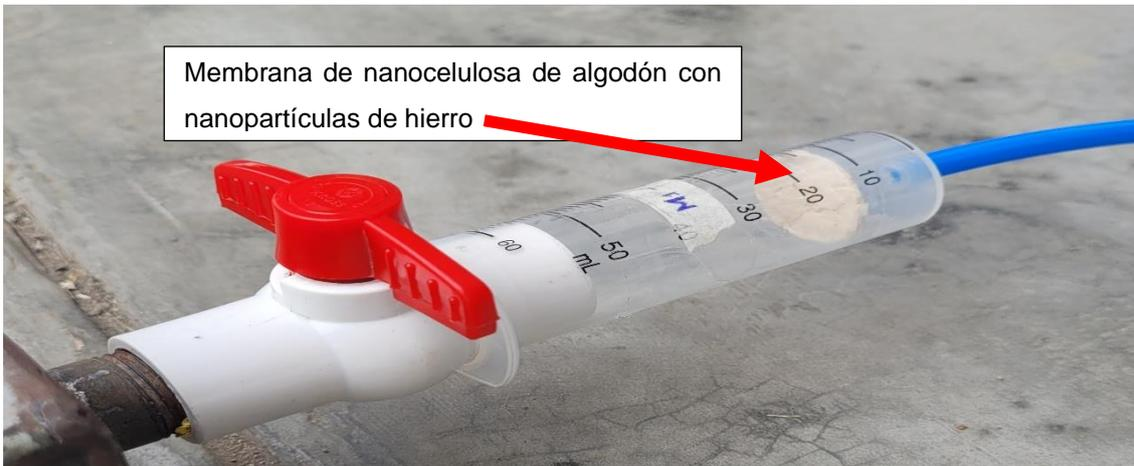
Figura 10: Jeringa con la membrana de nanocelulosa de algodón con nanopartículas de hierro
