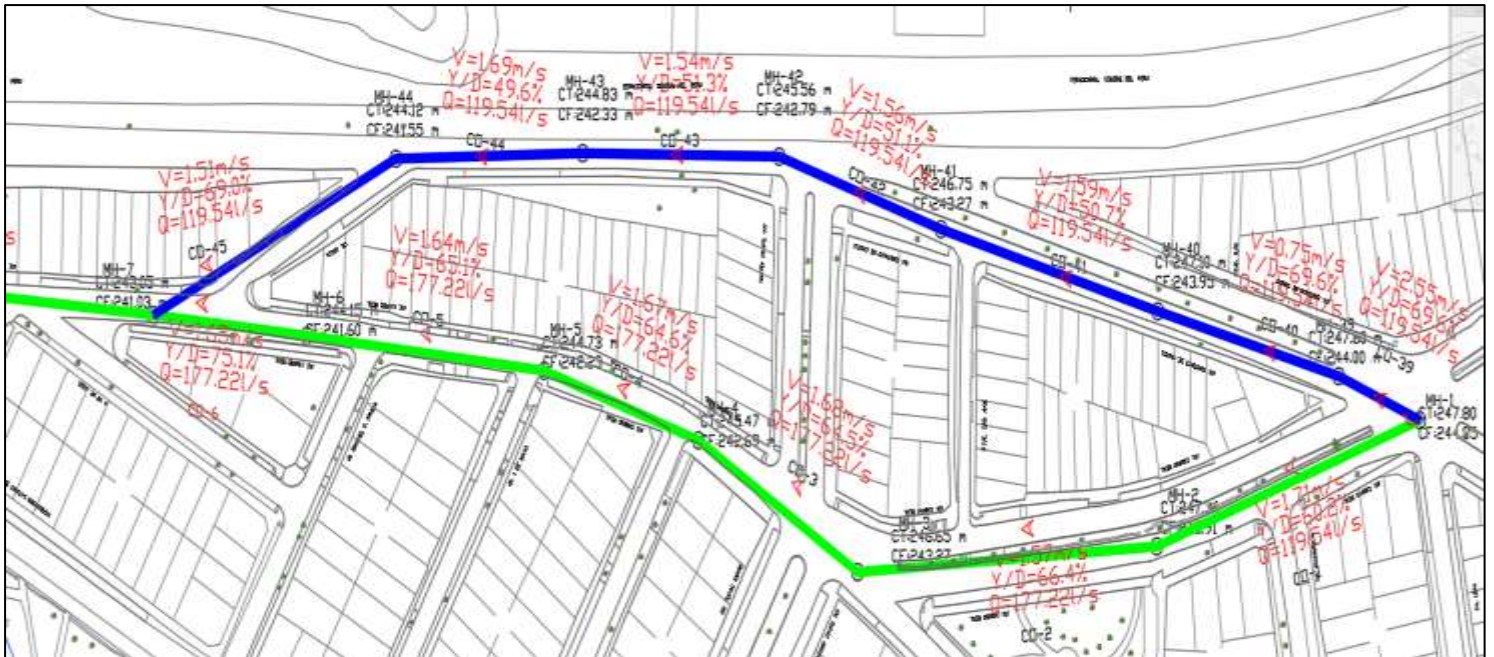
Figura 15: Plano de la implementación de tuberías en paralelo en el colector que comprende Av. Camino Real (calles Santiago de Chuco y Arica) – El Agustino
