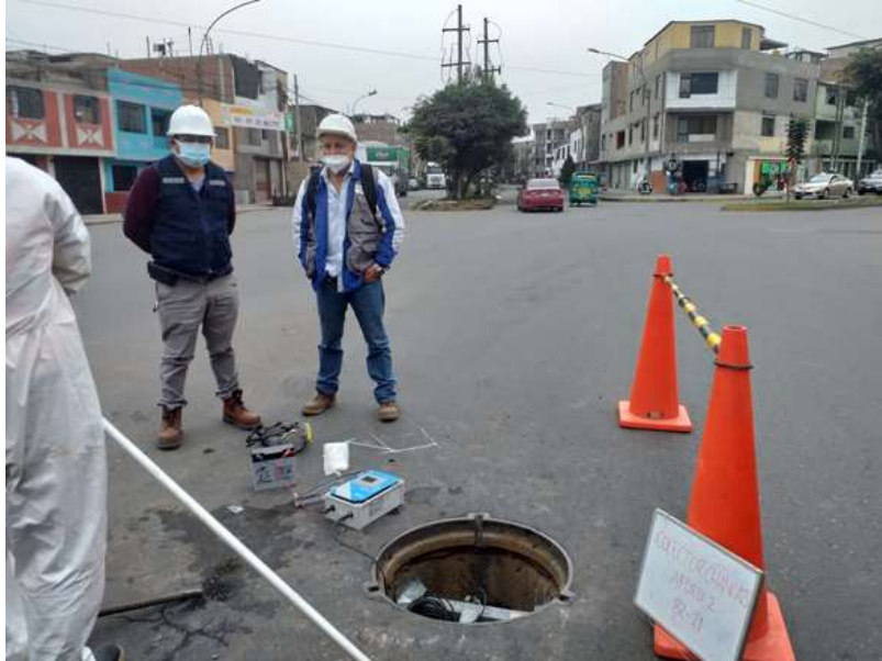
Imagen 09: Aforo 01, buzón seleccionado se ubica en el cruce de Av. Camino Real y Av. Paseo Central.
