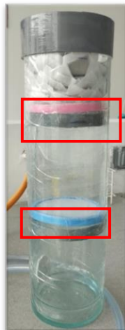
Figura 7. Localización de las mallas del filtro
