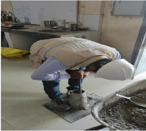
Ilustración 13. Proceso de la prueba de Slump
