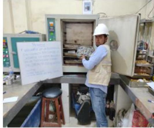
Ilustración 8. Proceso de secado de los agregados
