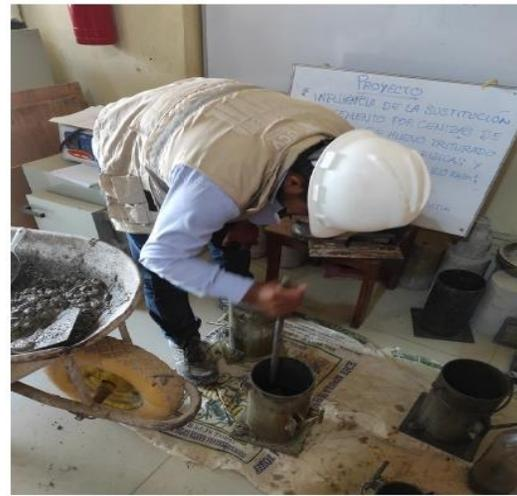
Ilustración 16. Vaciado y compactación de probetas concreto patrón 0%
