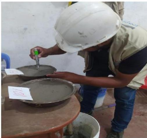
Ilustración 23. Medición del tiempo de fraguado
