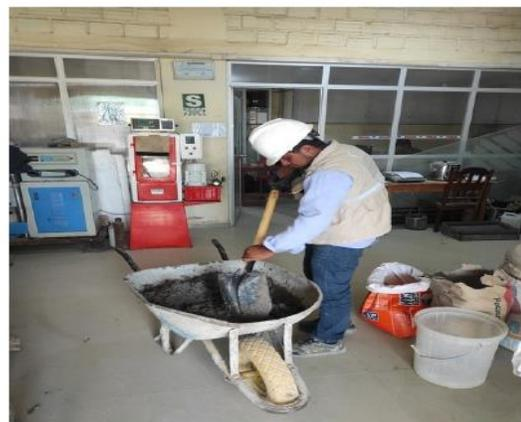
Ilustración 12. Mezcla homogénea de los componentes
