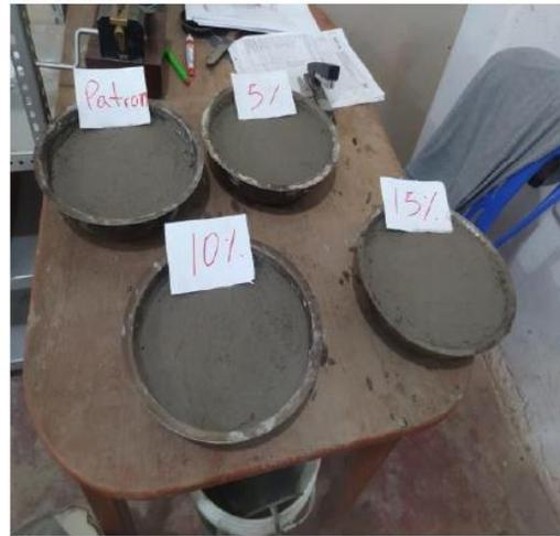
Ilustración 22. Muestras para el tiempo del fraguado
