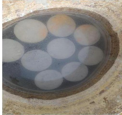
Ilustración 20. Proceso de curado de probetas cilíndricas
