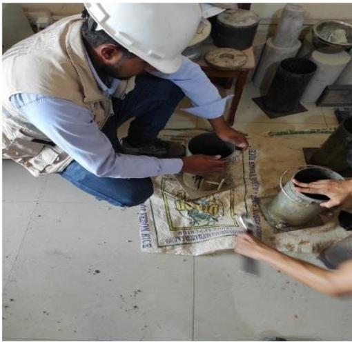
Ilustración 15. Acondicionamiento de moldes 15x30 cm para ensayo de resistencia a la compresión
