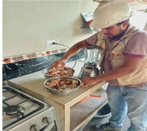
Ilustración 2. Proceso de trituración del cascón del huevo
