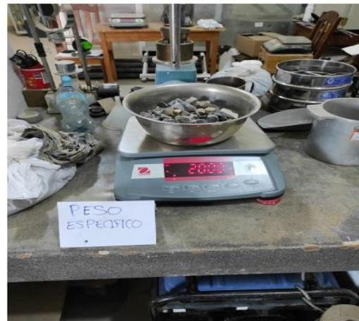
Ilustración 10. Peso específico
