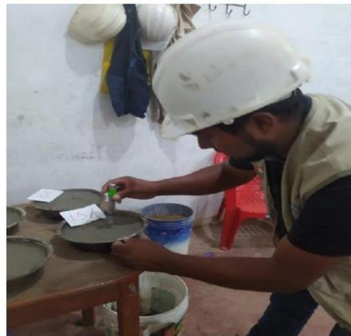
Ilustración 24. Medición del tiempo de fraguado.
