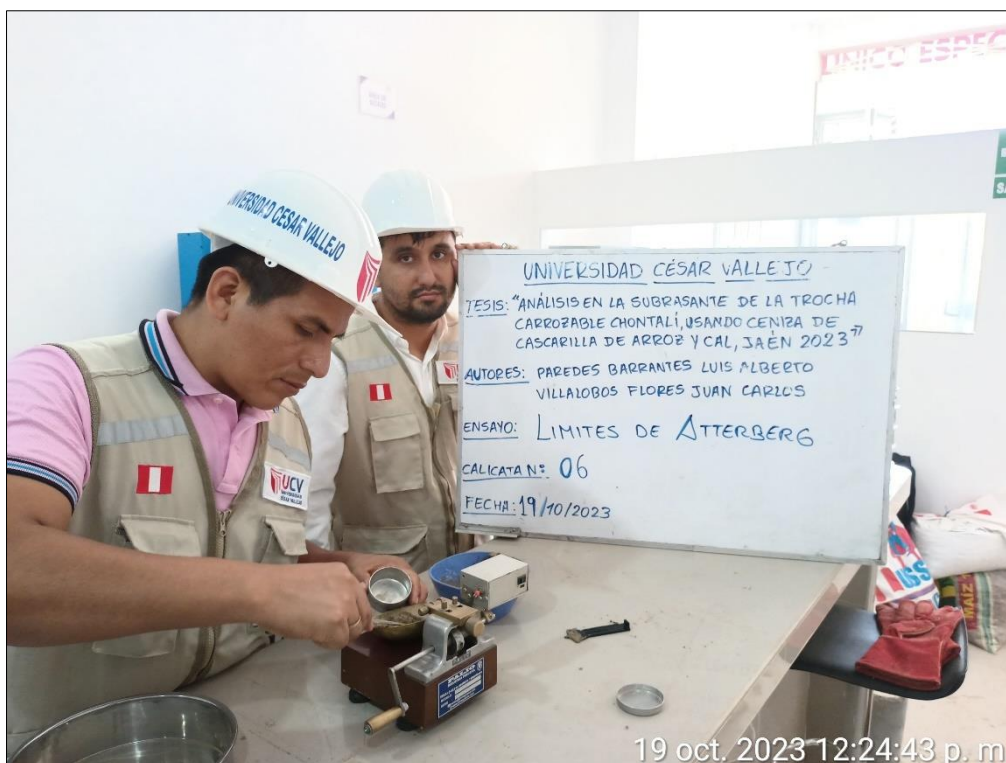
Figura 42. Muestra para Límite Líquido calicata N° 06
