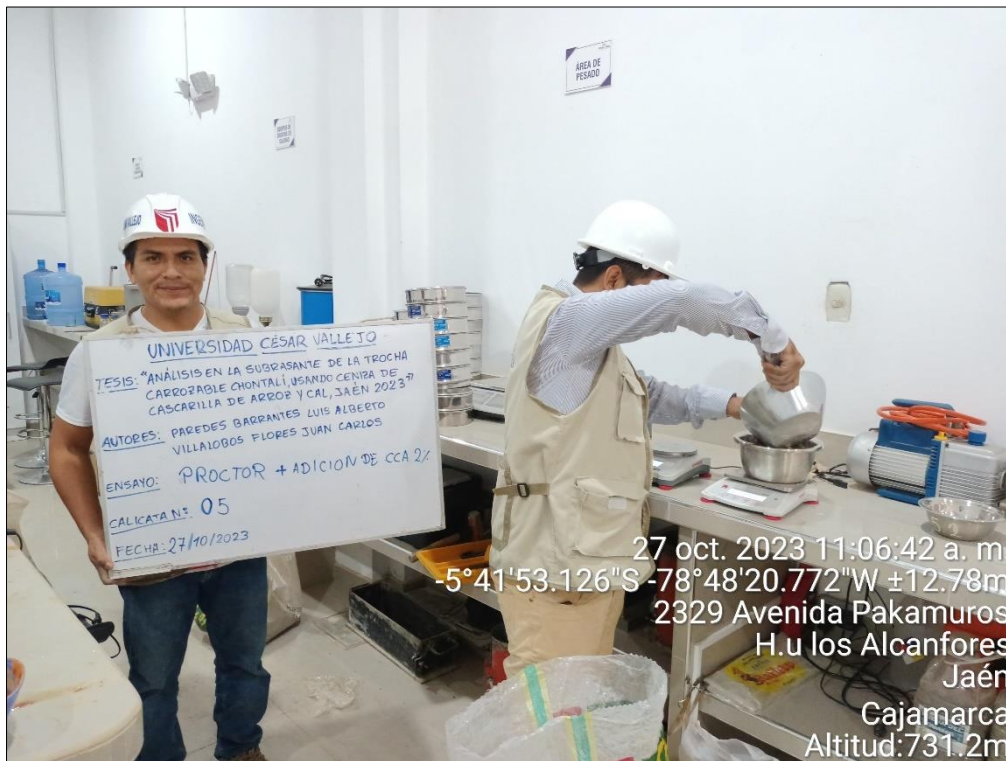
Figura 50. Ensayo de Proctor con adición de CAL al 3%
