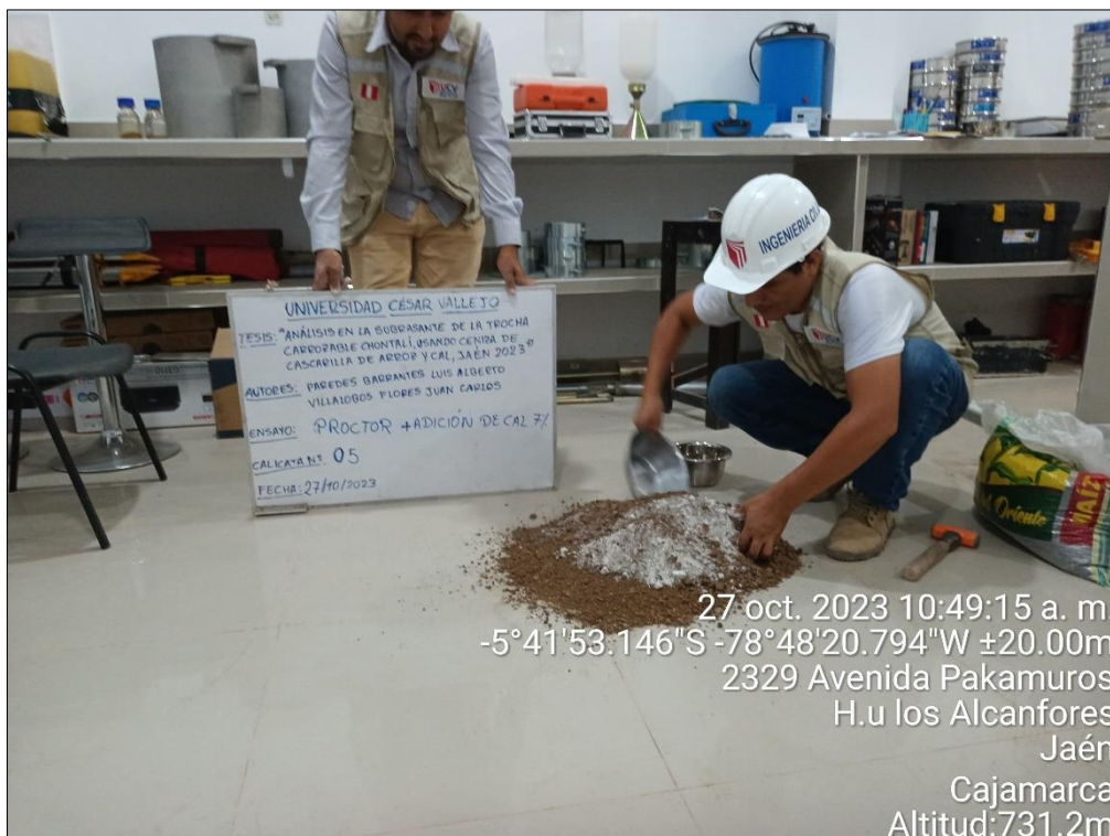
Figura 54. Ensayo de Proctor con adición de CAL al 7%
