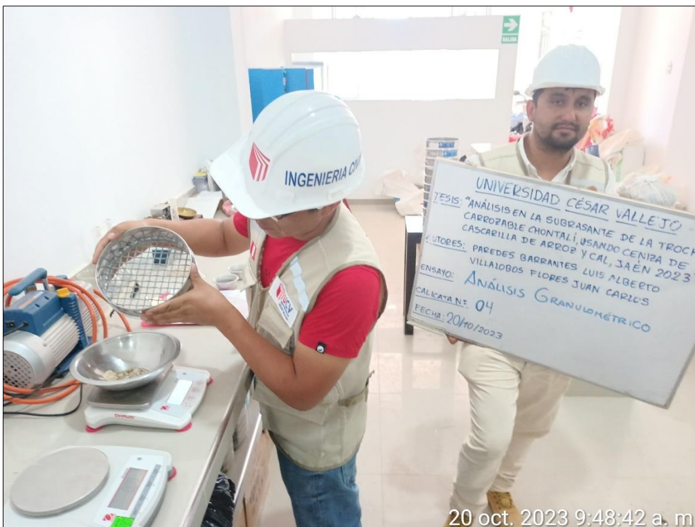
Figura 34. Pesado de la muestra para Análisis Granulométrico de la calicata N° 04
