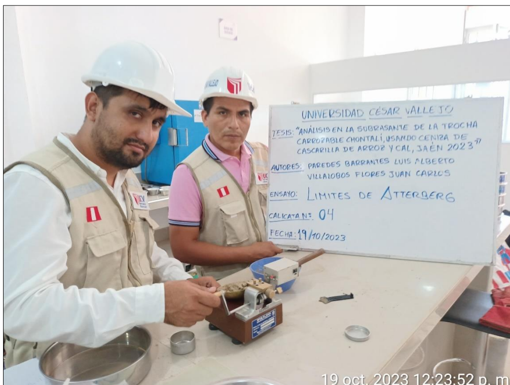
Figura 40. Muestra para Límite Líquido calicata N° 04
