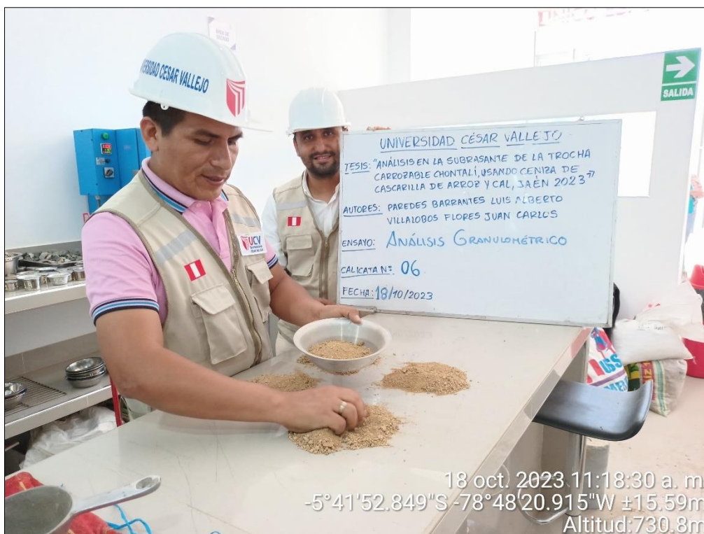
Figura 36. Cuarteo de la muestra para Análisis Granulométrico calicata N° 06
