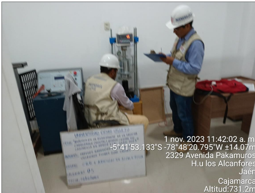
Figura 58. Ensayo de CBR con adición de 5% CAL+4% CCA
