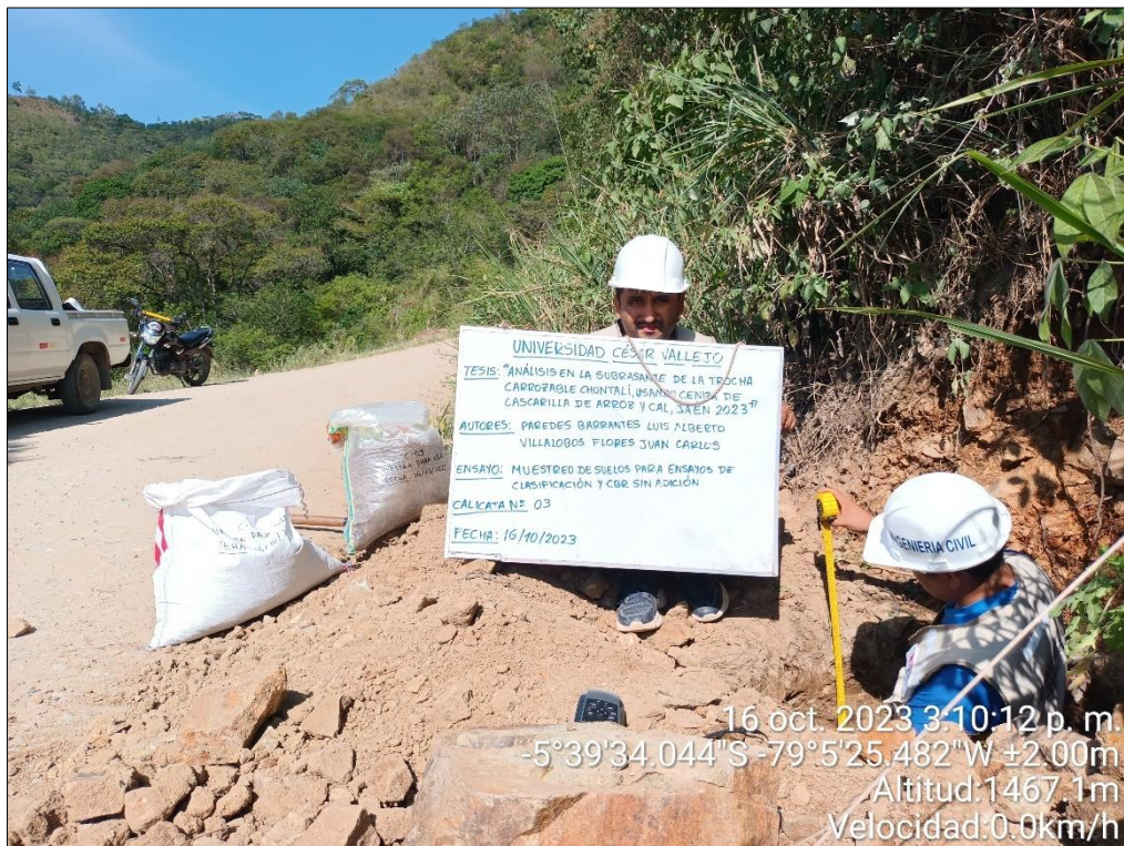
Figura 22. Muestreo para CBR de la calicata N° 04
