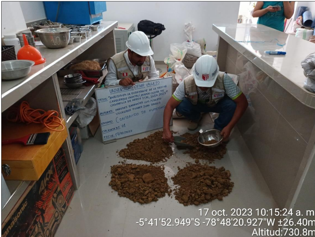
Figura 26. Pesado de la muestra de la calicata N° 02
