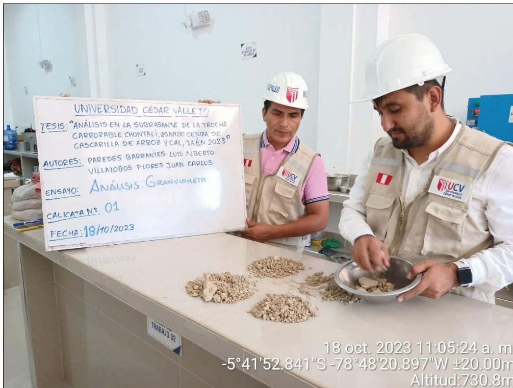
Figura 32. Pesado de la muestra para Análisis Granulométrico de la calicata N° 02
