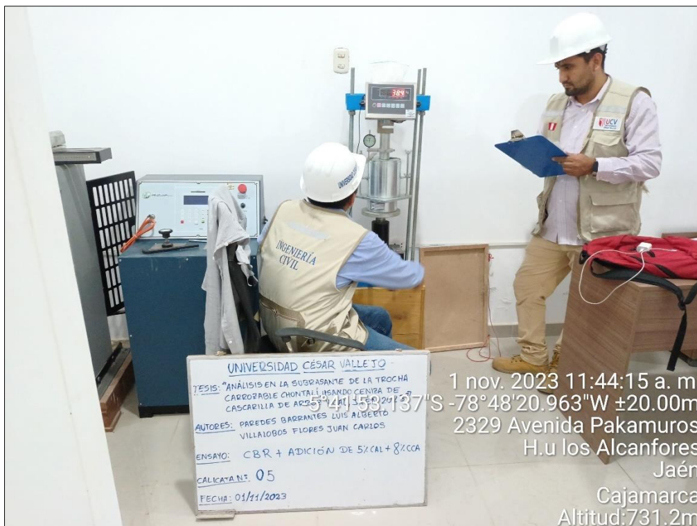
Figura 60. Ensayo de CBR con adición de 5% CAL+8% CCA
