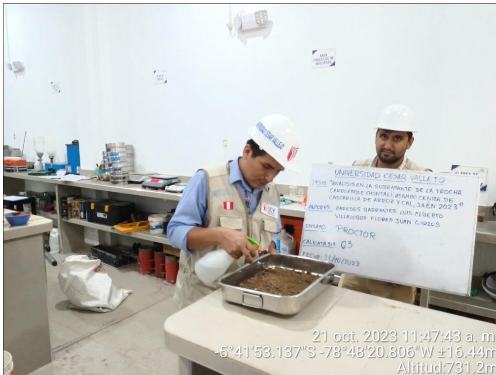
Figura 46. Pesado de la muestra para ensayo de Proctor, calicata N° 04
