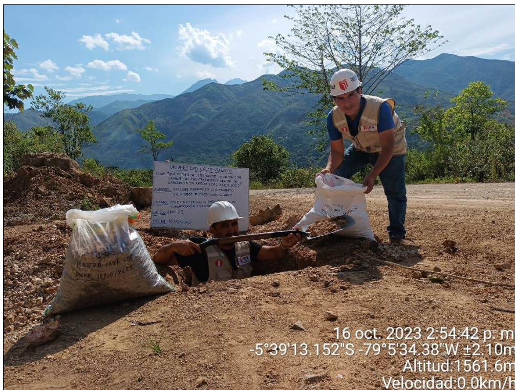
Figura 20. Muestreo para clasificación de la calicata N° 02
