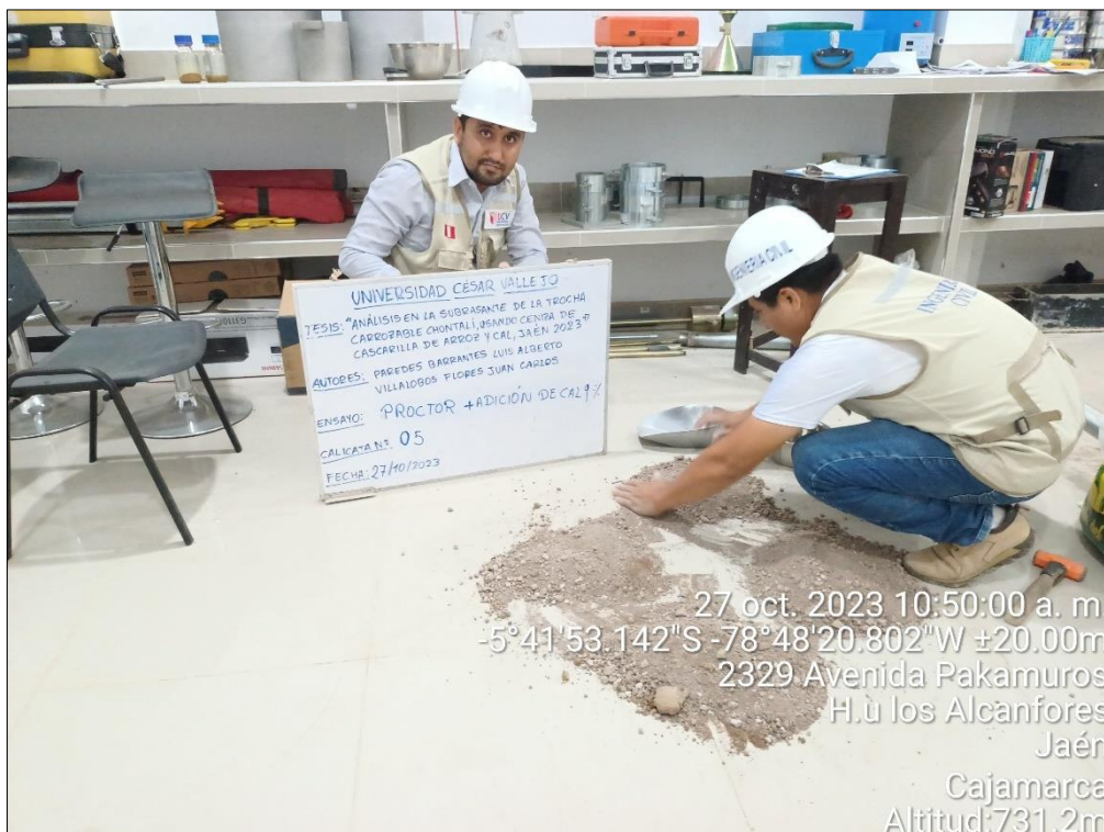
Figura 56. Ensayo de Proctor con adición de CAL al 9%
