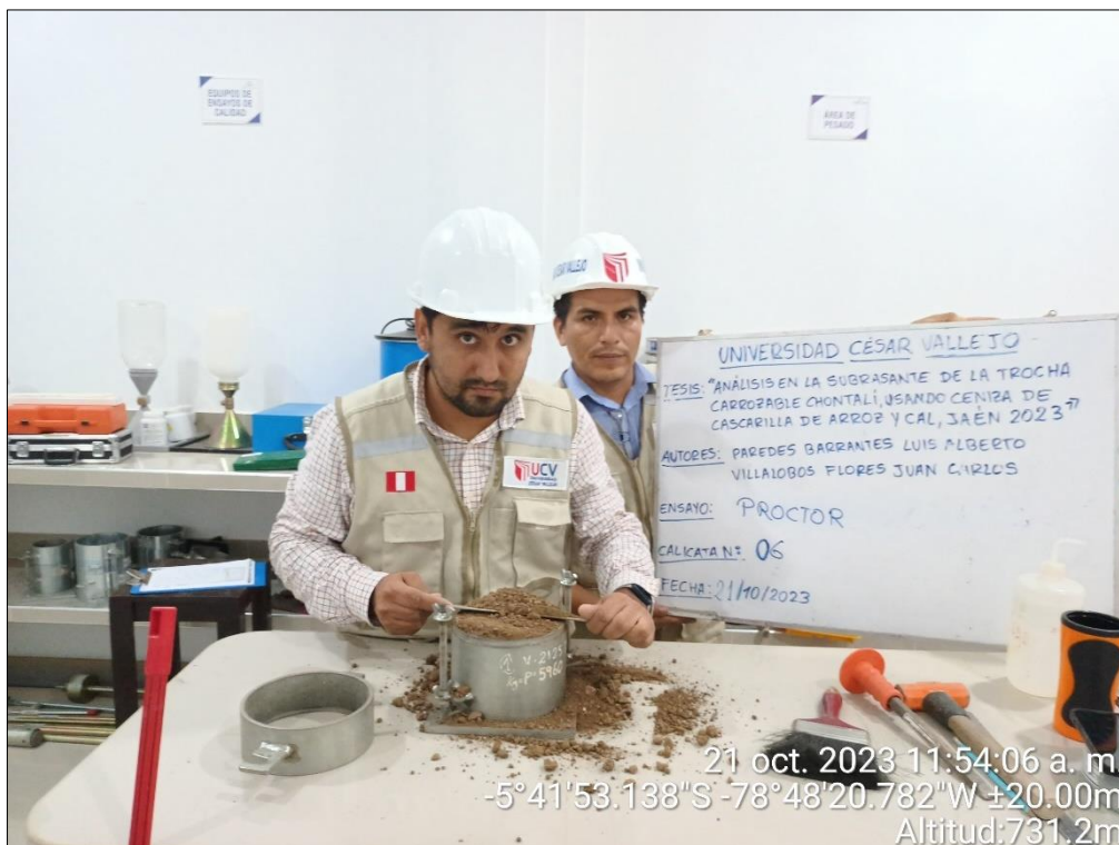
Figura 48. Rasar la muestra para ensayo de Proctor, calicata N° 06
