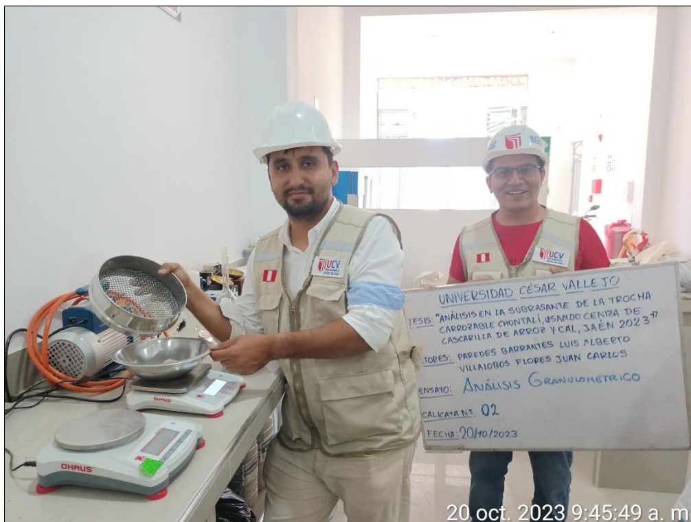
Figura 32. Pesado de la muestra para Análisis Granulométrico de la calicata N° 02
