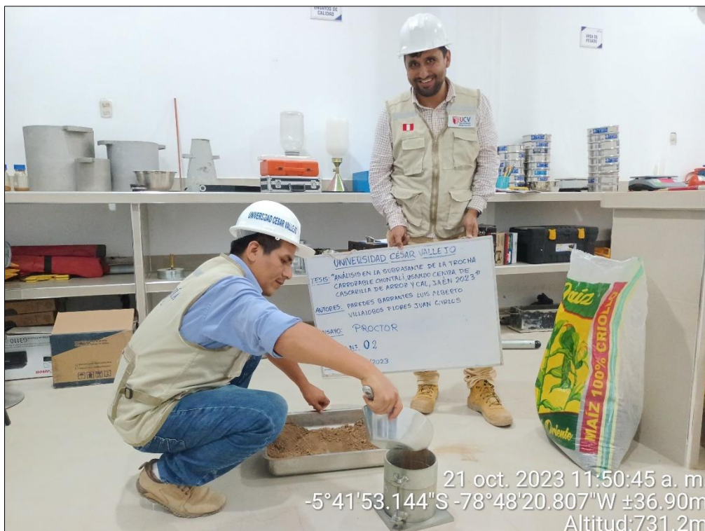
Figura 44. Colocar la muestra al molde, calicata N° 02
