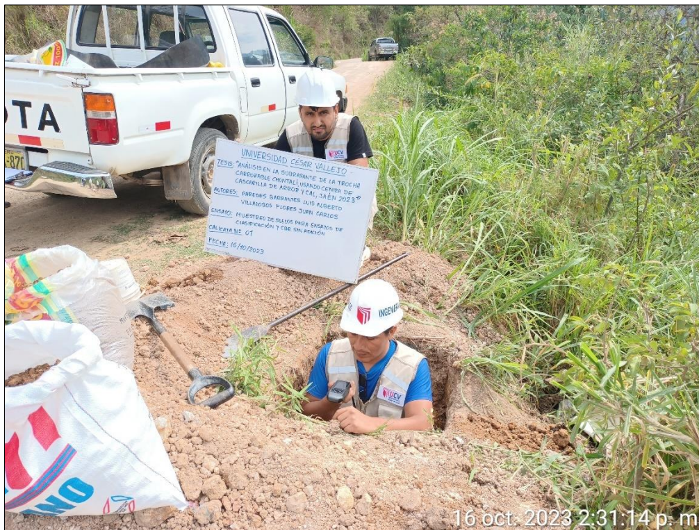
Figura 20. Muestreo para clasificación de la calicata N° 02
