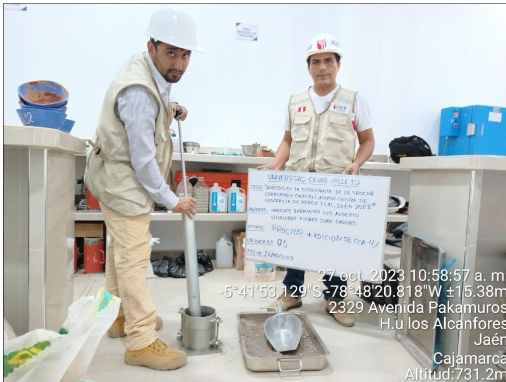
Figura 52. Ensayo de Proctor con adición de CAL al 5%
