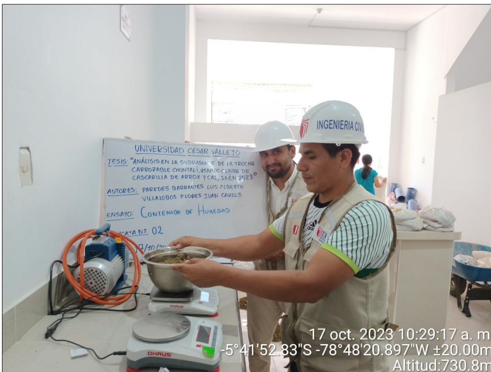
Figura 26. Pesado de la muestra de la calicata N° 02
