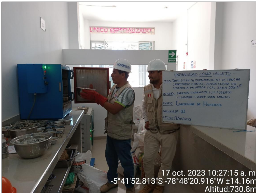
Figura 28. Secado de la muestra en el horno de la calicata N° 04
