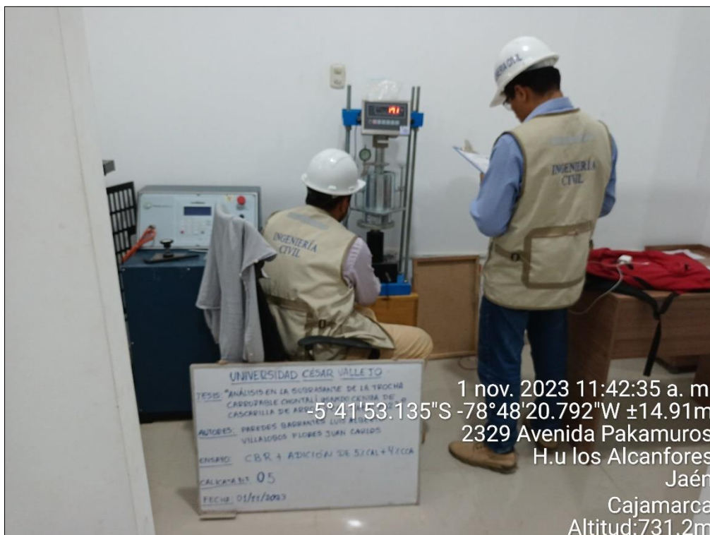
Figura 58. Ensayo de CBR con adición de 5% CAL+4% CCA
