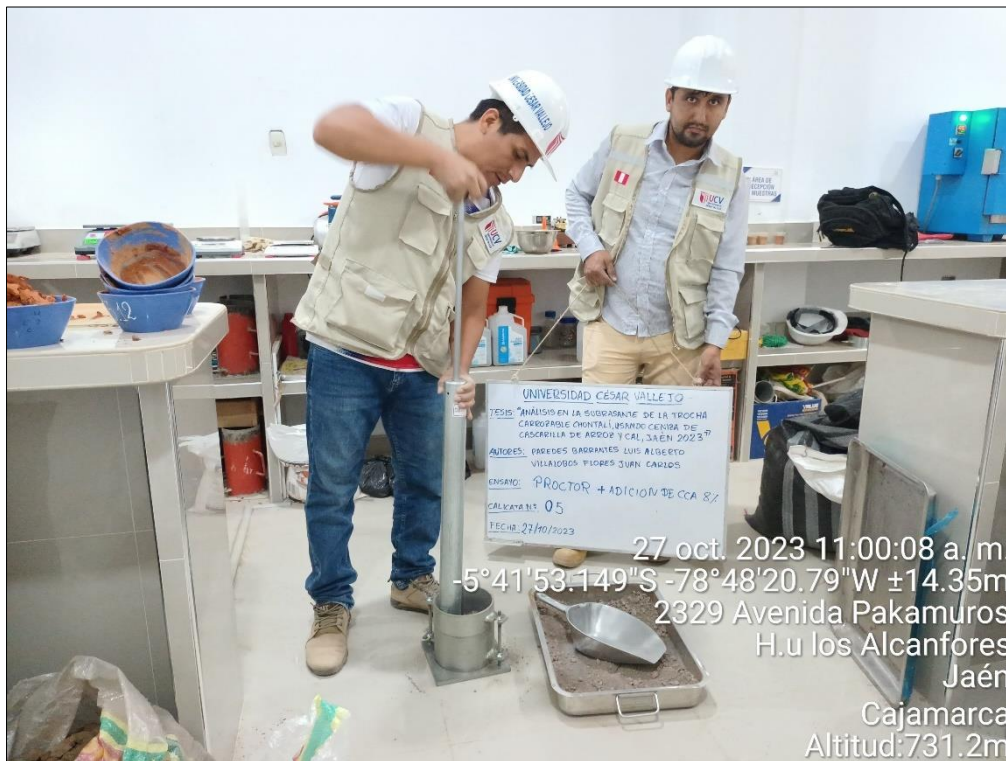
Figura 56. Ensayo de Proctor con adición de CAL al 9%
