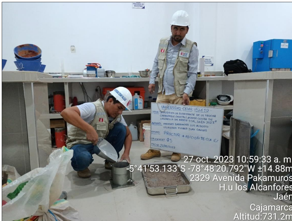
Figura 54. Ensayo de Proctor con adición de CAL al 7%
