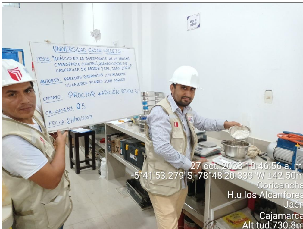
Figura 50. Ensayo de Proctor con adición de CAL al 3%
