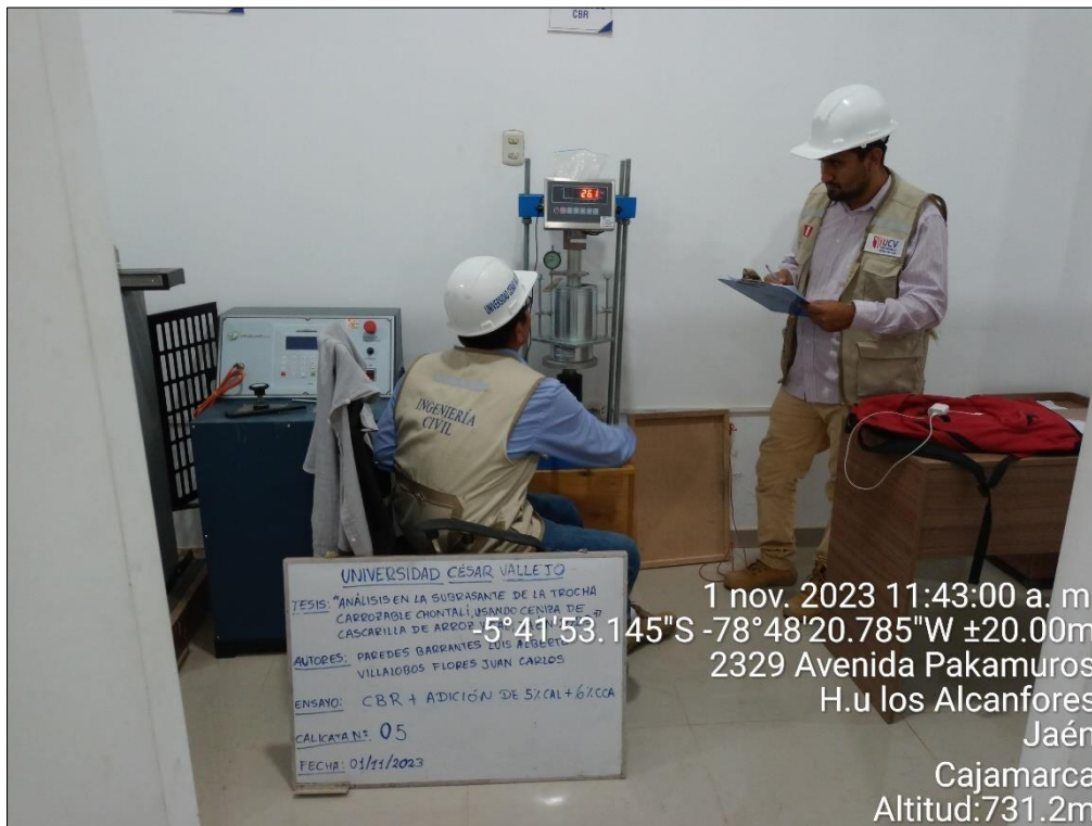
Figura 60. Ensayo de CBR con adición de 5% CAL+8% CCA
