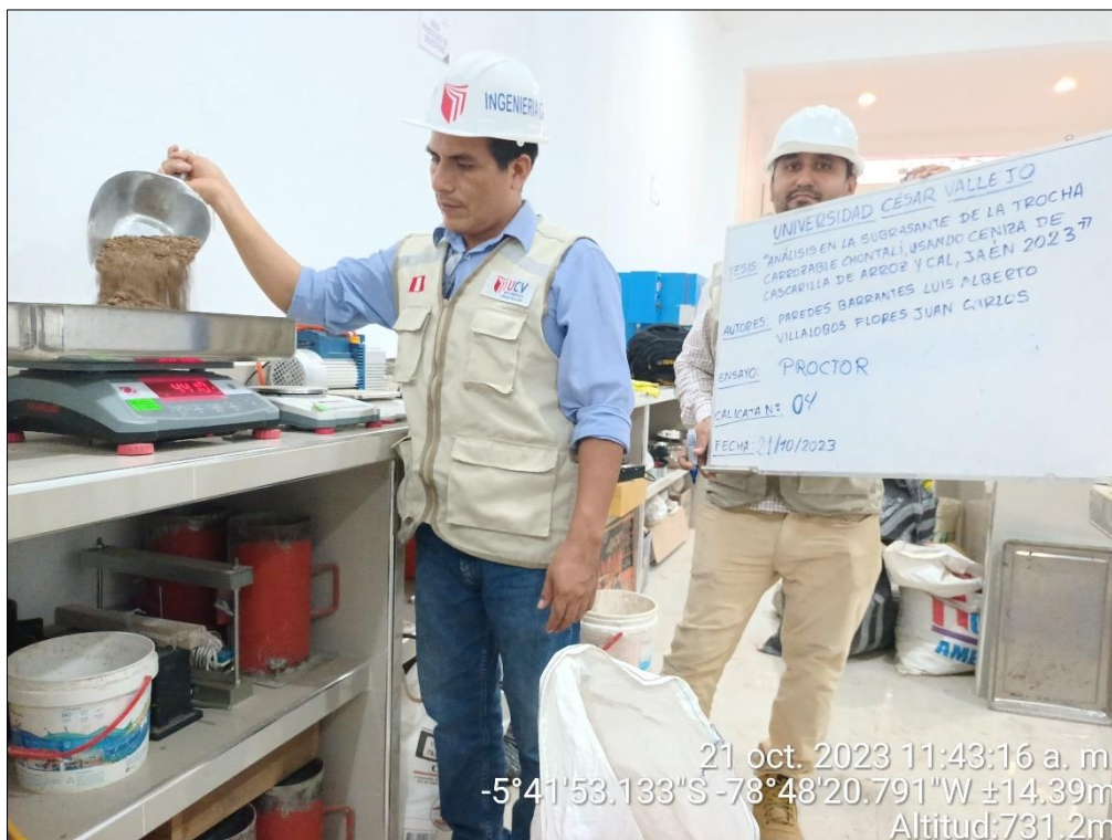
Figura 46. Pesado de la muestra para ensayo de Proctor, calicata N° 04
