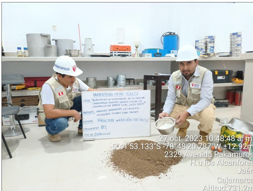
Figura 52. Ensayo de Proctor con adición de CAL al 5%
