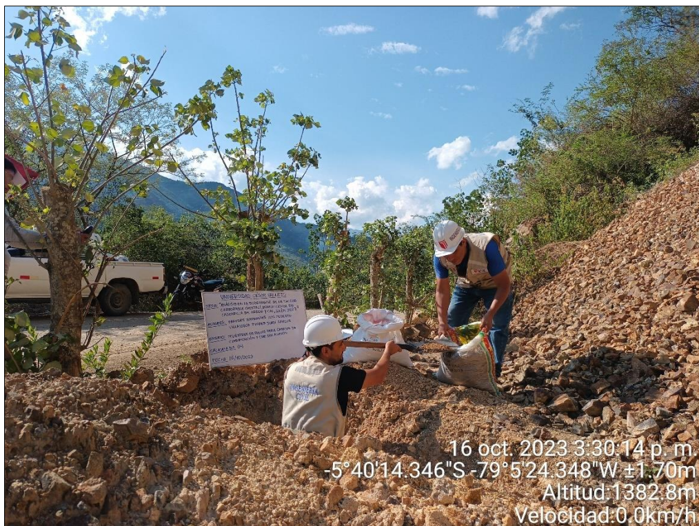
Figura 22. Muestreo para CBR de la calicata N° 04
