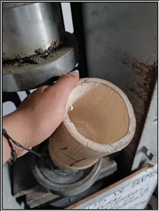
Anexo 14: Falla por dentro del testigo de bambú.
