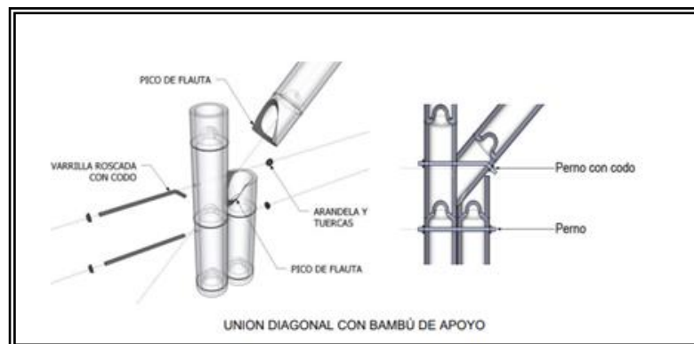
Figura 41. Unión diagonal con pernos y varillas de acero
