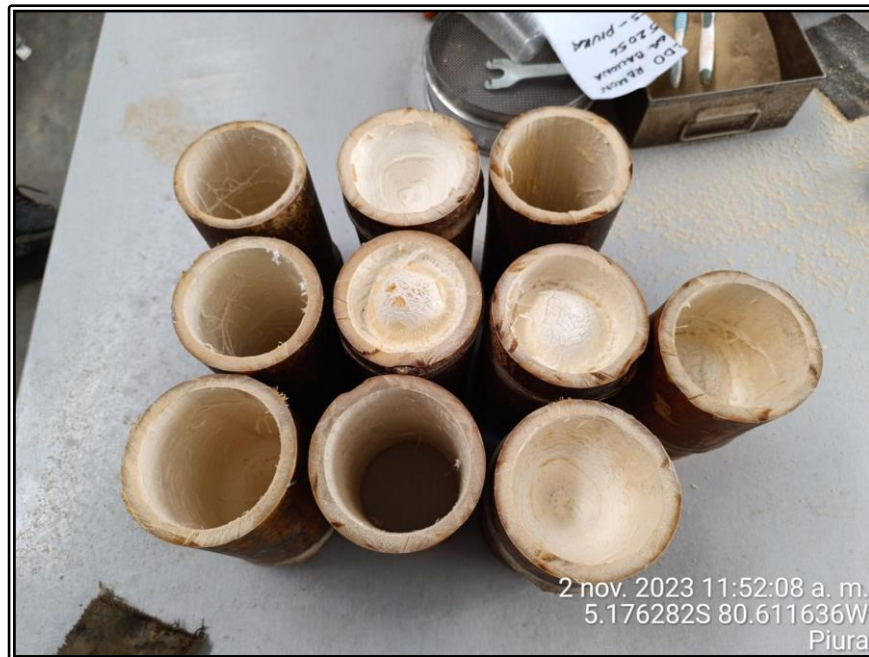
Figura 5. Observación de sección transversal de culmo, corte fino y limpio de culmo maduro (04-06 Años).
