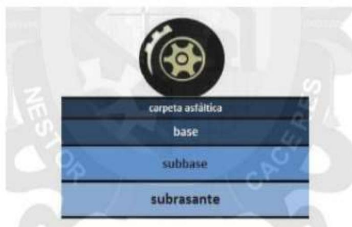
figura 1. Estructura de un Pavimento Flexible
