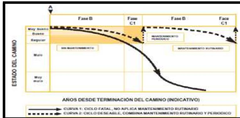
figura 2. Curva del deterioro del pavimento
