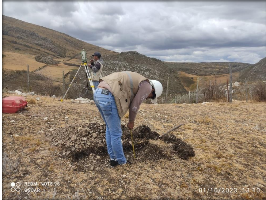
MEDICIÓN DE CALICATA PARA LLEGAR A LA MEDIDA INDICADA
