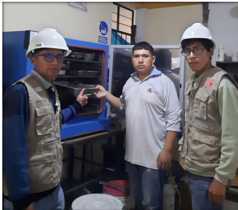
MUESTRAS EN EL HORNO PARA VERIFICAR EL CONTENIDO DE HUMEDAD DE MATERIAL
