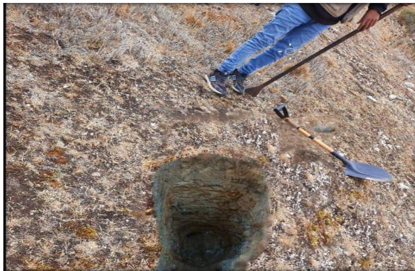
PROFUNDIDAD DE LA EXCAVACIÓN DE CALICATA
