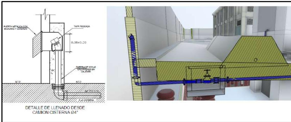
*Nota.* En el plano indica que el ingreso de la tubería para el abastecimiento por cisterna, va en un muro paralelo al cerco, y en el modelado dicha tubería va embebida en el muro del cerco perimétrico. Fuente: Expediente EMR ingeniería y construcción.
