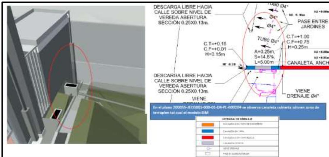
*Nota.* Se observa colocación de una caja de pase de desagüe sobre sobre una canaleta de evacuación pluvial. Donde también existe un pequeño terraplén para las instalaciones sanitarias. Fuente: Consorcio AJANI – GCZ
