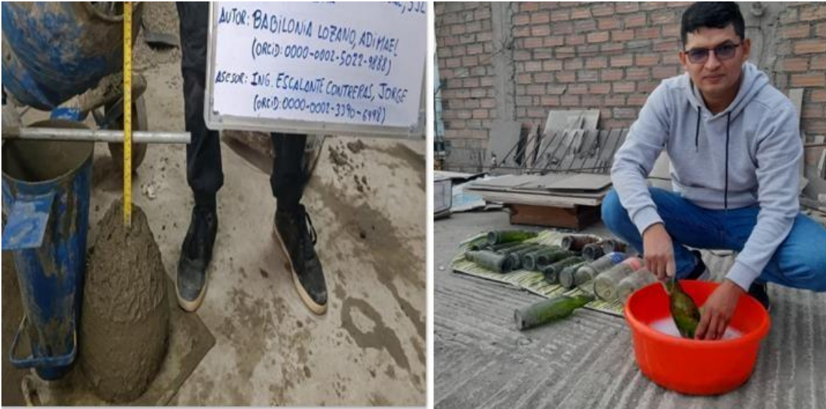
Figura 27. Medición de la plasticidad del concreto adicionado con polvo de vidrio.
