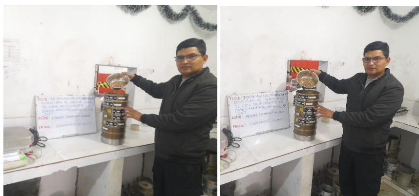
Figura 19. Tamizado de la muestra de suelo de la calicata.
