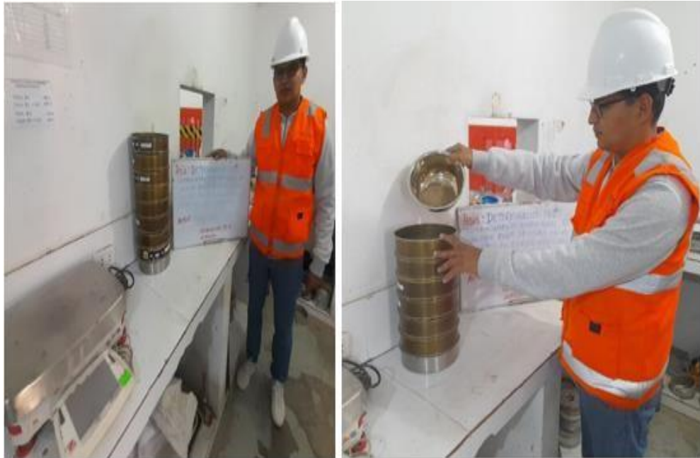
Figura 11. Ensayo de granulometría del agregado grueso y piedra chancada.
