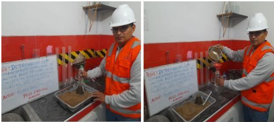
Figura 14. Ensayo de peso unitario suelto y compactado de los agregados.
