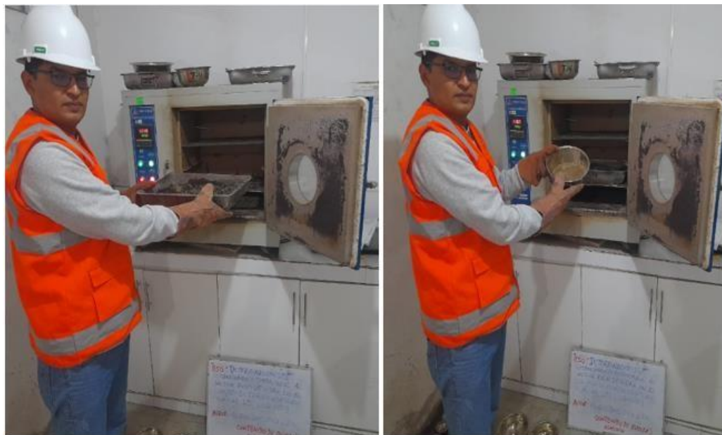
Figura 10. Obtención del contenido de humedad de la piedra chancada y arena gruesa. Fuente: Elaboración propia
