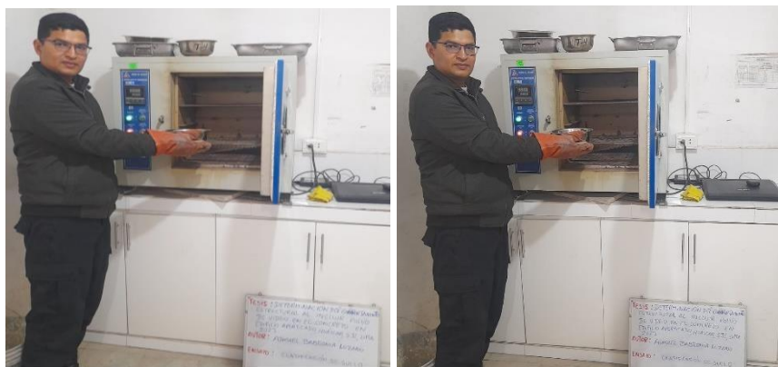
Figura 20. Ensayo de humedad de la muestra de suelo.
