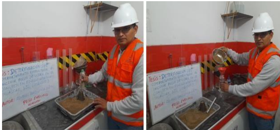
Figura 13. Ensayo de gravedad específica del agregado fino.
