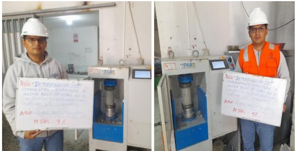
Figura 16. Ensayo de resistencia a la compresión.
