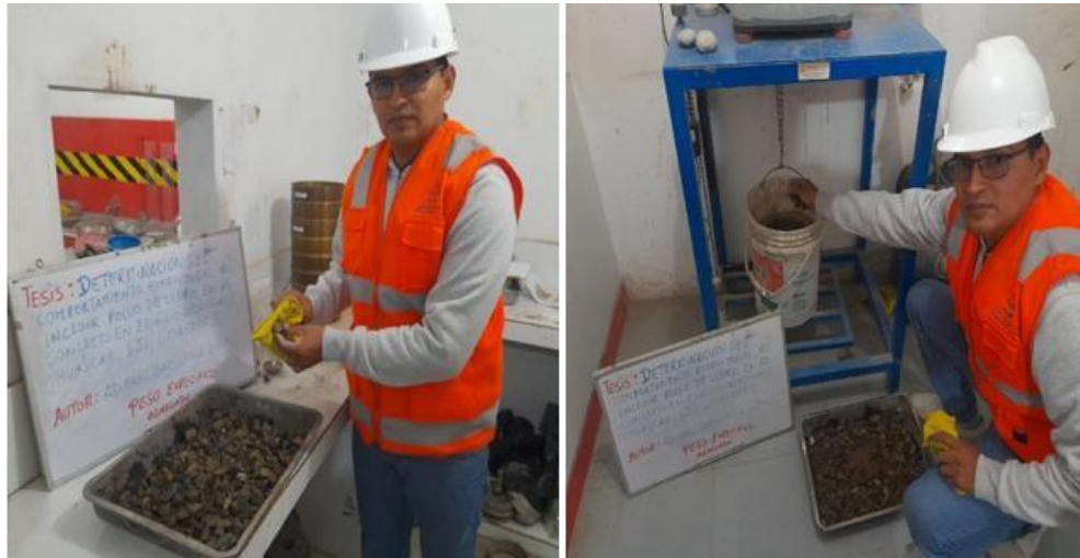
Figura 12. Ensayo de gravedad específica del agregado grueso
