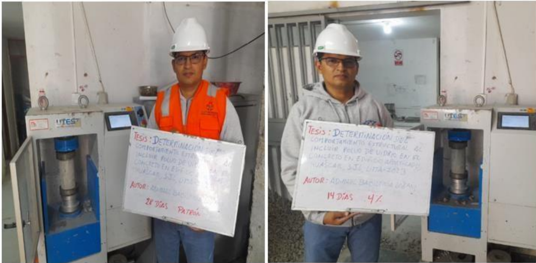
Figura 29. Ensayo de compresión en laboratorio adicionando polvo de vidrio.
