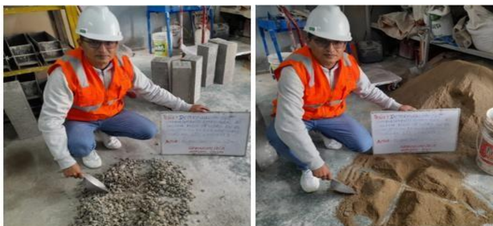
Figura 9. Cuarteo de los agregados.
