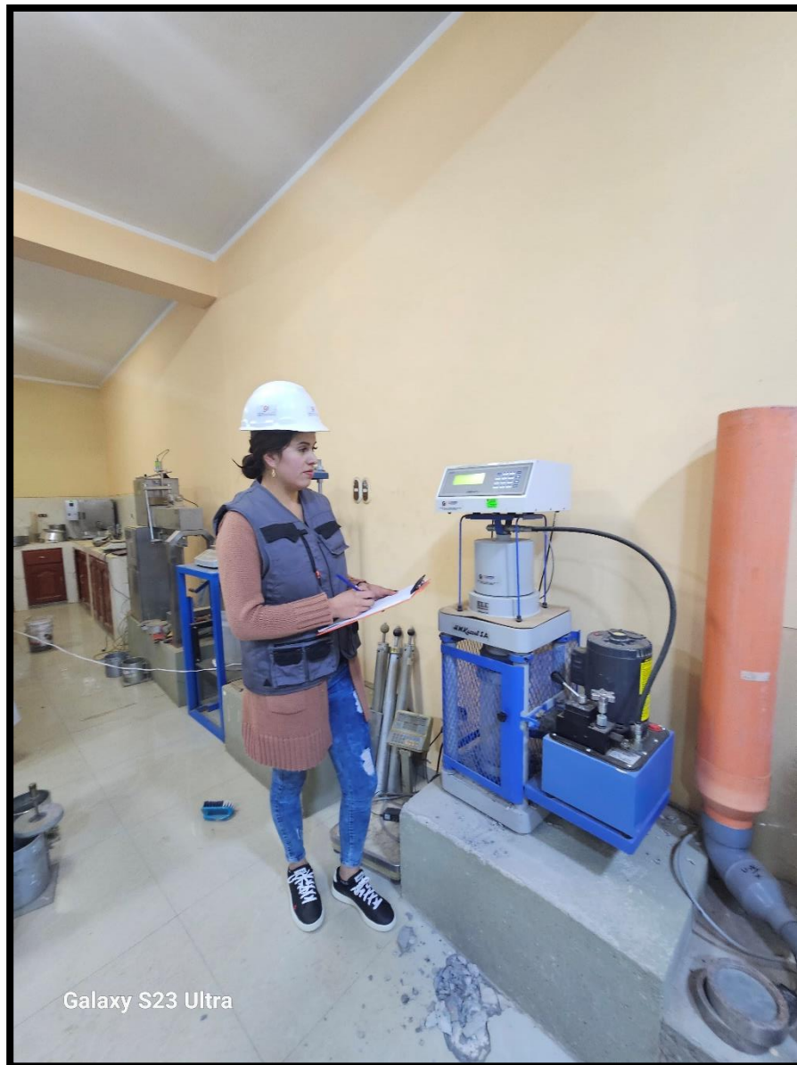
Imagen N° 11: Realización del Ensayo de Resistencia a la compresión de la muestra con Concreto.
