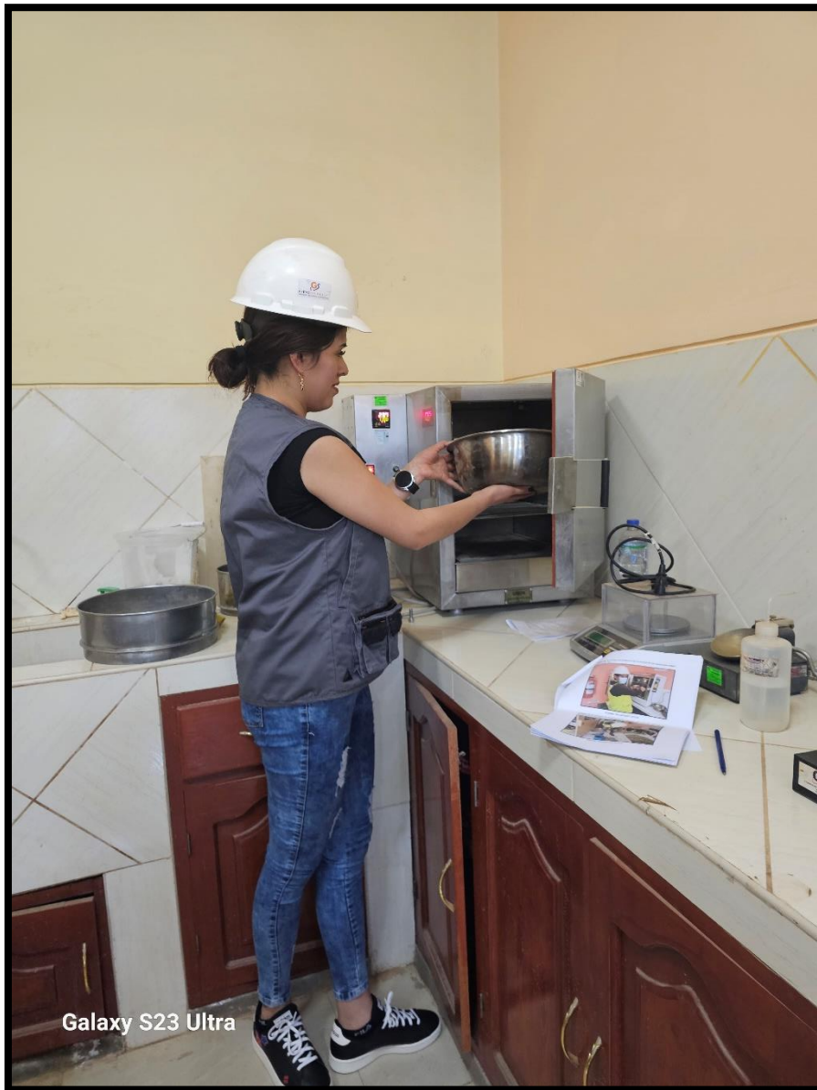
Imagen N° 3: Ensayo de contenido de Humedad de los Agregados para la granulometría.
