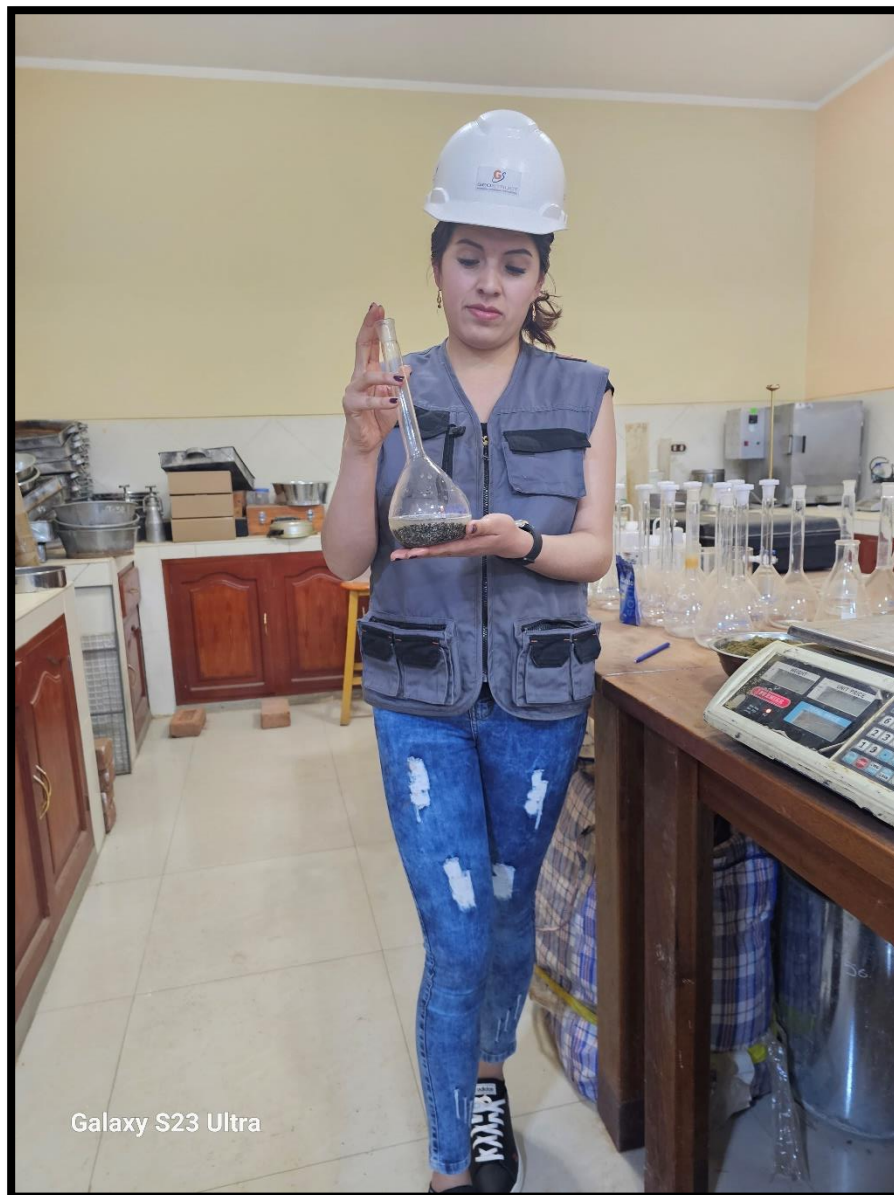
Imagen N° 5: Ensayo de Peso Específico y Absorción del Agregado Fino.
