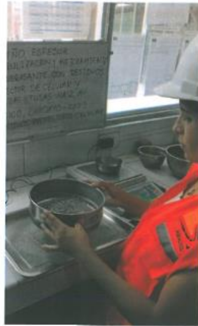
TAMIZADO DE LOS PROTECTORES DE VIDRIO
