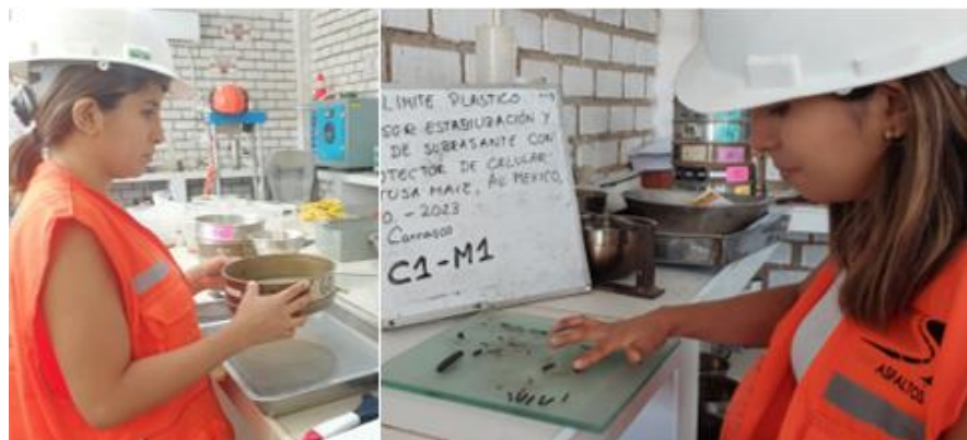
Figura 25 Realizando ensayos límites de consistencia
