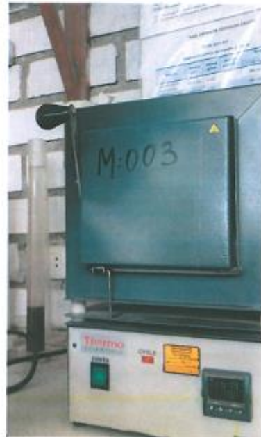
ACENIZACION EN LA MUFLA A 500°C X 3HRS
