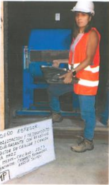
TRITURACION DE LOS PROTECTORES DE VIDRIO EN LA MAQUINA DE LOS ANGELES
