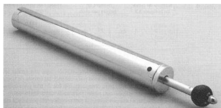
Figura 16 Martillo de compactación Proctor.
