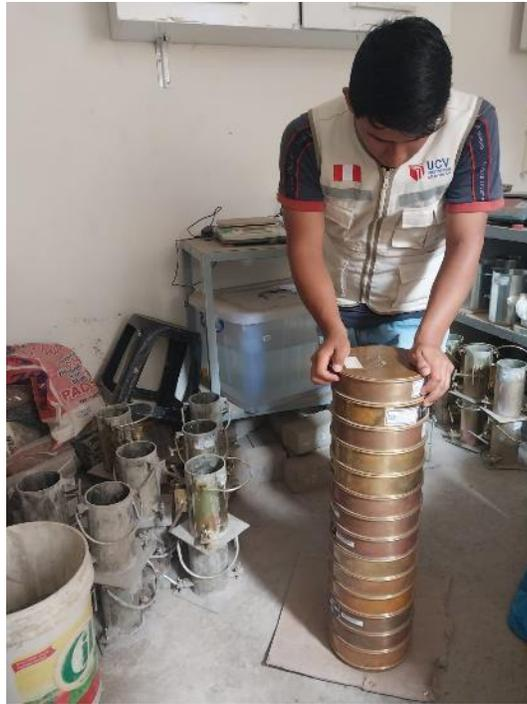
*Figura 10. Análisis granulométrico por tamizado.*
