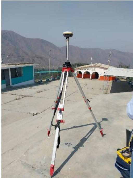
*Figura 12.* Levantamiento con equipo GNSS.
