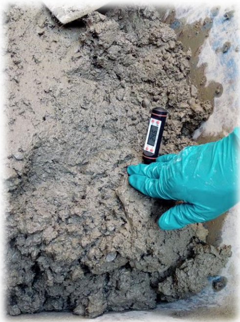
Figura N°16: Temperatura del concreto
