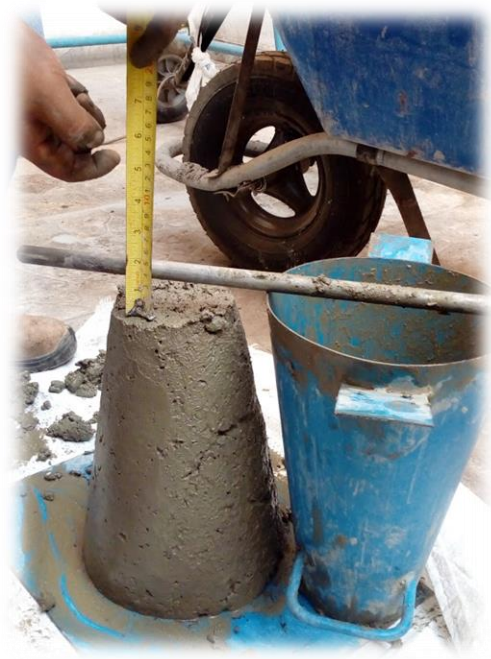
Figura N°17: medición del slump
