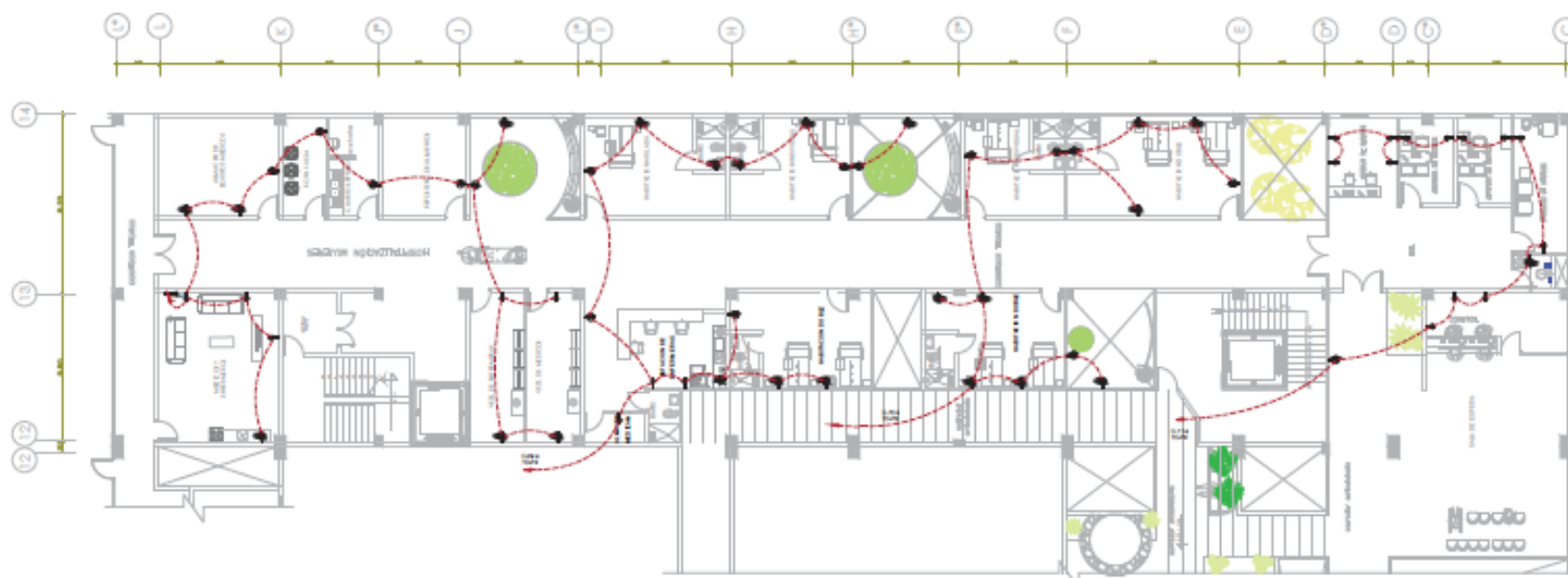
RED DE TOMACORRIENTES EN CUARTO PISO ESCALA 1/100
