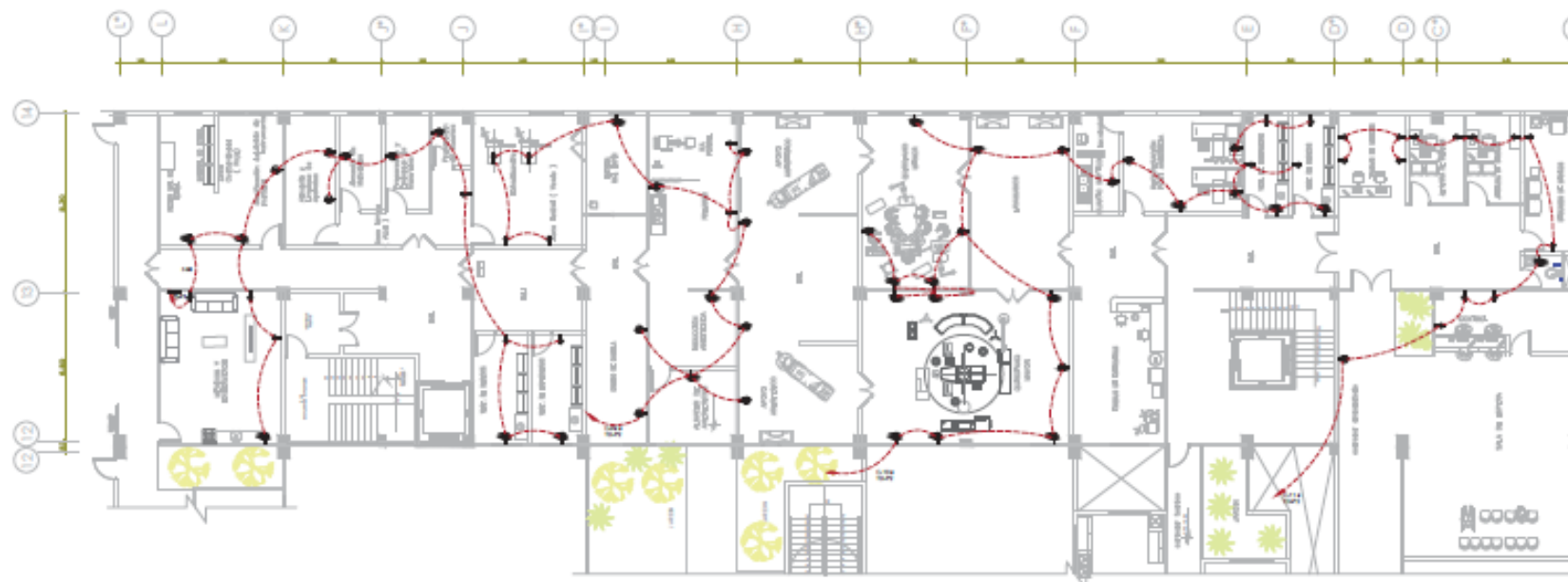
RED DE TOMACORRIENTES EN SEGUNDO PISO
