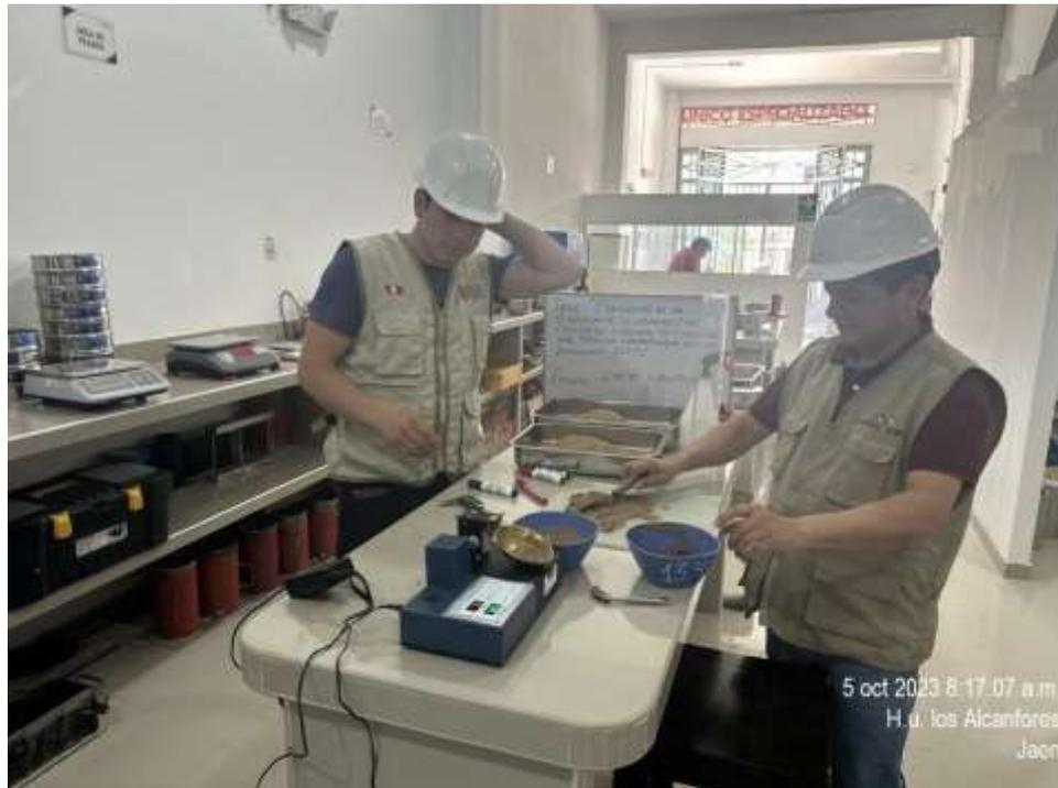
*Proceso del ensayo limite plástico. haciendo largos hilos hasta notar fractura o rajadura en la muestra.*
