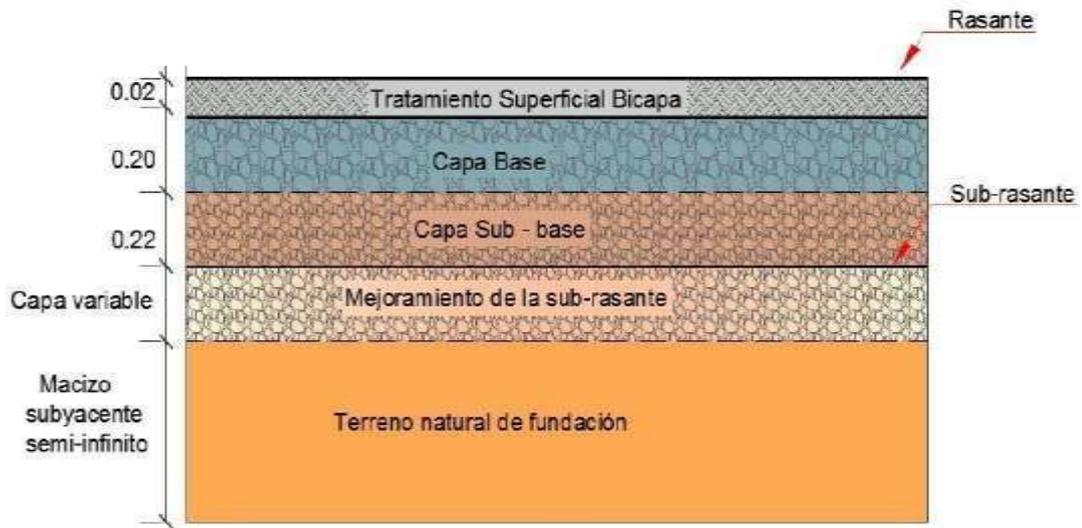
Figura 01. Capas que componen una estructura vial.
