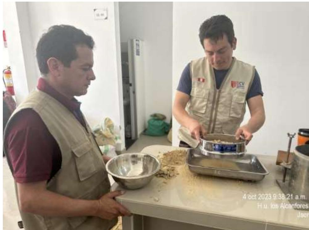
*Ensayo de Proctor modificado + adición.*
