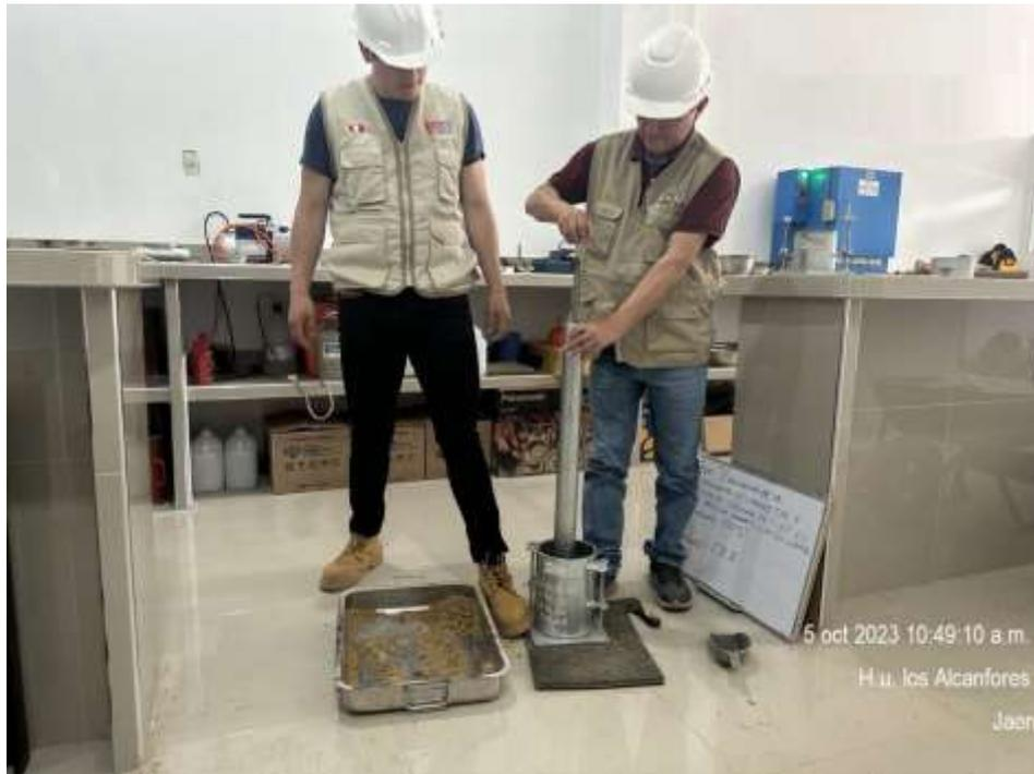
*Ensayo de Proctor modificado + adición.*
