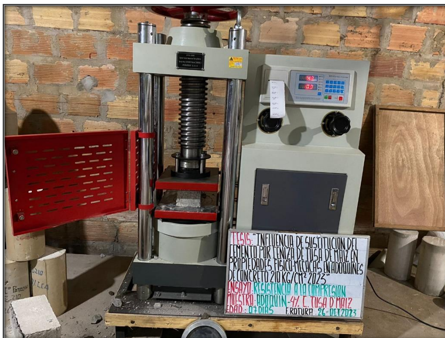
Ruptura de los adoquines en la máquina de ensayo de resistencia a la compresión – muestra de estudio, al 4% de sustitución en sus 7 días de fraguado.
