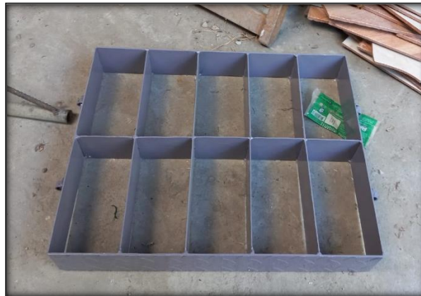
Figura 5. Molde de para la elaboración de los adoquines
