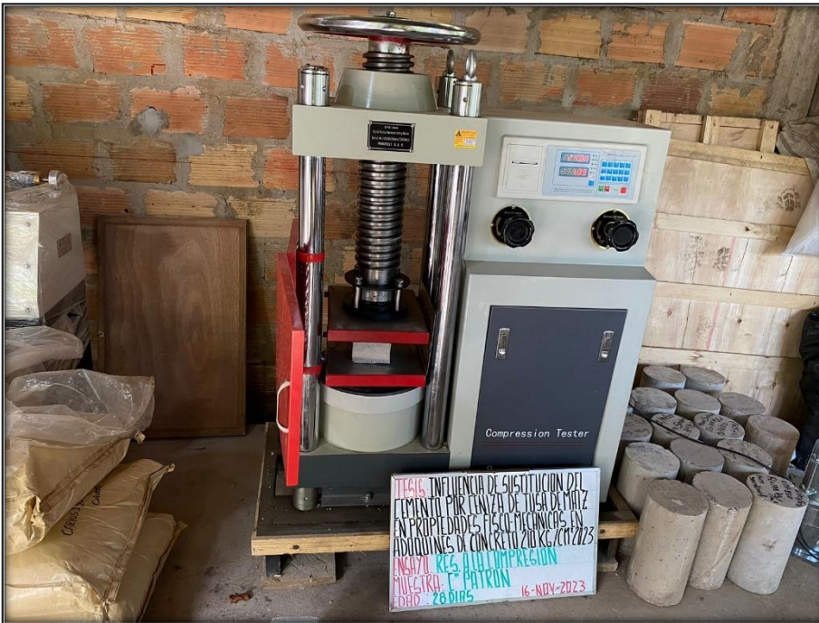
Ruptura de los adoquines en la máquina de ensayo de resistencia a la compresión – muestra patrón, al 0% de sustitución en sus 28 días de fraguado.
