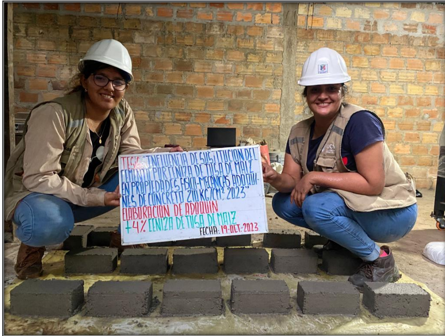
Elaboración de los adoquines – muestra de estudio, al 4% de sustitución.
