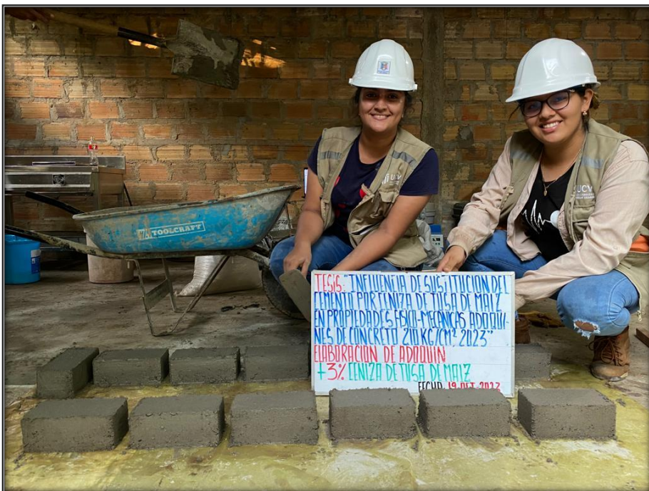
Elaboración de los adoquines – muestra de estudio, al 3% de sustitución.
