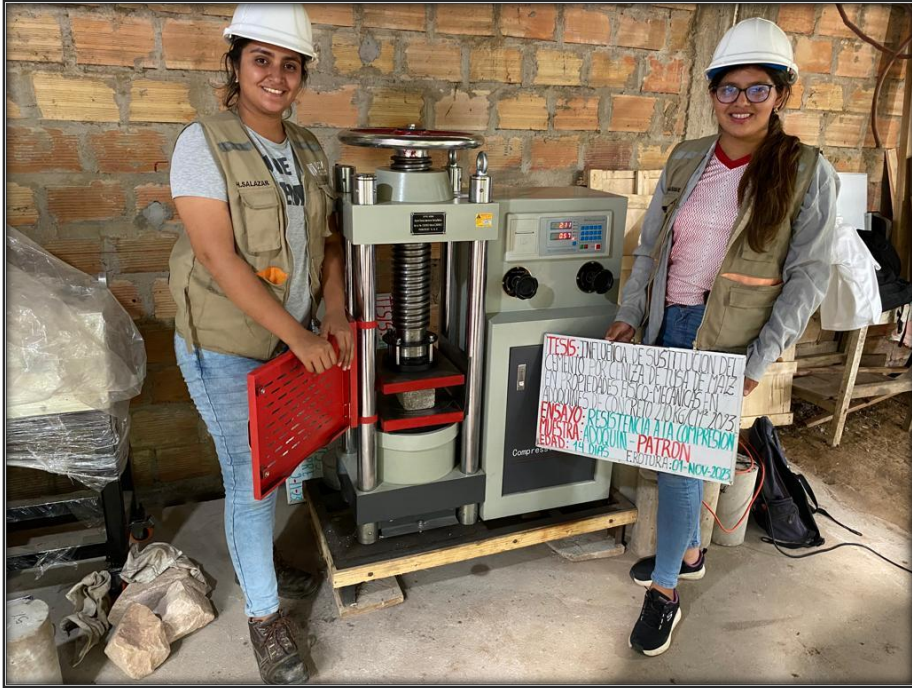
Ruptura de los adoquines en la máquina de ensayo de resistencia a la compresión – muestra patrón, al 0% de sustitución en sus 14 días de fraguado.
