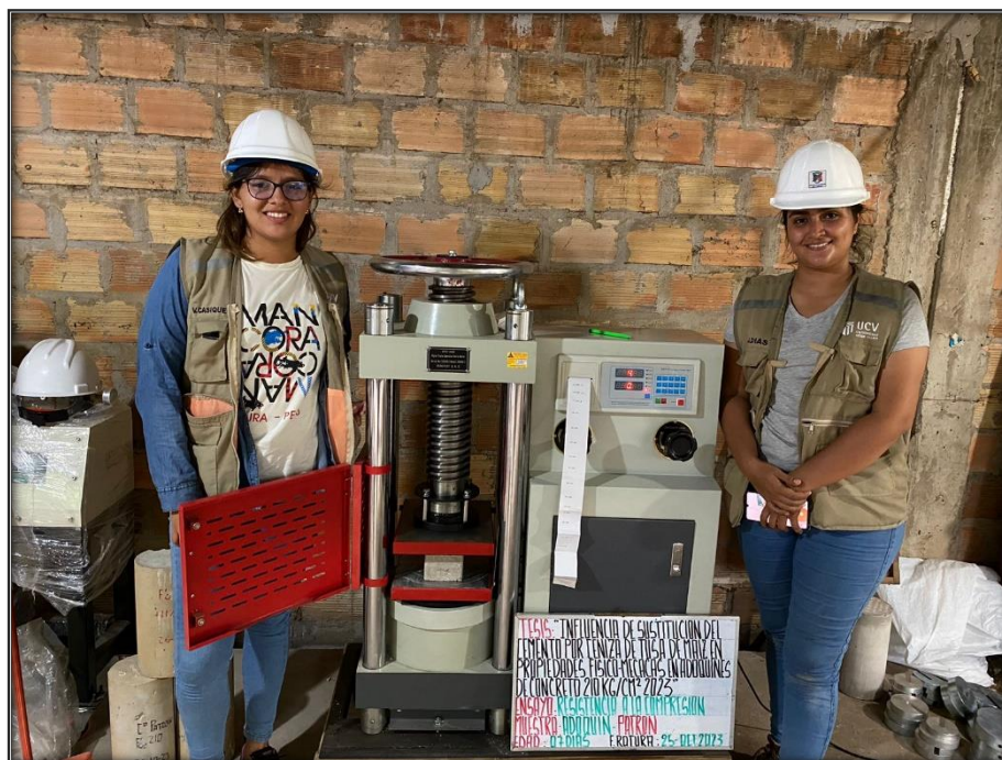
Ruptura de los adoquines en la máquina de ensayo de resistencia a la compresión – muestra patrón, al 0% de sustitución en sus 7 días de fraguado.
