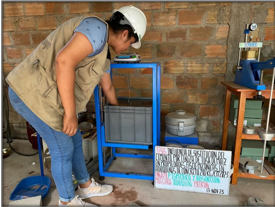
Ensayos en el laboratorio de peso específico y absorción a los adoquines – muestra patrón, al 0% de sustitución en sus 28 días de fraguado.
