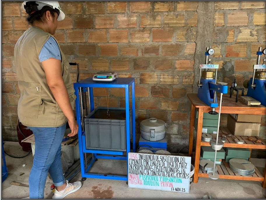
Ensayos dentro del laboratorio de peso específico y absorción a los adoquines – muestra de estudio, al 2% de sustitución en sus 28 días de fraguado.
