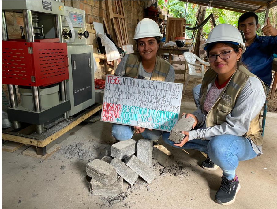
Ruptura de los adoquines en la máquina de ensayo de resistencia a la compresión – muestra de estudio, al 4% de sustitución en sus 14 días de fraguado.
