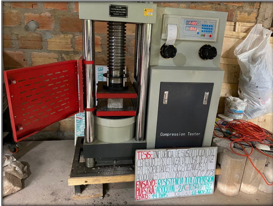
Ruptura de los adoquines en la máquina de ensayo de resistencia a la compresión – muestra de estudio, al 2% de sustitución en sus 14 días de fraguado.
