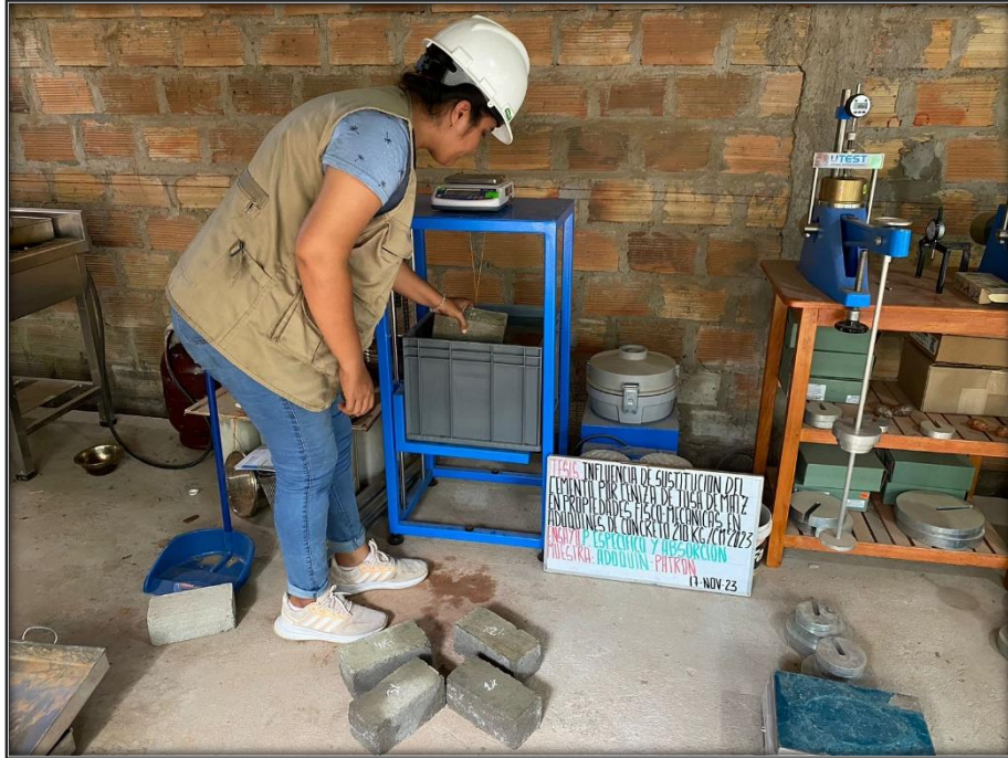
Ensayos dentro del laboratorio de peso específico y absorción a los adoquines – muestra de estudio, al 4% de sustitución en sus 28 días de fraguado.
