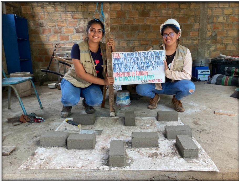
Elaboración de los adoquines – muestra de estudio, al 1% de sustitución.
