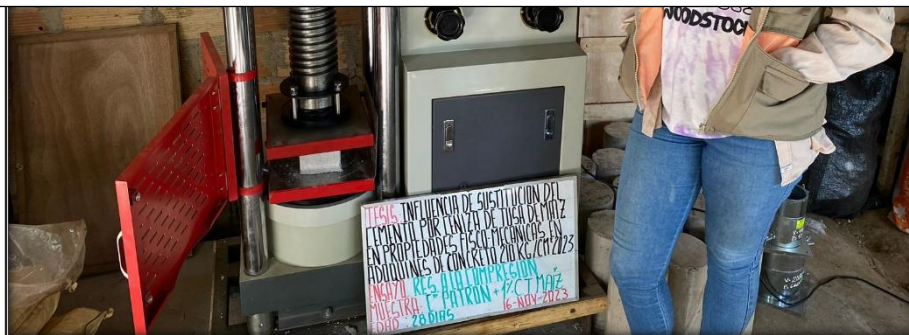
Ruptura de los adoquines en la máquina de ensayo de resistencia a la compresión – muestra de estudio, al 2% de sustitución en sus 28 días de fraguado.
