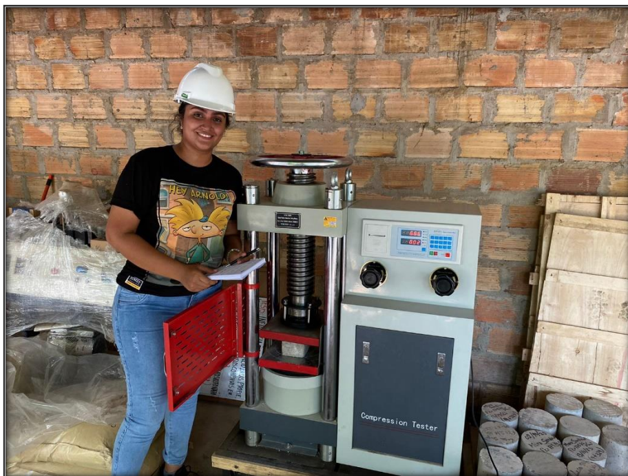
Ruptura de los adoquines en la máquina de ensayo de resistencia a la compresión – muestra de estudio, al 4% de sustitución en sus 28 días de fraguado.
