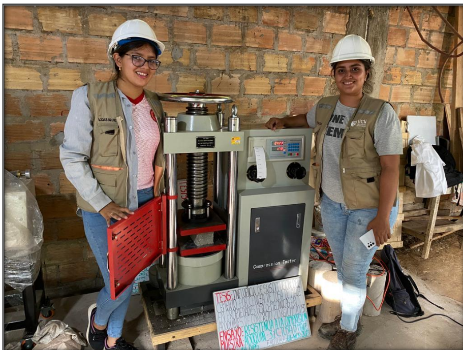
Ruptura de los adoquines en la máquina de ensayo de resistencia a la compresión – muestra de estudio, al 3% de sustitución en sus 14 días de fraguado.
