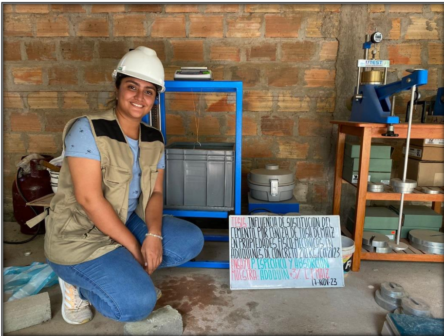
Ensayos dentro del laboratorio de peso específico y absorción a los adoquines – muestra de estudio, al 3% de sustitución en sus 28 días de fraguado.
