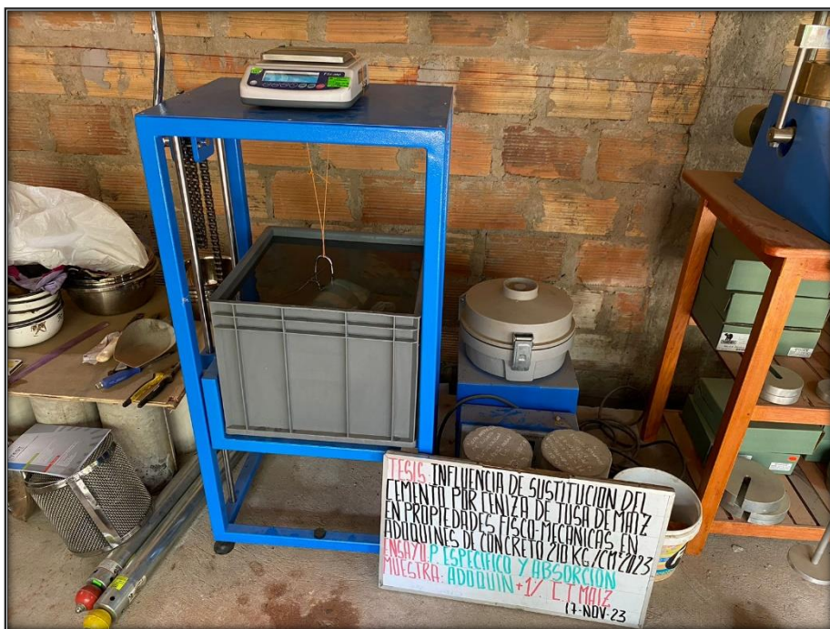
Ensayos dentro del laboratorio de peso específico y absorción a los adoquines – muestra de estudio, al 1% de sustitución en sus 28 días de fraguado.
