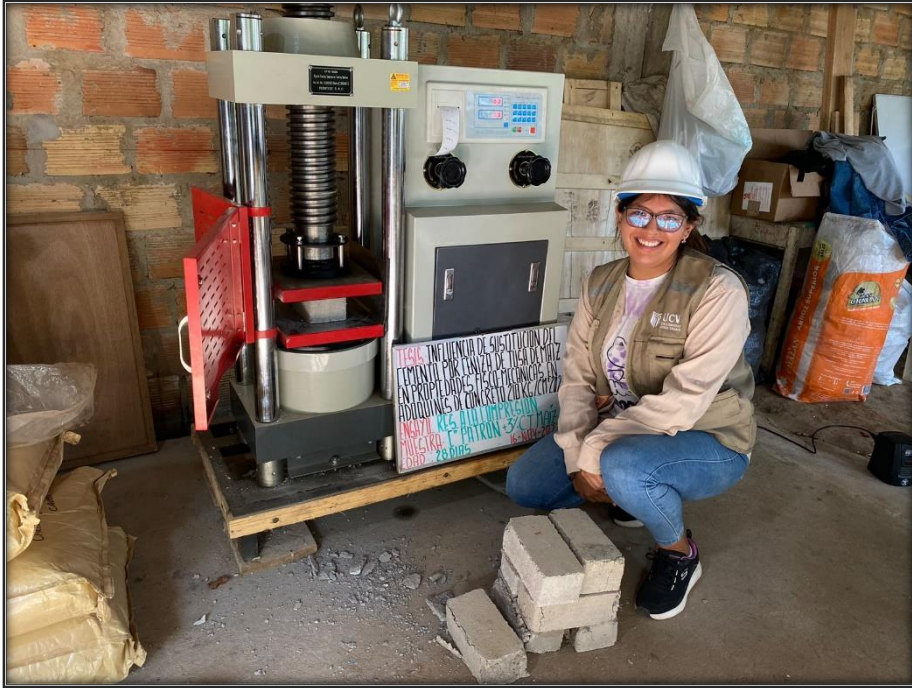
Ruptura de los adoquines en la máquina de ensayo de resistencia a la compresión – muestra de estudio, al 3% de sustitución en sus 28 días de fraguado.
