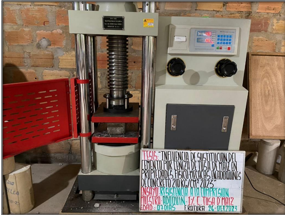
Ruptura de los adoquines en la máquina de ensayo de resistencia a la compresión – muestra de estudio, al 1% de sustitución en sus 7 días de fraguado.
