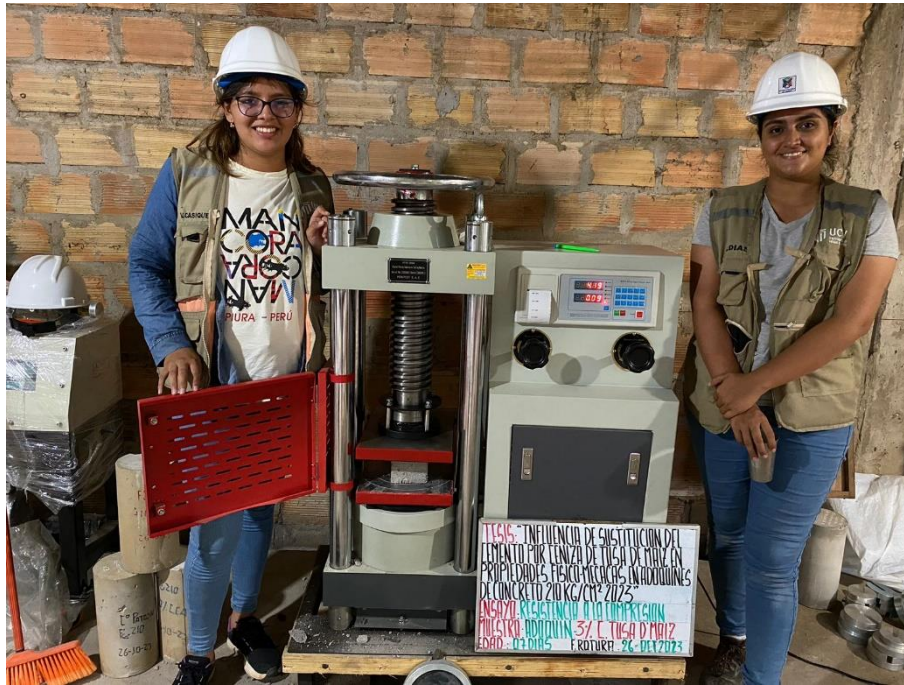
Ruptura de los adoquines en la máquina de ensayo de resistencia a la compresión – muestra de estudio, al 3% de sustitución en sus 7 días de fraguado.
