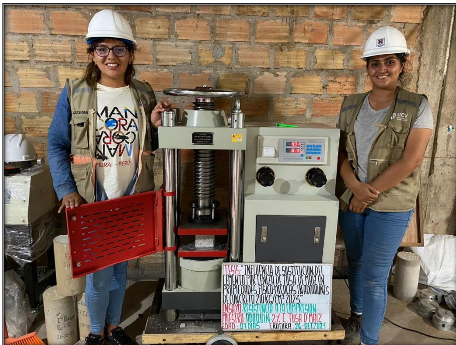
Ruptura de los adoquines en la máquina de ensayo de resistencia a la compresión – muestra de estudio, al 2% de sustitución en sus 7 días de fraguado.
