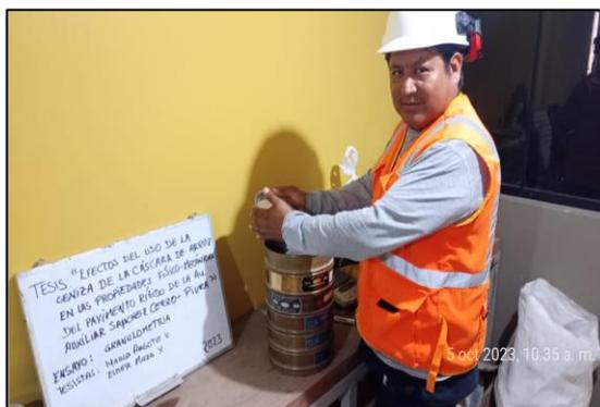
Figura 15. Ensayos de granulometría
