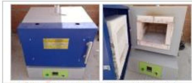
**FIGURA N°1: MUFLA USADA EN LA CALCINACIÓN CONTROLADA**
