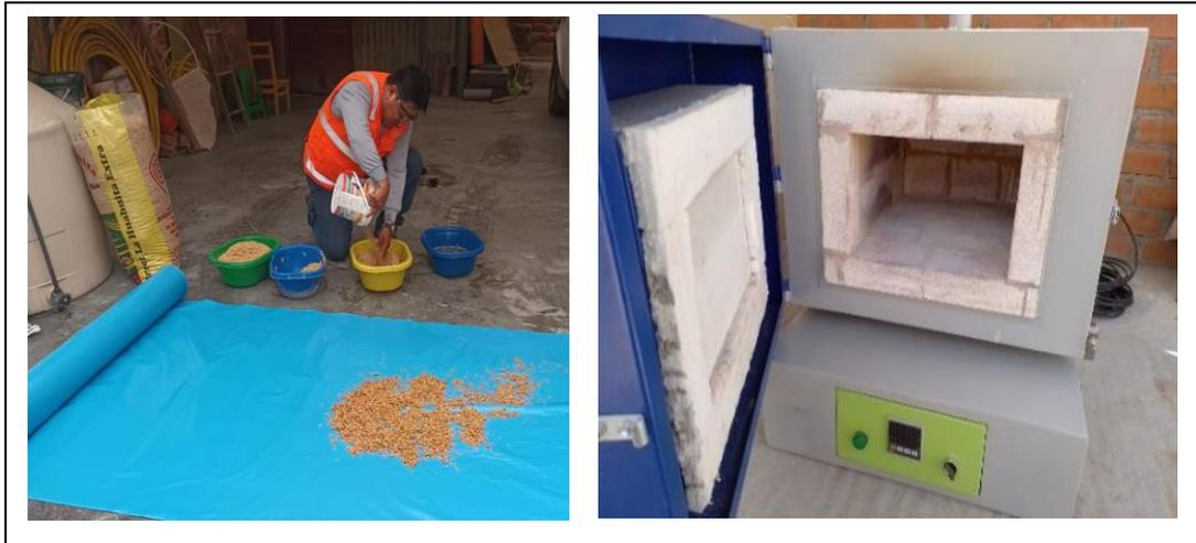
Figura 8. Lavado y secado para posterior quemado en mufla para calcinación controlada.
