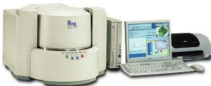
Figura 12. Espectrómetro de fluorescencia de rayos X.
