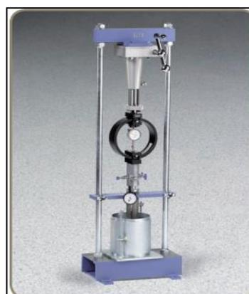
Figura 35. Prensa Manual de Carga CBR
