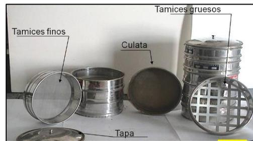
Figura 38. Tamices para agregado grueso y fino
