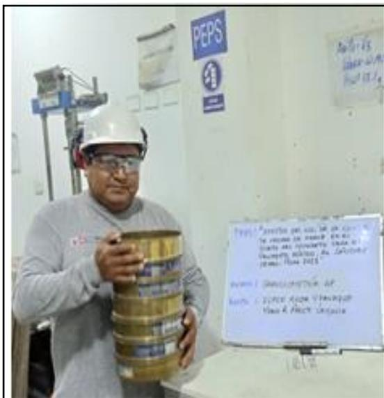
Figura 43. Proceso de Tamizado para el agregado Fino
