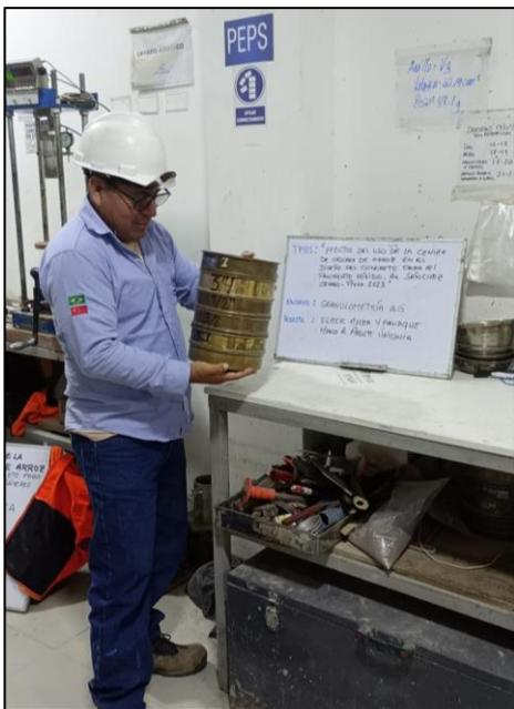
Figura 40. Proceso de tamizado para el agregado grueso (AG)
