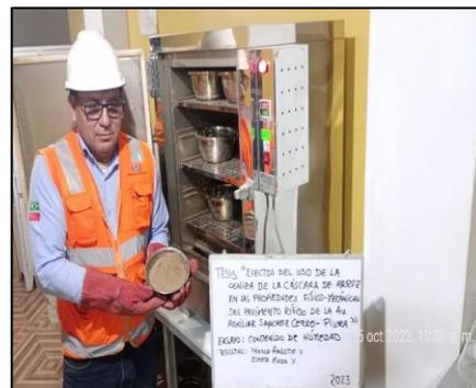
Figura 16. Ensayo de % de humedad
