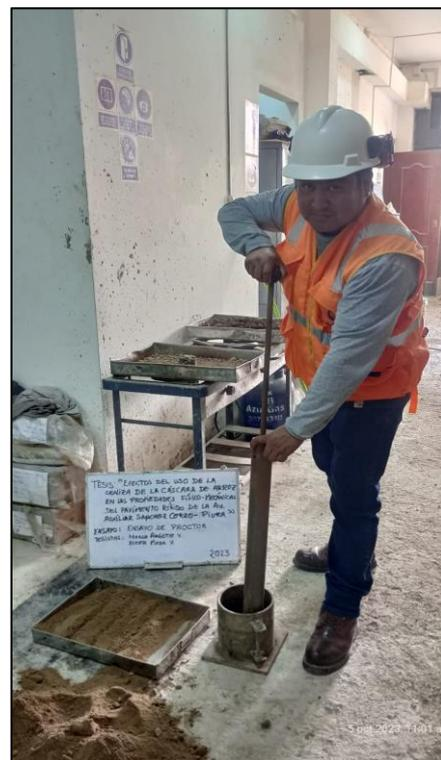
Figura 32. Ensayo de Proctor modificado
