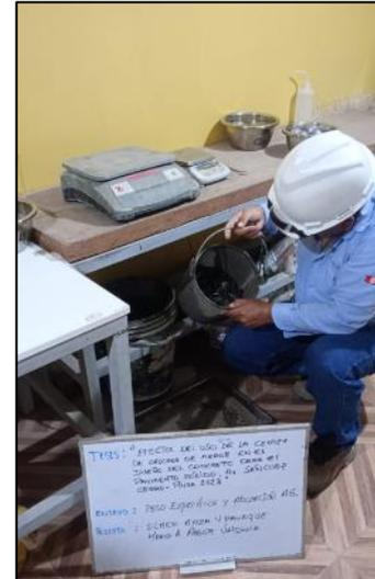
Figura 49. Ensayo de Gravedad específica y
