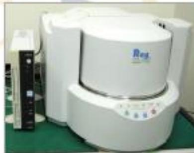
**FIGURA N°3: EQUIPO DE FLUORESCENCIA DE RAYOS X**
