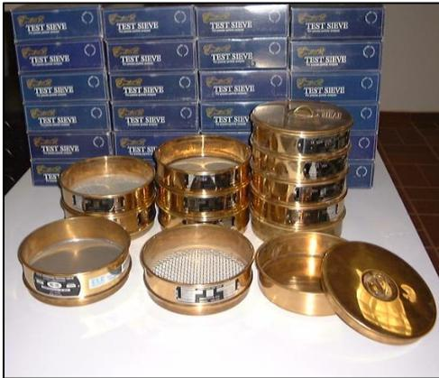
Figura 17. Tamices con mallas de diferentes medidas.
