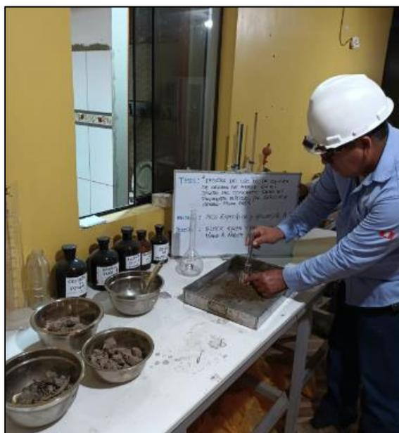
Figura 50. Ensayo de Gravedad específica
