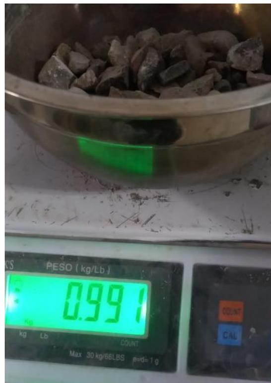
Figura 2. Muestra sacada del horno
