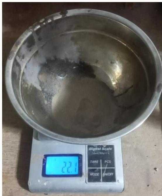
Figura 4. Peso del Matraz con agua
