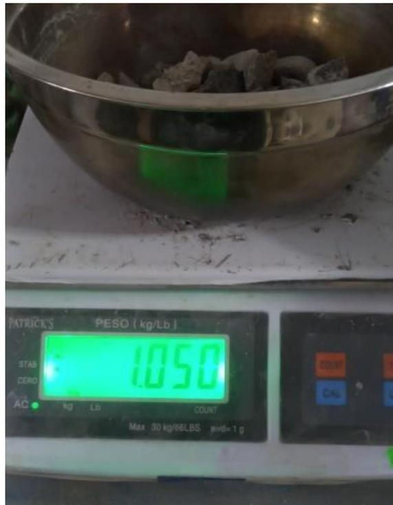
Figura 1. Toma de agregado Húmedo
