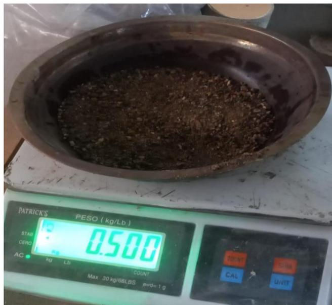
Figura 4. Peso de muestra Saturada Superf Seca
