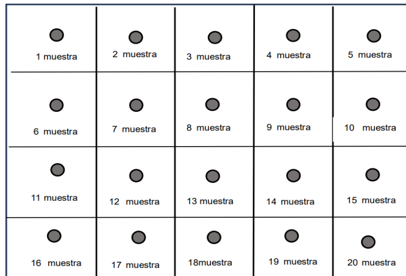
FIGURA 3. Método de rejillas regular
