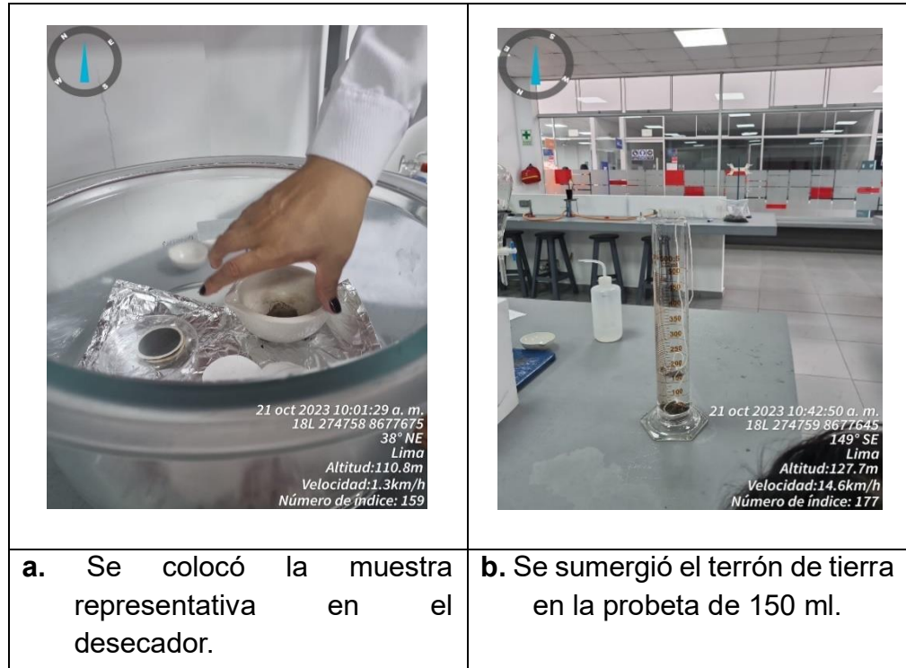
FIGURA 12. Determinación de la densidad real.
