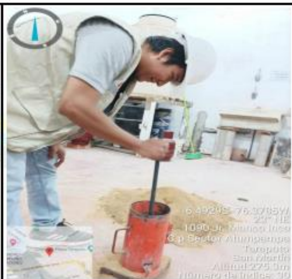
Fotos nº 09-10: En las imágenes podemos observar realización del ensayo de peso unitario.
