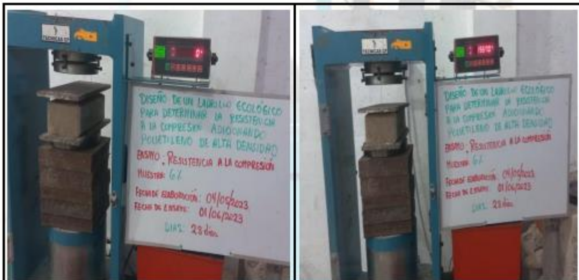
Fotos nº 83-84: En las imágenes podemos observar la resistencia a la compresión axial de los ladrillos ecológicos
