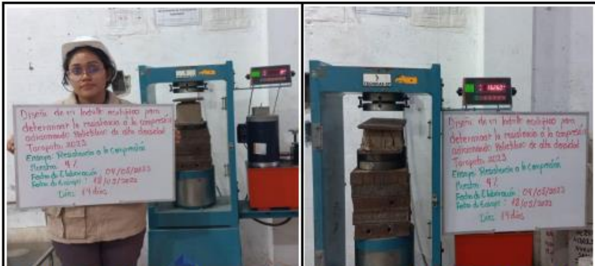
Fotos nº 61-62: En las imágenes podemos observar la resistencia a la compresión axial de los ladrillos ecológicos
