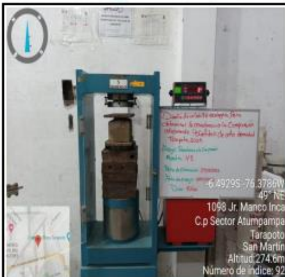
Fotos nº 51-52: En las imágenes podemos observar la resistencia a la compresión axial de los ladrillos ecológicos
