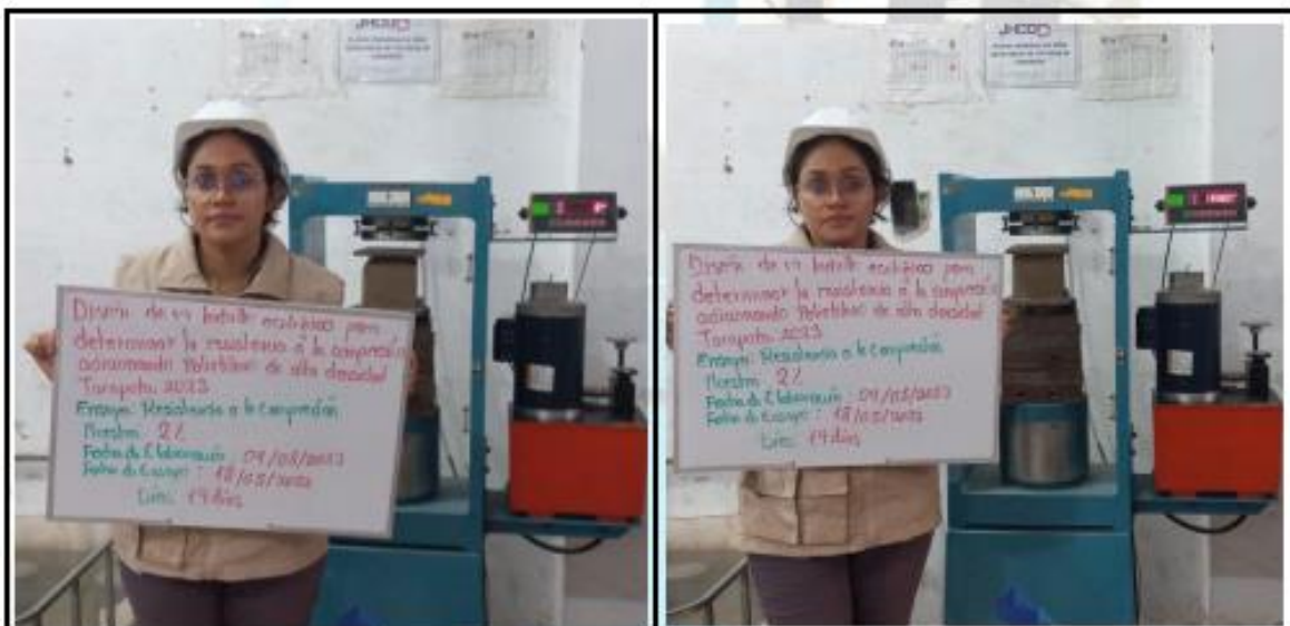
Fotos nº 39-40: En las imágenes podemos observar la resistencia a la compresión axial de los ladrillos ecológicos
