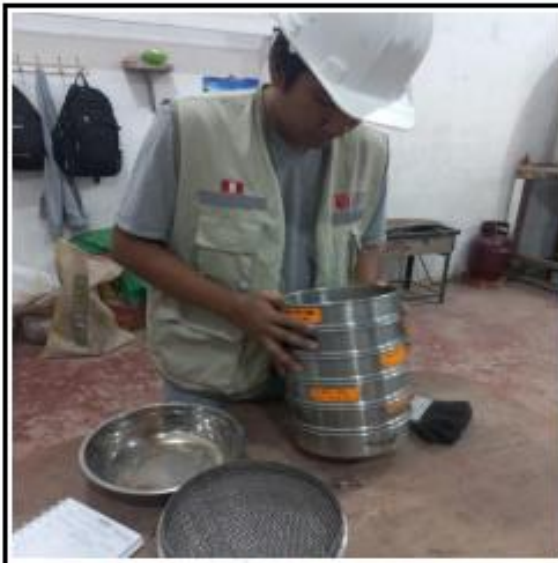
Fotos nº 05-06: En las imágenes se puede apreciar el ensayo de análisis granulométricos.
