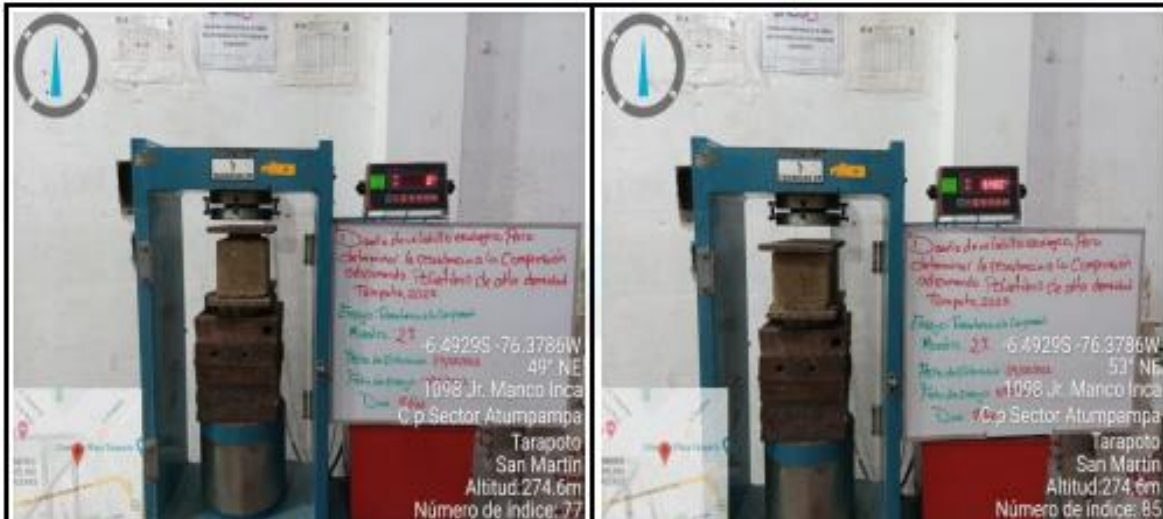
Fotos nº 33-34: En las imágenes podemos observar la resistencia a la compresión axial de los ladrillos ecológicos
