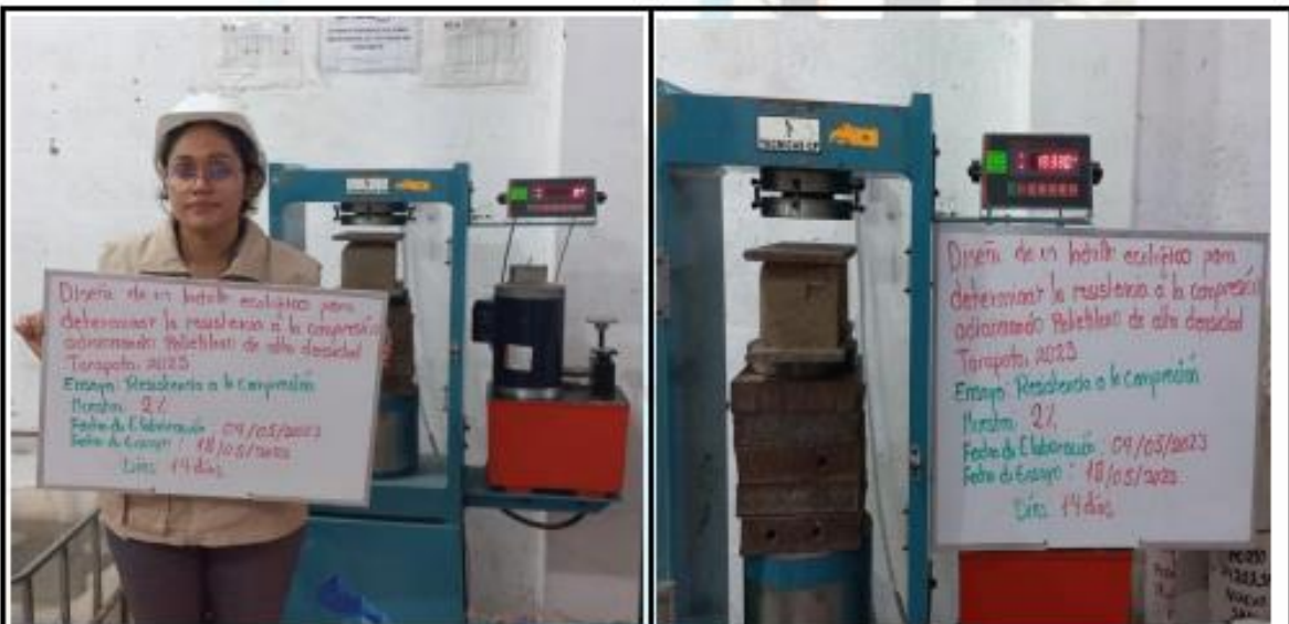
Fotos nº 43-44: En las imágenes podemos observar la resistencia a la compresión axial de los ladrillos ecológicos
