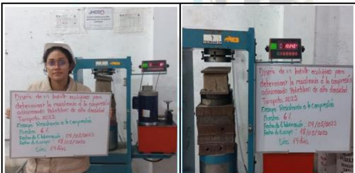
Fotos nº 79-80: En las imágenes podemos observar la resistencia a la compresión axial de los ladrillos ecológicos
