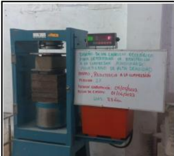
Fotos nº 49-50: En las imágenes podemos observar la resistencia a la compresión axial de los ladrillos ecológicos
