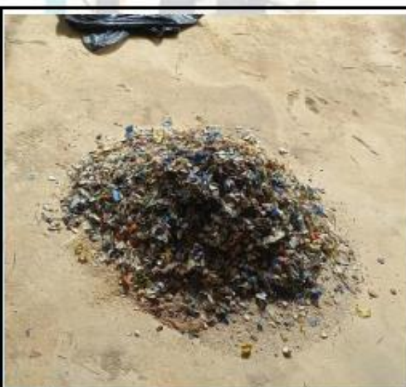
Fotos nº 11-12: En las imágenes podemos apreciar los materiales a utilizar para el diseño de concreto con incorporación de Polietileno de alta densidad.
