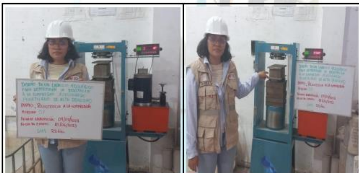
Fotos n° 31-32: En las imágenes podemos observar la resistencia a la compresión axial de los ladrillos ecológicos
