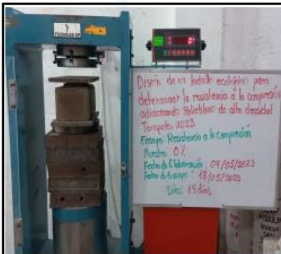
Fotos nº 23-24: En las imágenes podemos observar la resistencia a la compresión axial de los ladrillos ecológicos
