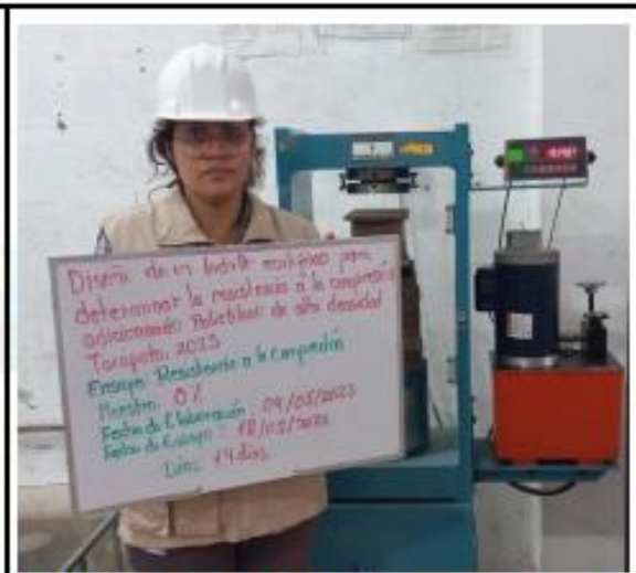
Fotos nº 25-26: En las imágenes podemos observar la resistencia a la compresión axial de los ladrillos ecológicos
