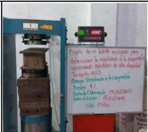
Fotos nº 57-58: En las imágenes podemos observar la resistencia a la compresión axial de los ladrillos ecológicos
