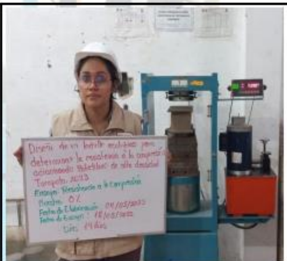
Fotos nº 23-24: En las imágenes podemos observar la resistencia a la compresión axial de los ladrillos ecológicos
