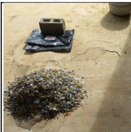
Fotos nº 11-12: En las imágenes podemos apreciar los materiales a utilizar para el diseño de concreto con incorporación de Polietileno de alta densidad.
