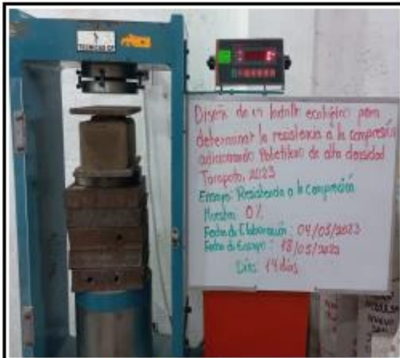
Fotos nº 25-26: En las imágenes podemos observar la resistencia a la compresión axial de los ladrillos ecológicos
