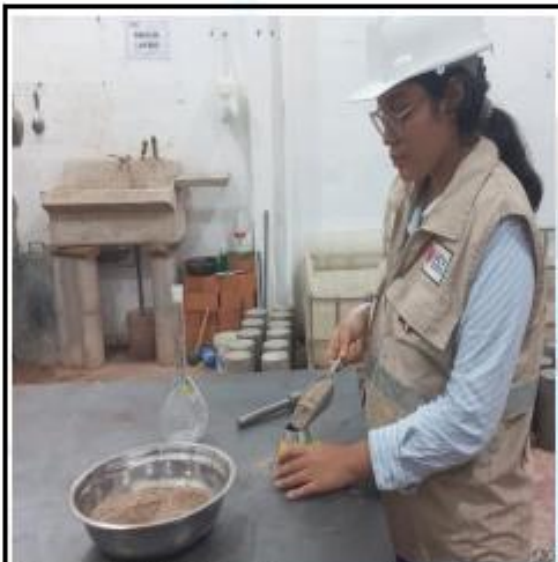
Fotos nº 07-08: En las imágenes podemos observar la realización del ensayo el peso específico
