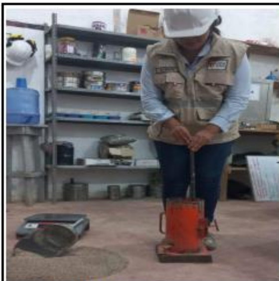
Fotos nº 09-10: En las imágenes podemos observar realización del ensayo de peso unitario.
