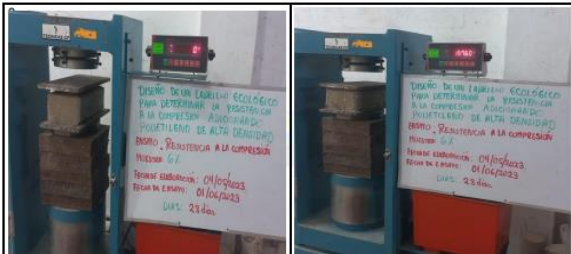
Fotos nº 81-82: En las imágenes podemos observar la resistencia a la compresión axial de los ladrillos ecológicos
