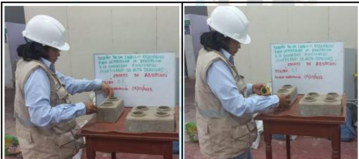
Fotos nº 87-88: En las imágenes podemos observar el Dimensionamiento de los Ladrillos Ecológicos de concreto
