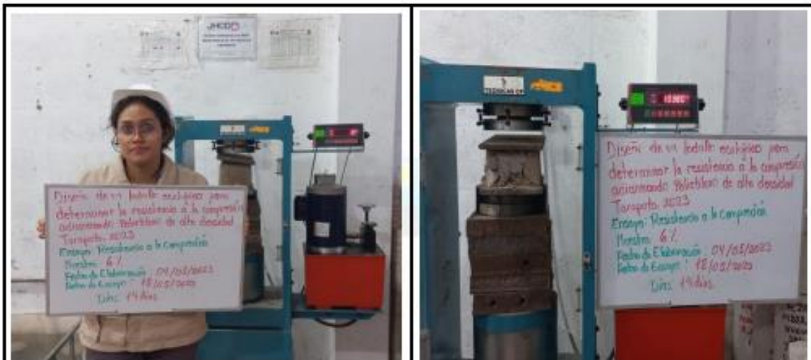
Fotos nº 77-78: En las imágenes podemos observar la resistencia a la compresión axial de los ladrillos ecológicos
