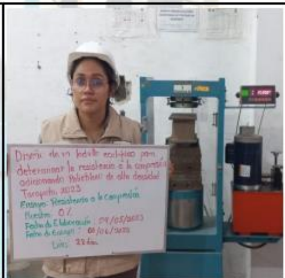
Fotos nº 27-28: En las imágenes podemos observar la resistencia a la compresión axial de los ladrillos ecológicos
