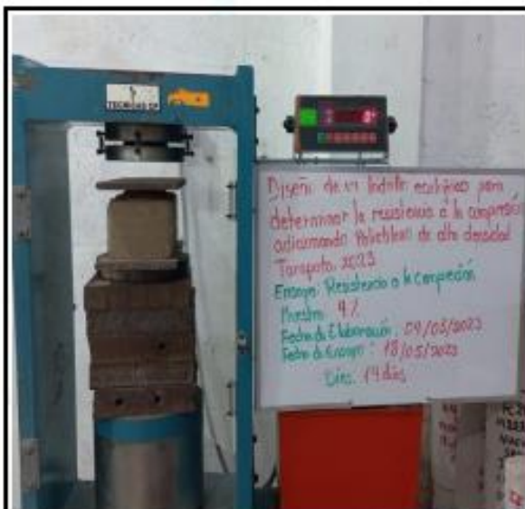
Fotos nº 59-60: En las imágenes podemos observar la resistencia a la compresión axial de los ladrillos ecológicos
