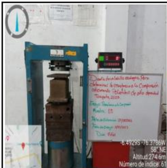
Fotos nº 17-18: En las imágenes podemos observar la resistencia a la compresión axial de los ladrillos ecológicos
