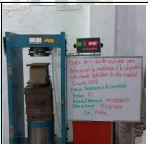
Fotos nº 59-60: En las imágenes podemos observar la resistencia a la compresión axial de los ladrillos ecológicos
