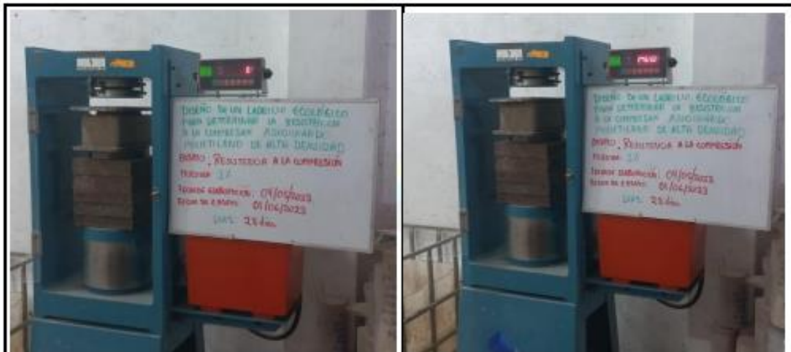
Fotos nº 45-46: En las imágenes podemos observar la resistencia a la compresión axial de los ladrillos ecológicos
