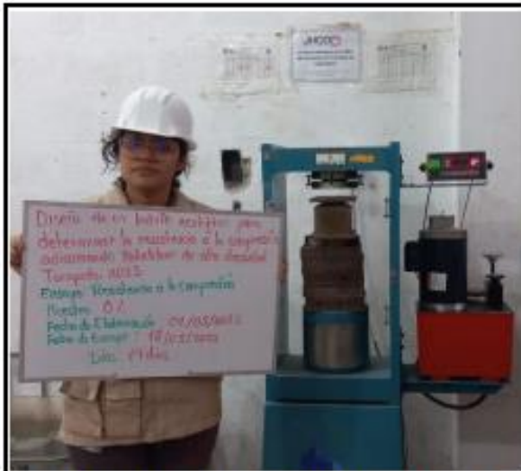
Fotos nº 21-22: En las imágenes podemos observar la resistencia a la compresión axial de los ladrillos ecológicos
