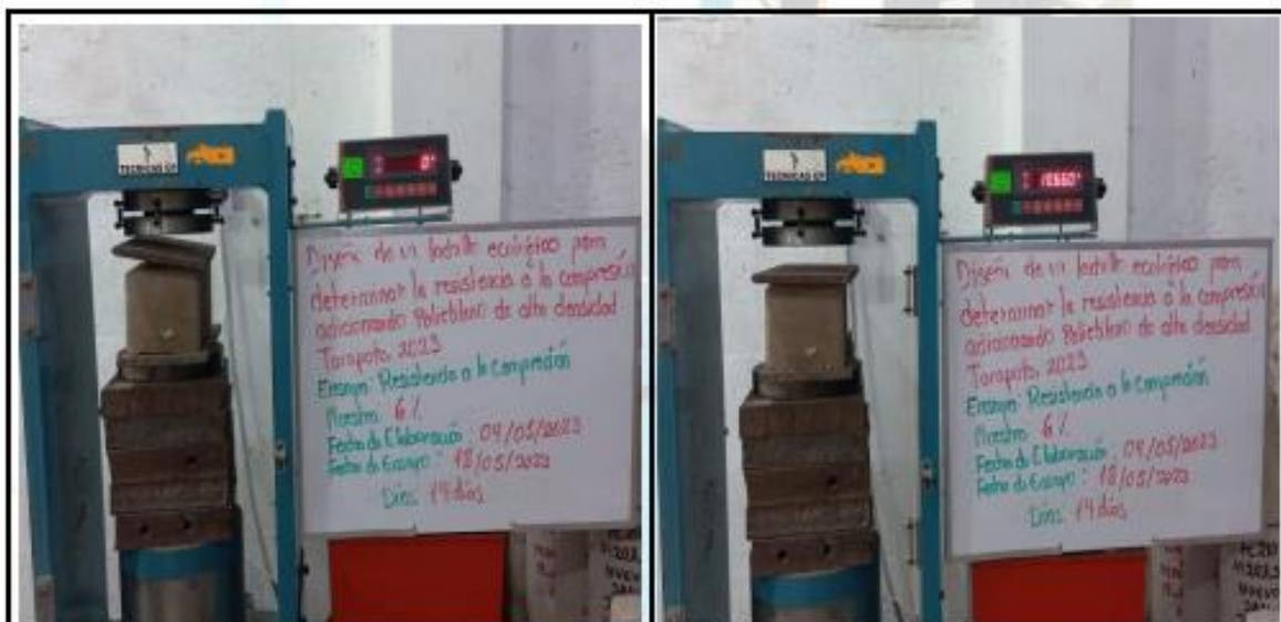
Fotos nº 75-76: En las imágenes podemos observar la resistencia a la compresión axial de los ladrillos ecológicos
