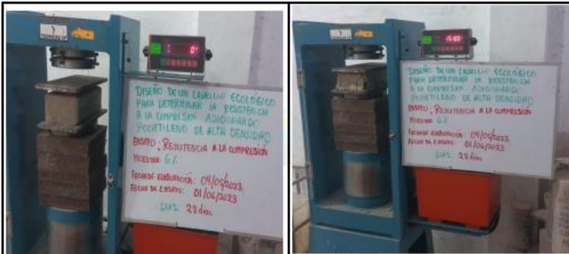
Fotos nº 85-86: En las imágenes podemos observar la resistencia a la compresión axial de los ladrillos ecológicos
