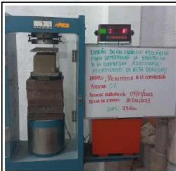
Fotos nº 27-28: En las imágenes podemos observar la resistencia a la compresión axial de los ladrillos ecológicos
