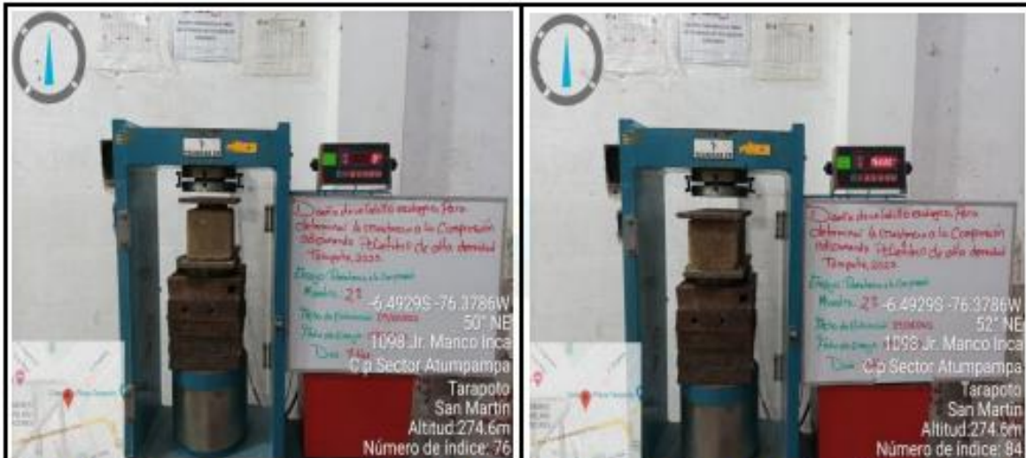
Fotos nº 37-38: En las imágenes podemos observar la resistencia a la compresión axial de los ladrillos ecológicos
