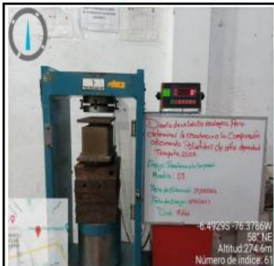
Fotos nº 19-20: En las imágenes podemos observar la resistencia a la compresión axial de los ladrillos ecológicos
