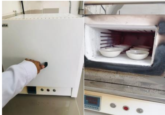
Figura 04. Proceso de carbonización a 540 °C
