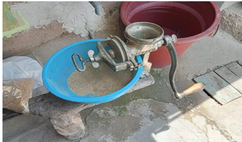
Figura 03. Molienda de carbón activado
