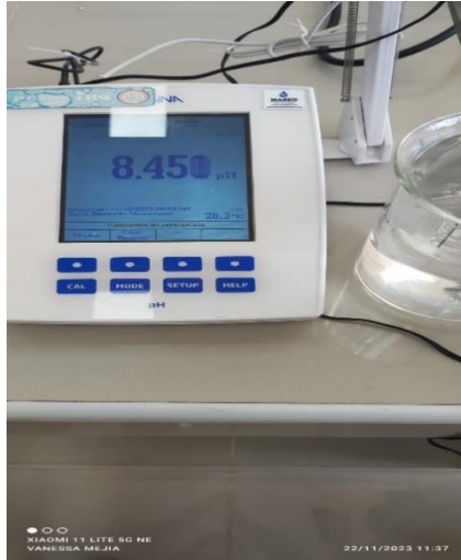
Figura 08. Medición del pH del agua contaminada por arsénico
