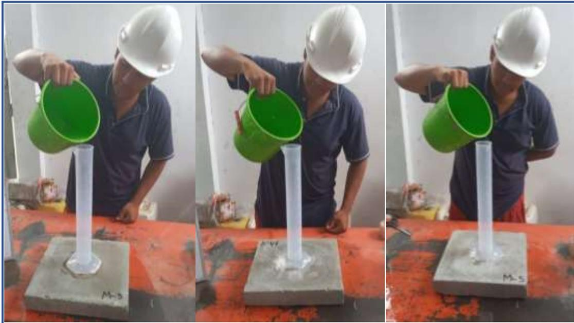
**Figura 5.** Losas Chema Techo método Karsten.
