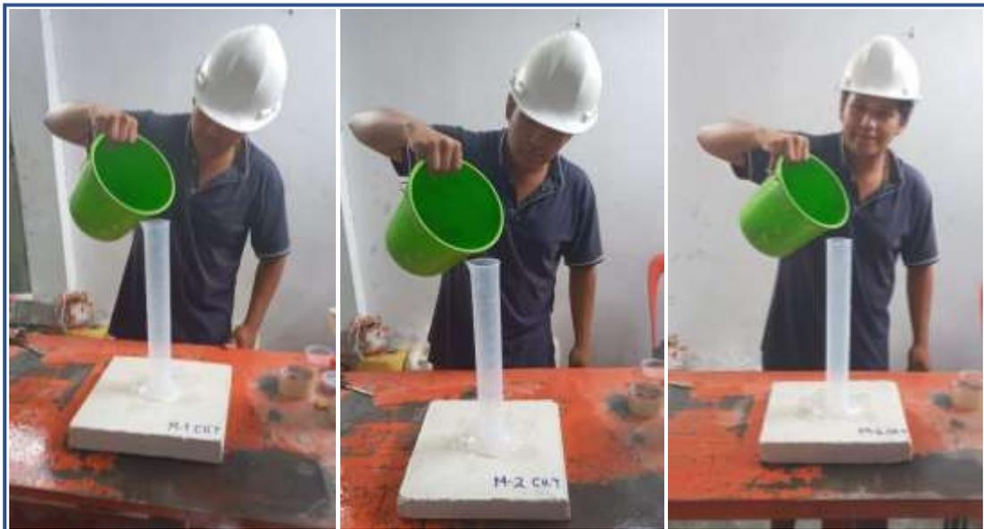
**Figura 6.** Losas Sikafill Techo-3 método Karsten.
