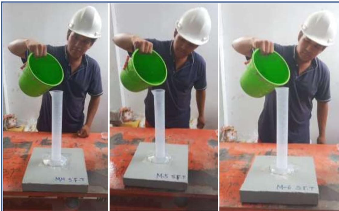
**Figura 7.** Losas con (Pc.Se.Ce. A) método Karsten.
