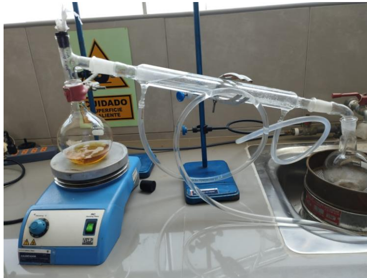
Figura 07. Destilación del aceite y el solvente.
