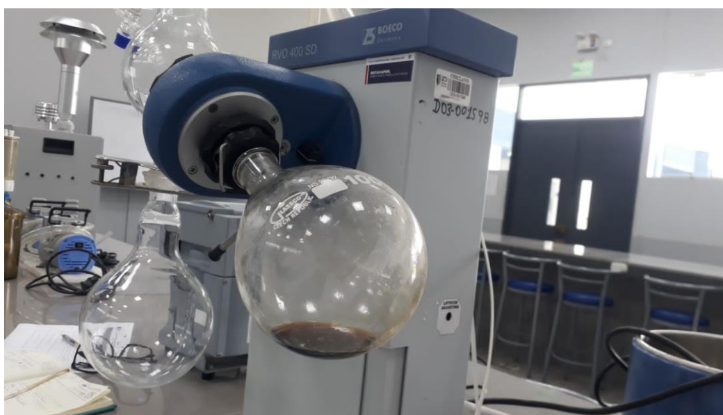
Destilación con el rotavapor para separar los residuos de hexano en el aceite
