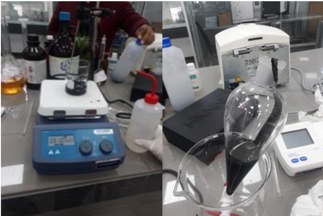
Esterificación y transesterificación para producir biodiésel
