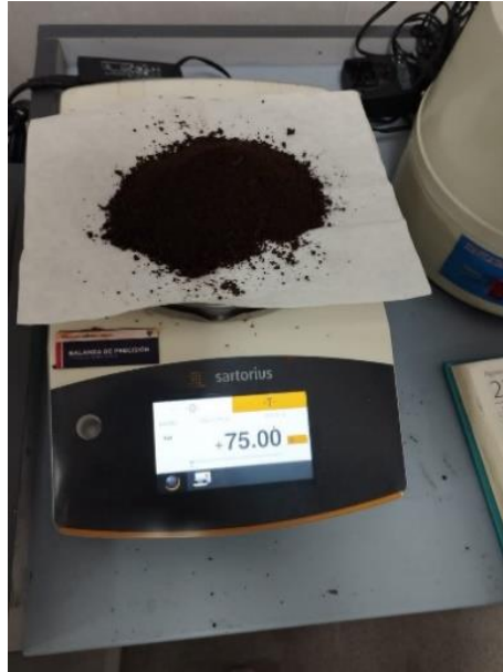
Figura 05. Peso del residuo de café seco para el proceso de extracción.
