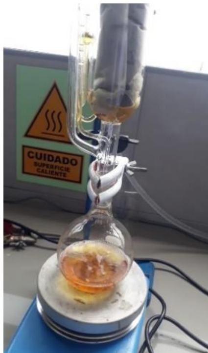
Figura 06. Extracción del aceite de residuo de café empleando el Soxhlet.
