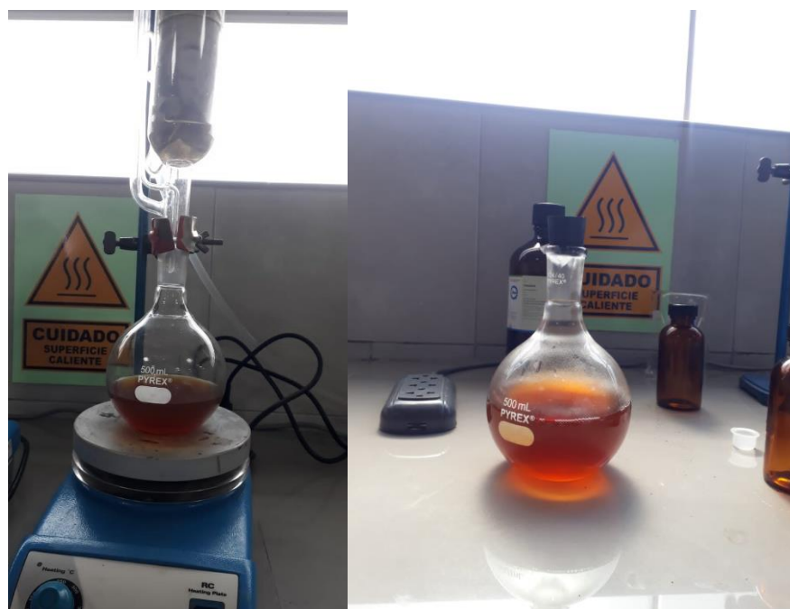
Solvente (hexano) y aceites mezclados después de la extracción
