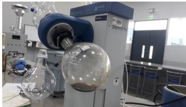
Figura 08. Destilación en el evaporador rotatorio.
